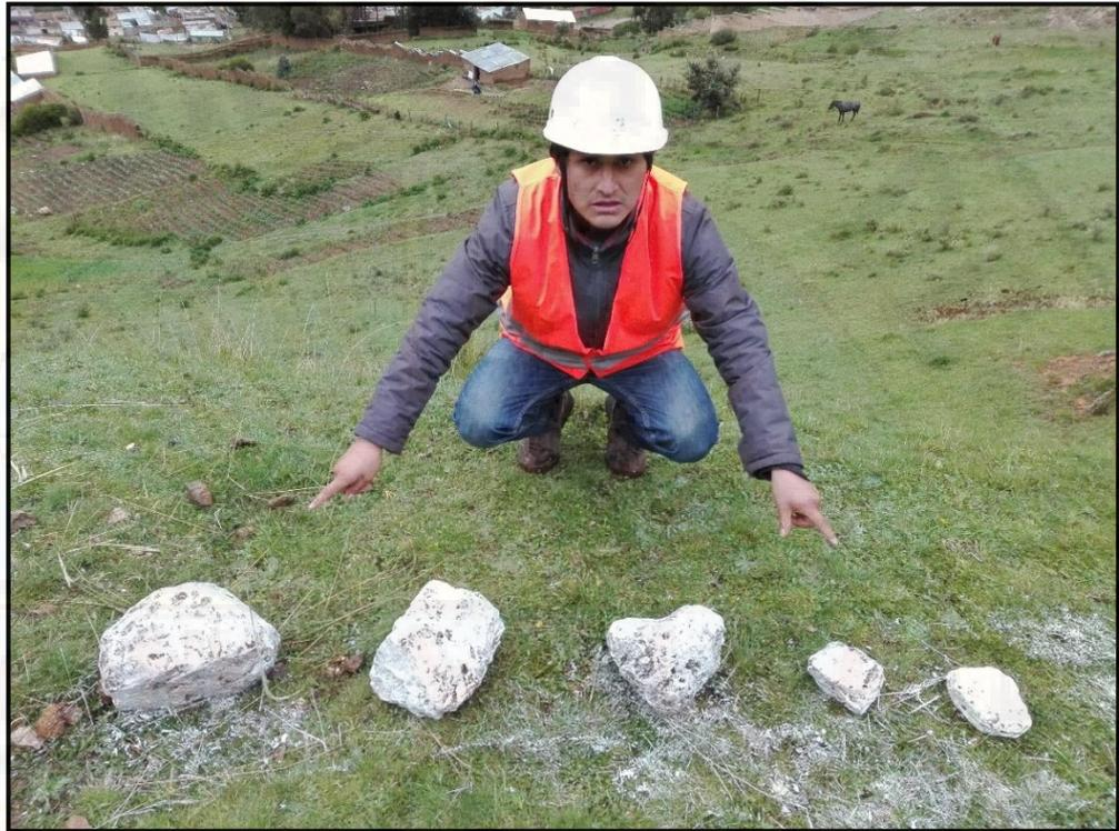
**Figura 55.** Rocas lanzadas, para el cálculo de los coeficientes restitutiones.
