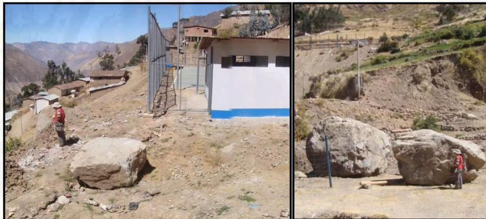
**Figura 1.** Bloques de roca de 2 a 3m de diámetro caídos dentro del estadio del poblado de Huamatambo (Luza & Sosa, 2016, págs. 14,15)
