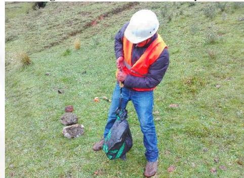
**Figura 60.** Pesado de las rocas a lanzar.
