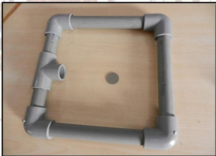
**Fotografía 9.** Montaje del flotador
