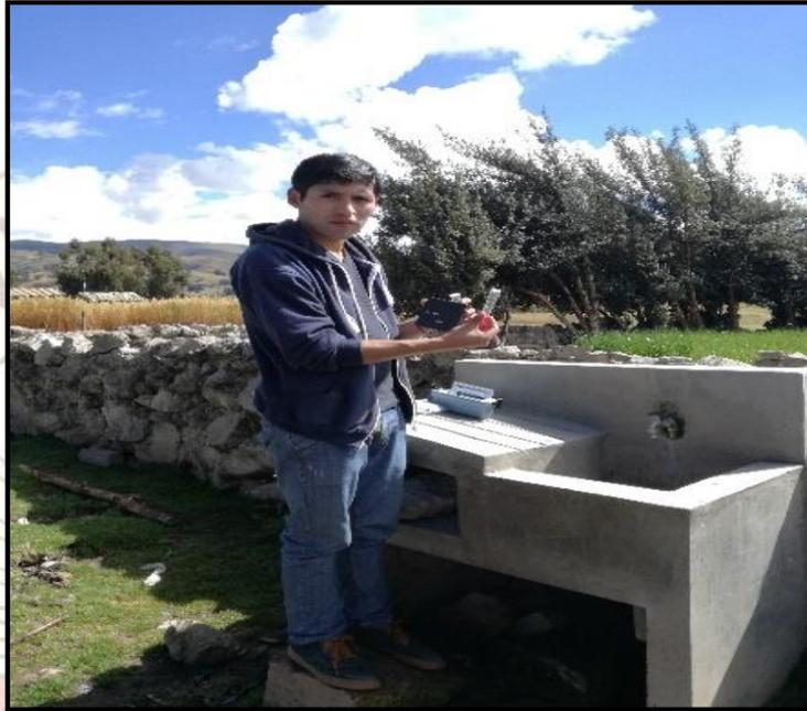
Fotografía 30. Medición del cloro residual.
