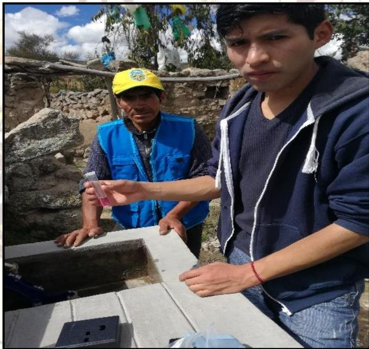
Fotografía 46. Medición del cloro residual en el final de la red
