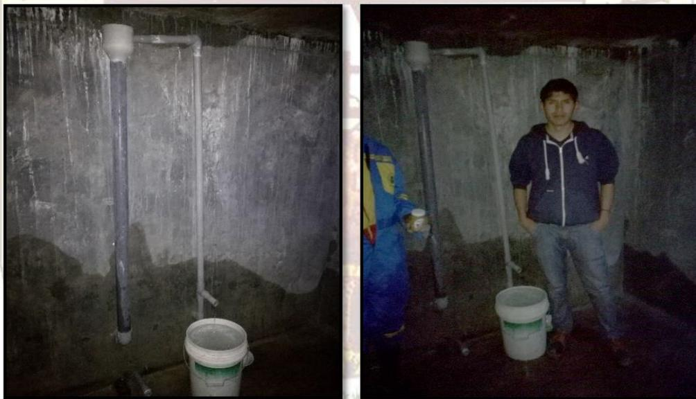
*Fotografía A 3. Instalación del nivel estático.*
