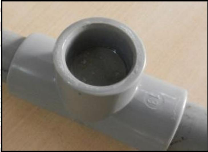
**Fotografía 10.** Tee del Flotador
