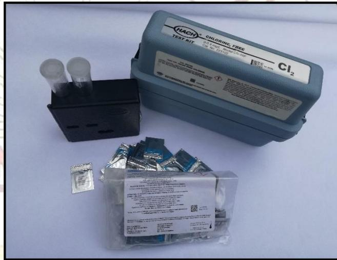
**Fotografía 27.** Comparador de cloro residual tipo disco.
