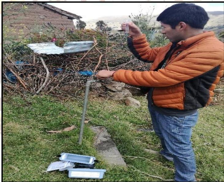
Fotografía 44. Medición del cloro residual en el inicio de la red.
