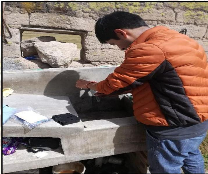
Fotografía 45. Medición del cloro residual la mitad de la red
