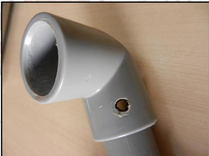
**Fotografía 11.** Accesorio perforado con un angulo de  $45^\circ$
