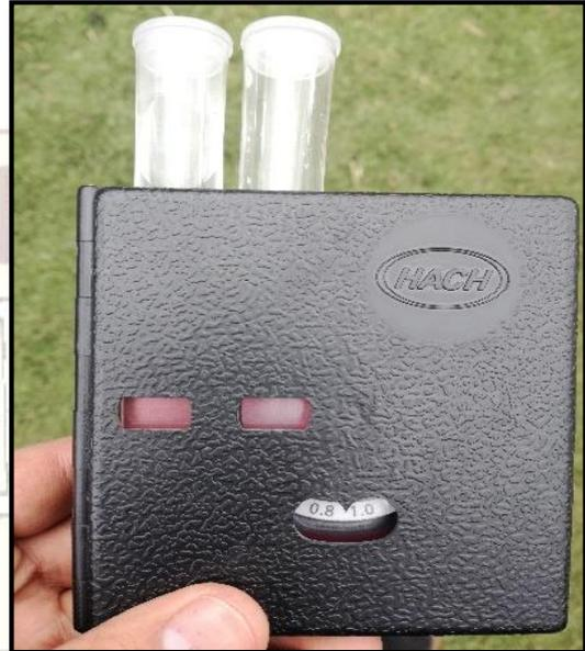
Fotografía A 7. Medición del cloro residual del sistema de cloración por goteo con flotador adaptado.
