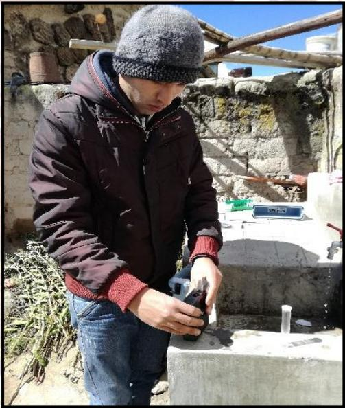
**Fotografía A 9.** Medición del cloro residual del sistema de cloración por goteo por embalse.
