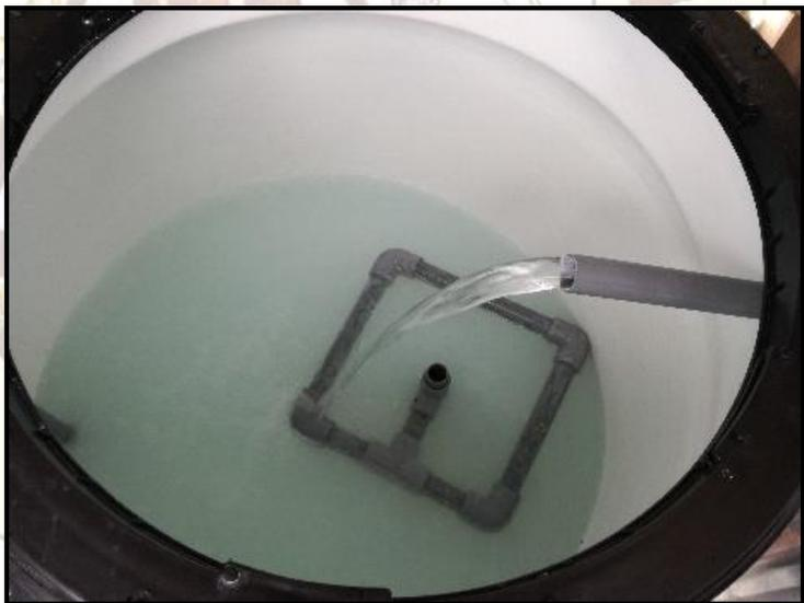
**Fotografía 23.** Llenado del tanque dosador
