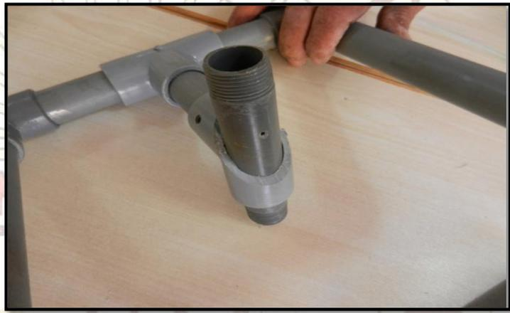
**Fotografía 12.** Colocado del niple con orificio
