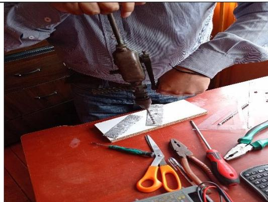
Perforacion para conexión entre electrodos.
