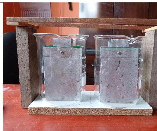
Diseño de soporte para los electrodos.
