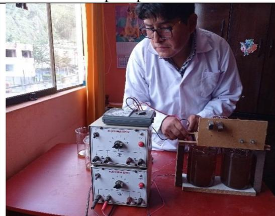
Controlando el voltaje de energia electrica en las placas con el multimetro.
