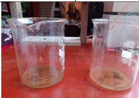
Lodos generados del proceso de electrocoagulación con electrodos móviles.
