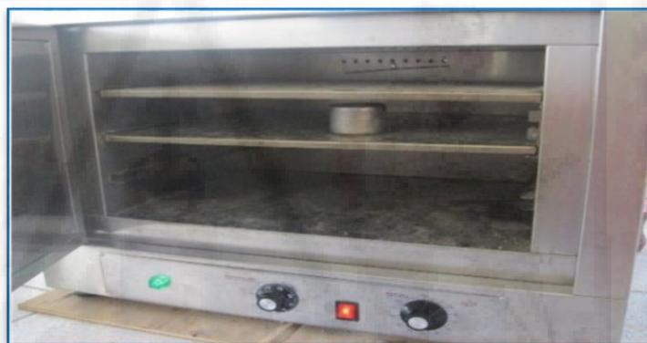
*Figura 25: Horno para el secado de Agregados
