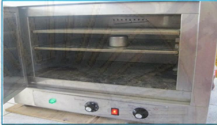
*Figura 28: Horno para secar agregado
