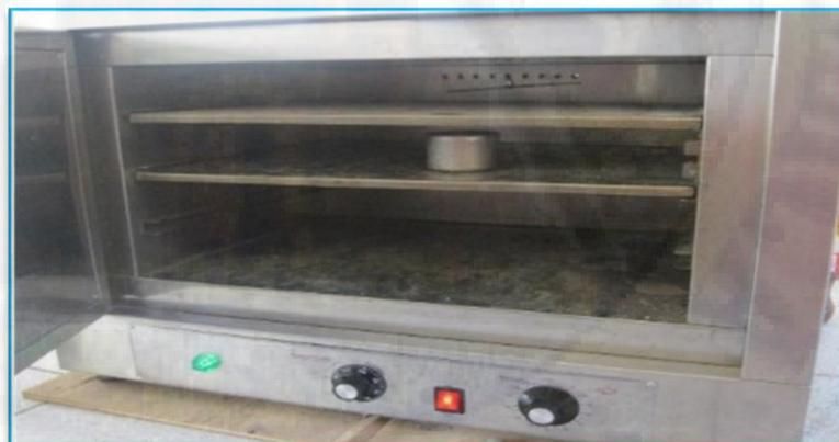
*Figura 31: Horno para el secado de los agregados
