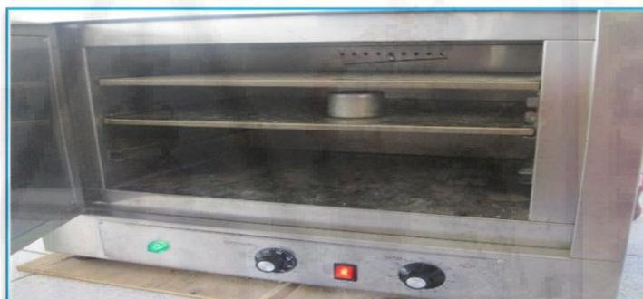
*Figura 23: Horno para el secado de los agregados
