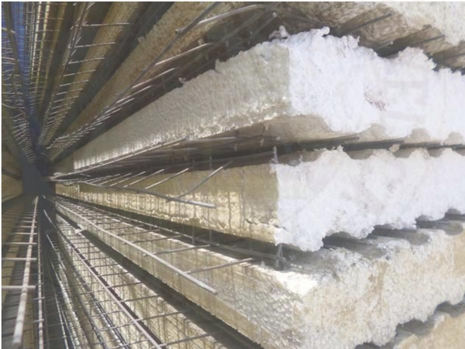
FOTO N° 06: panel terminado después de la máquina apaneladora lista para distribuir en las obras.
