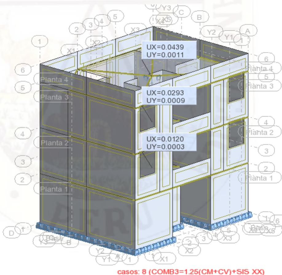
Figura 56: Desplazamientos medios de la estructura por efectos de la carga sísmica en la dirección "X-X" Comb = 1.25(CM+CV)+Sxx
