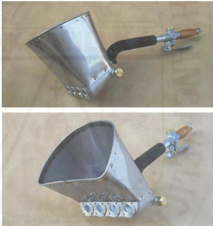
*Figura 16: Lanza-morteros para muros y techos.*
