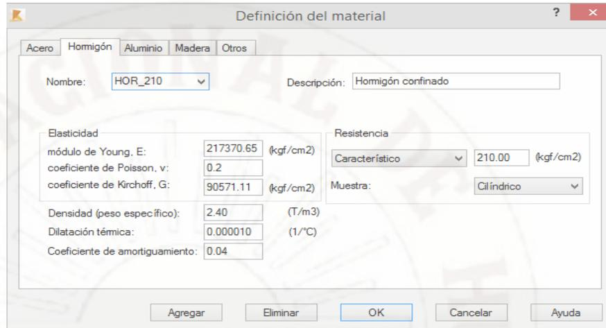
Figura 66: Propiedades de columna y vigas de concreto armado
