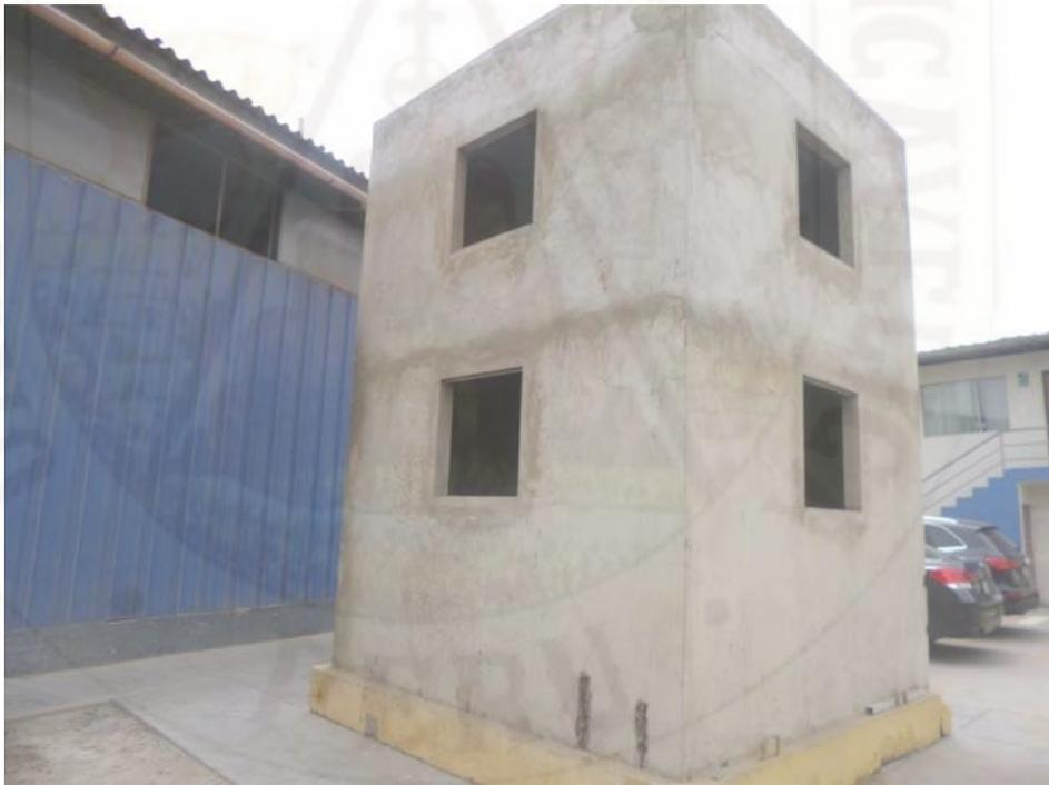
FOTO N° 02: módulo en escala real ubicado en el patio posterior, construido con fines de ensayos de análisis sísmico bajo la dirección de la Universidad Pontificia Católica del Perú.
