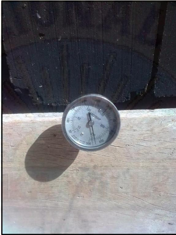
Medición de la temperatura a la que se expuso la viga
