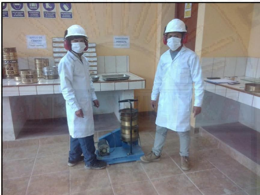
Tamizado de agregados (ASTM C 136)
