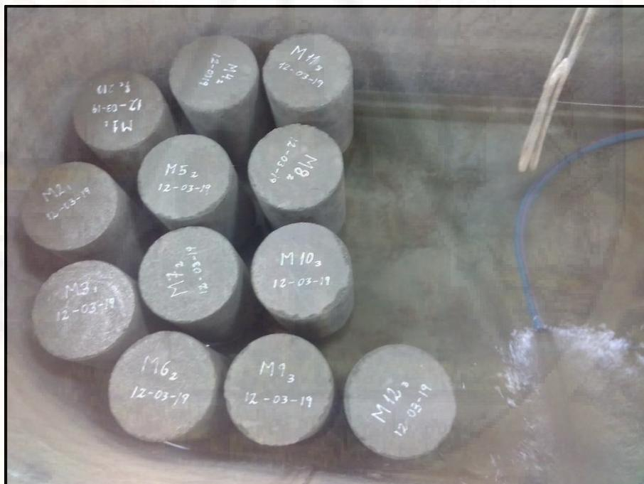
Curado de las muestras de concreto (ASTM C 31)
