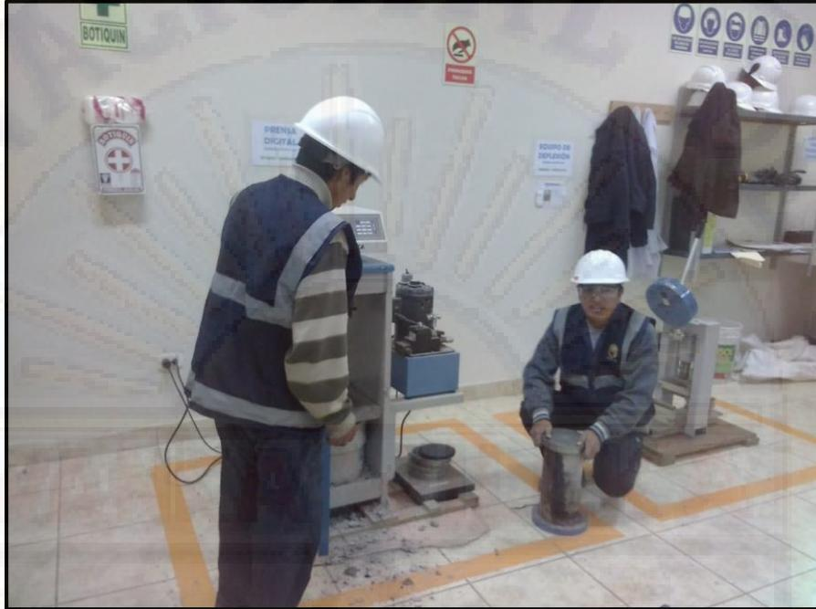
Muestra antes de ser metida a la máquina de compresión (ASTM C 39)
