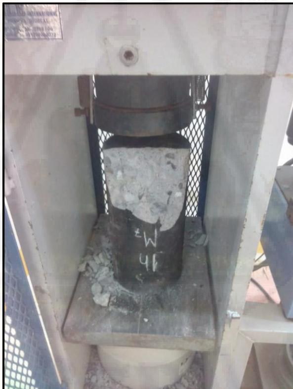
Muestra sometida a la máquina de compresión (ASTM C 39)
