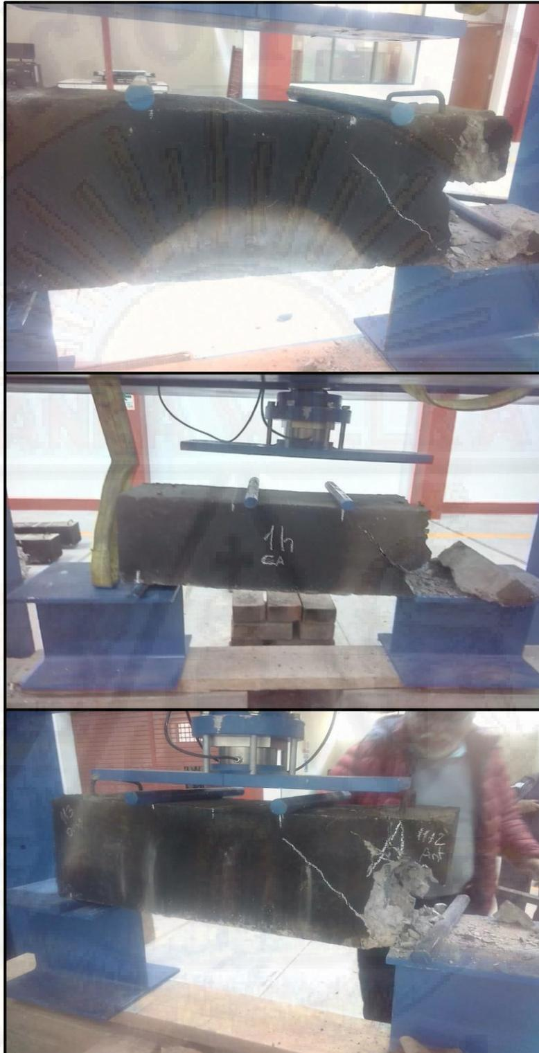
Fallas que se presentaron debido a la aplicación de la carga, en la muestra sometida a fuego (ASTM C 78)
