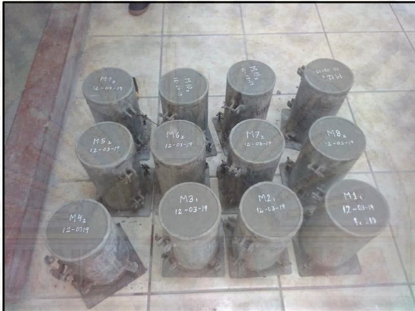
Moldes vaciados de concreto (ASTM C 31)
