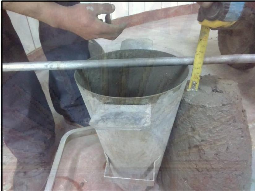
Cálculo del asentamiento o slump (ASTM C 143)
