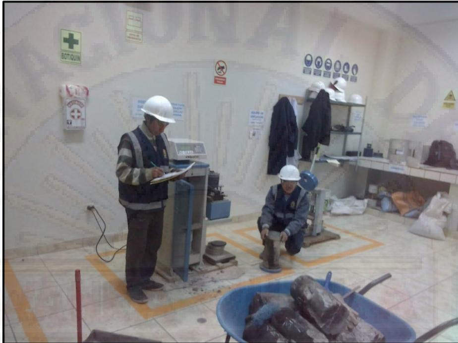
Ensayo de todas las muestras sometidos a compresión (ASTM C 39)
