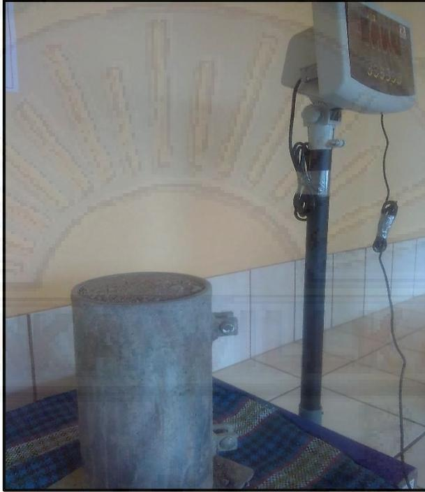
Peso unitario de agregados (ASTM C 29)
