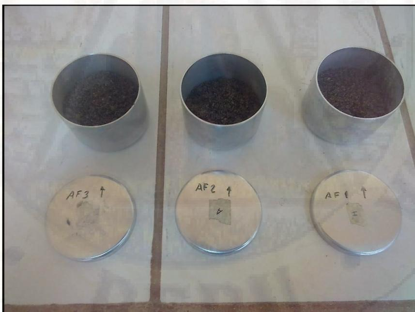
Muestras para contenido de humedad (ASTM C566)
