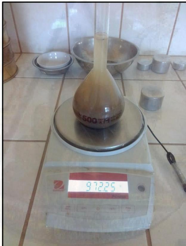
Peso específico del agregado fino (ASTM C 127)
