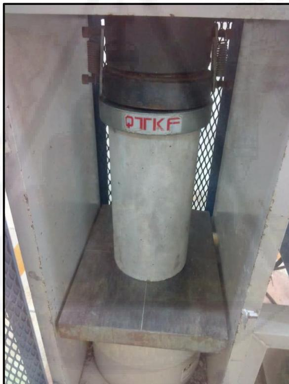
Muestras patrón sometidas a la máquina de compresión (ASTM C 39)
