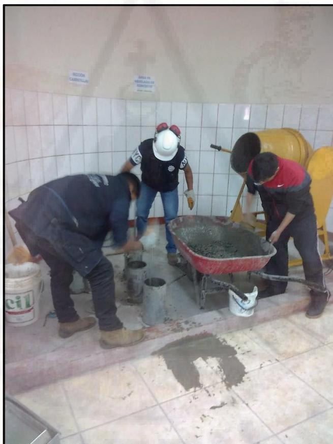
Llenado del concreto a los moldes (ASTM C 31)
