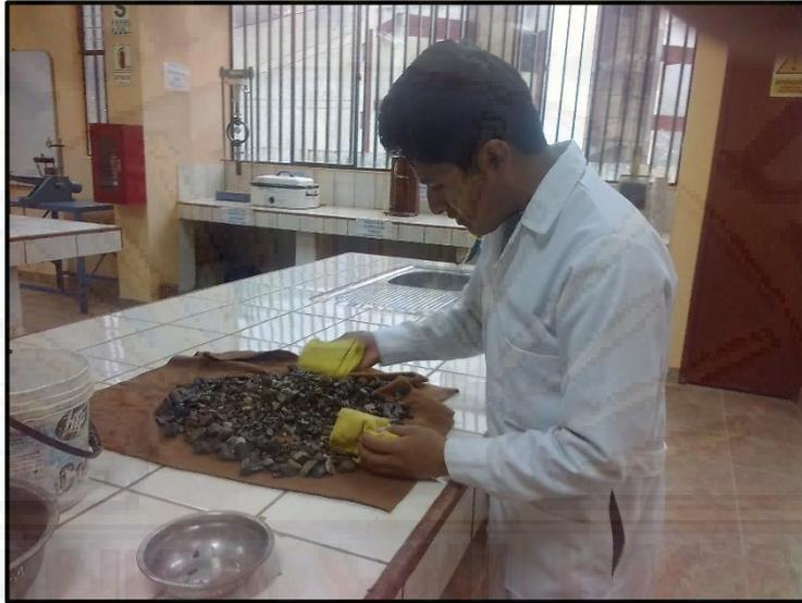
Peso específico de agregado grueso (ASTM C127)
