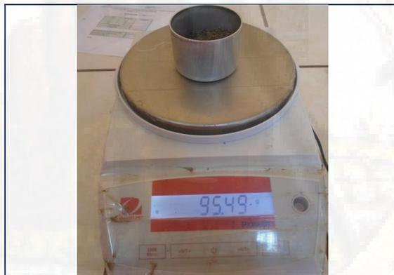
**Figura N° 36. Pesado del agregado en un recipiente**
