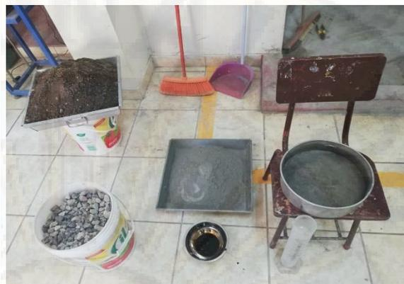
**Figura N° 42. Materiales (arena gruesa, piedra chancada, cemento, aditivo plastificante y agua)**
