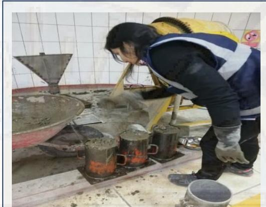
**Figura N° 49. Muestreo de probetas con (CAC)**
