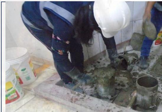
**Figura N° 43. Colocado de las muestras de concreto en las bridgetas**
