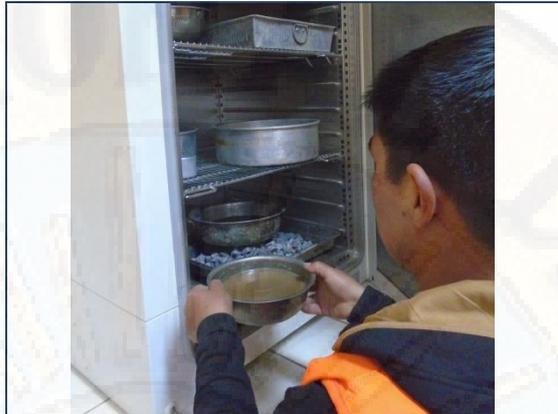
**Figura N° 34. Colocado de la muestra del agregado fino al horno**
