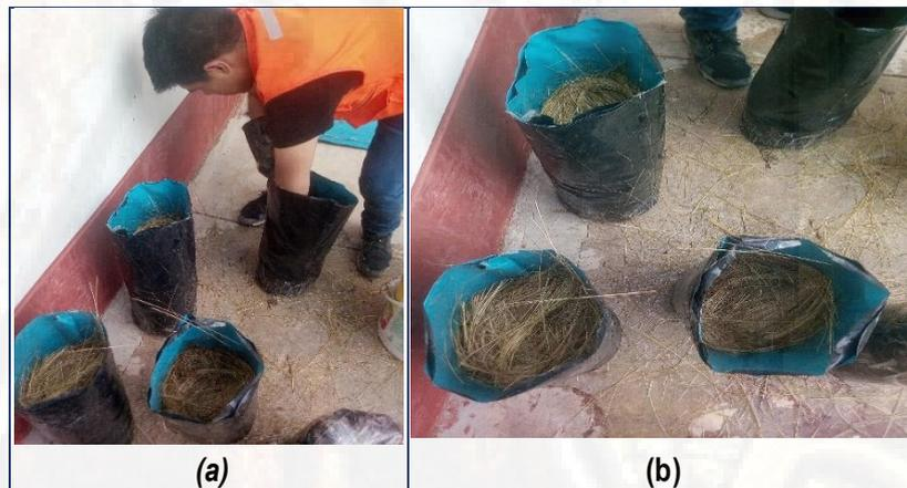
**Figura N° 59. (a) Colocación de ichu stipa en los laterales**
