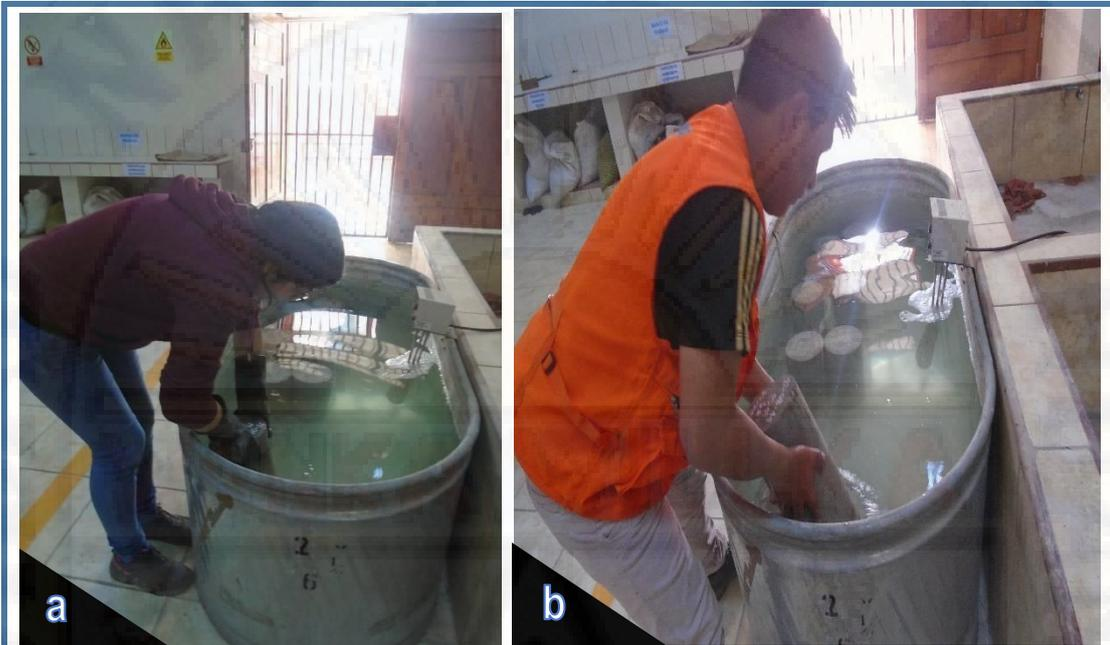
**IMAGEN 04:** (a), (b) y (c) Curado de probetas de concreto autocompactante  $f'c=210$  kg/cm<sup>2</sup> (en laboratorio)
