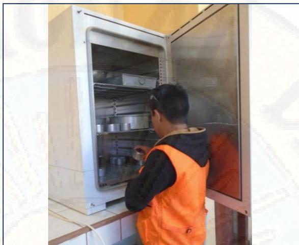
**Figura N° 37. Colocado de las muestras del agregado en el horno**
