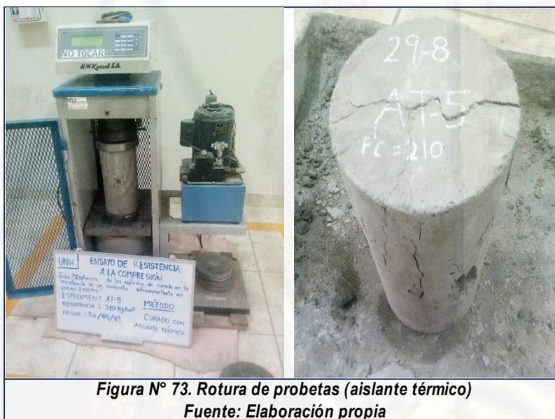
Figura N° 73. Rotura de probetas (aislante térmico)
