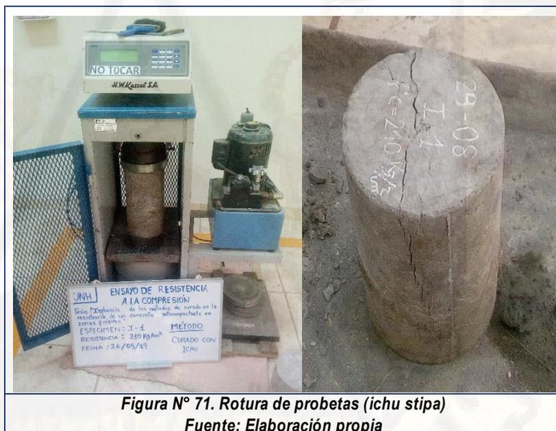
**Figura N° 71. Rotura de probetas (ichu stipa)**
