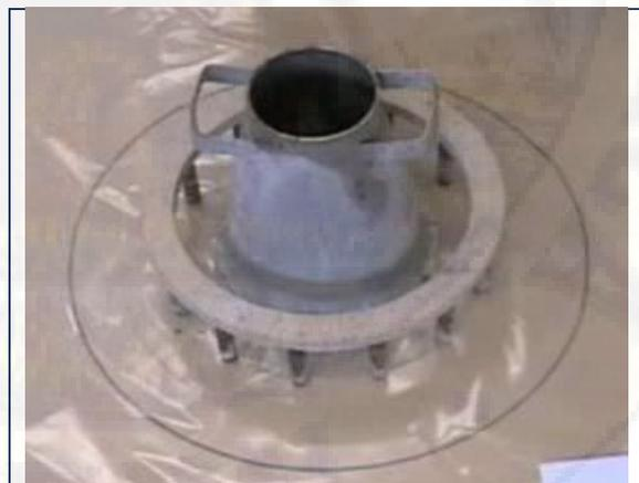
**Figura N° 2. Ensayo de escurrimiento con anillo J**
