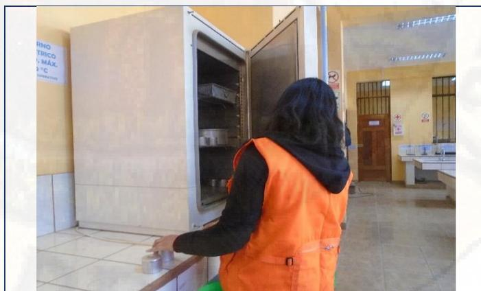
**Figura N° 31. Muestra del agregado grueso colocando al horno**
