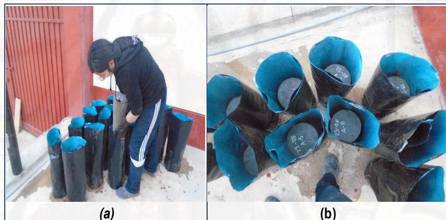
**Figura N° 55. (a) Base de aserrín (b) Colocación de la probeta parcialmente húmeda**
