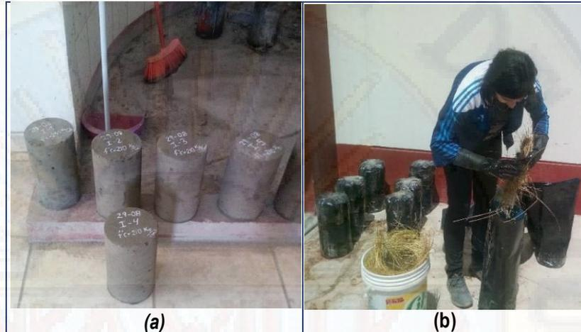
**Figura N° 58. (a) Desencofrado probetas (b) Colocación de una capa de ichu stipa en la base**
