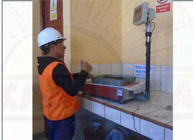
**Figura N° 32. Pesado del agregado fino para ser saturado**
