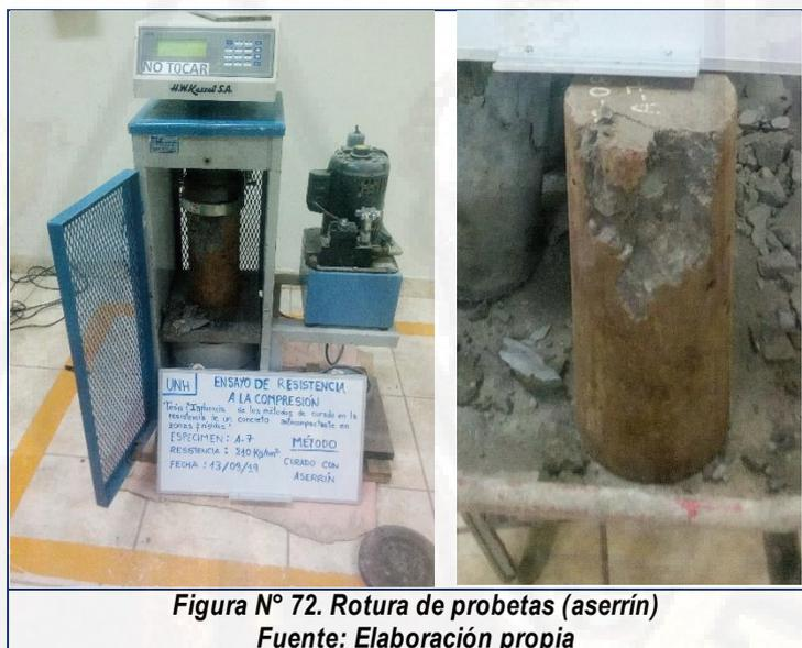
**Figura N° 72. Rotura de probetas (aserrín)**
