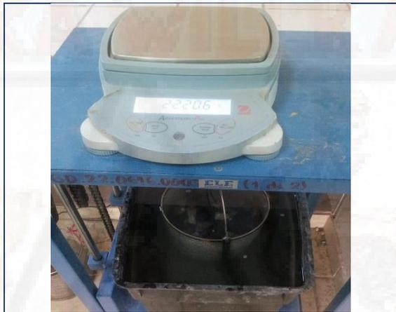
**Figura N° 30. Muestra del agregado grueso sumergido en la canastilla**
