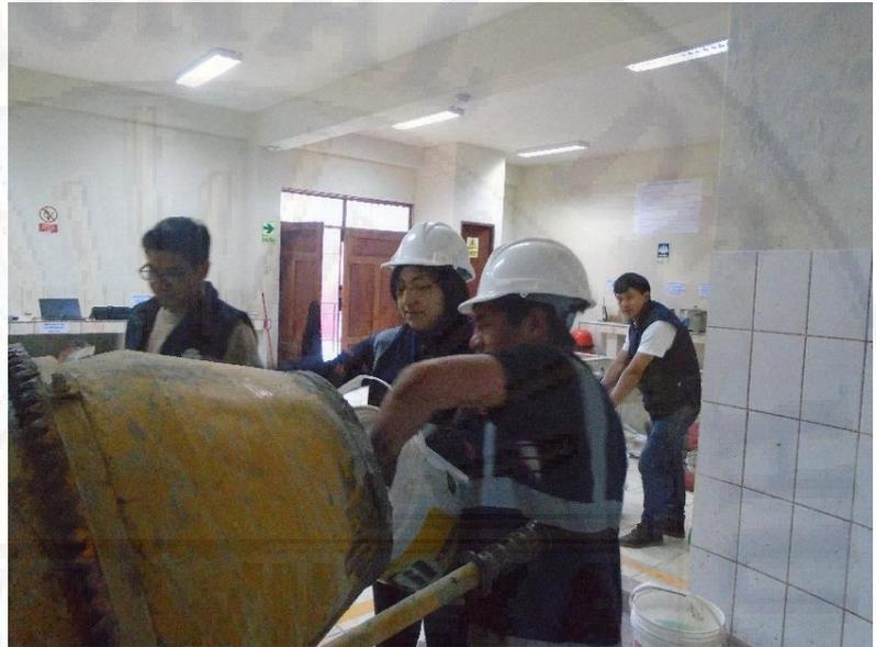
**Figura N° 38. Mezclado de Concreto en el laboratorio de la UNH**
