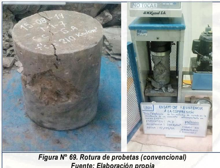
**Figura N° 69. Rotura de probetas (convencional)**
