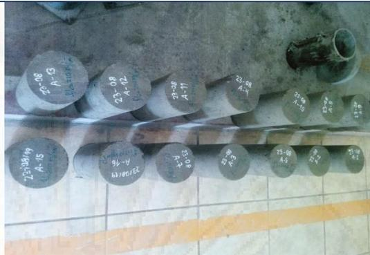
**Figura N° 54. Desencofrado de probetas**
