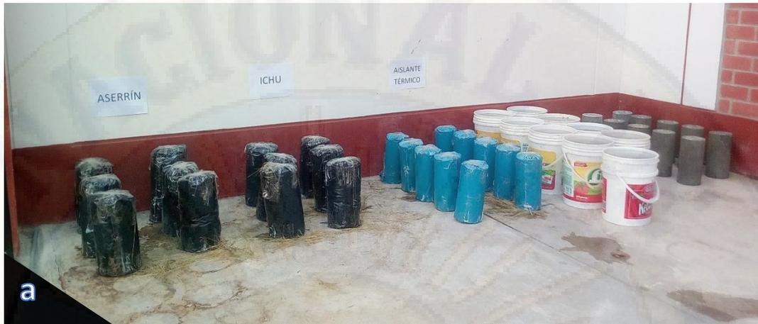
**IMAGEN 03:** (a),(b),(c) y (d) Curado de probetas de concreto autocompactante  $f'c = 210 \text{ kg/cm}^2$  (ichu stipa, aserrín, aislante térmico, aspersion, inmersión)
