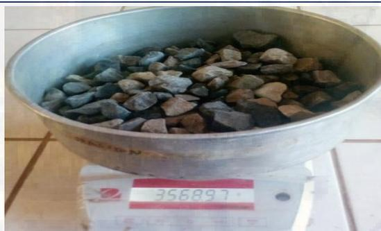
**Figura N° 28. Muestra del agregado grueso saturada por 24 horas**
