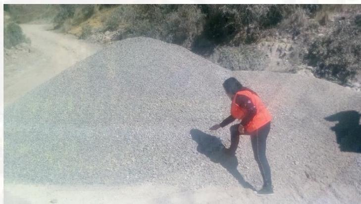
**Figura N° 13. Muestreo de agregado grueso (piedra chancada)**
