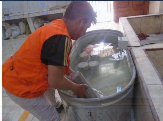
**Figura N° 51. Curado en laboratorio**
