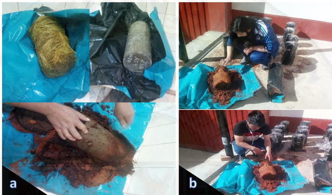
**IMAGEN 05:** (a) (b) Habilitado de testigos de concretos curados con ichu stipa, aislante térmico y aserrín (c) Ensayo de compresión de testigos de concreto en laboratorio (prensa digital)
