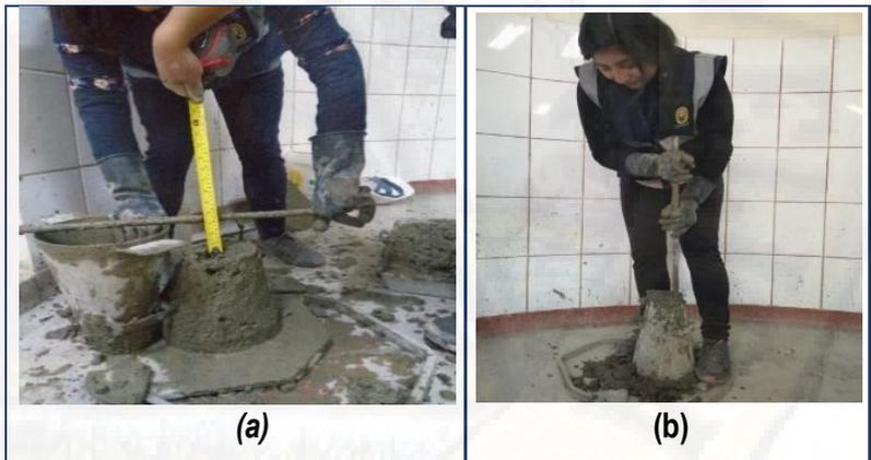
**Figura N° 39. (a) Ensayo de asentamiento del concreto (b) slump (3" a 4")**
