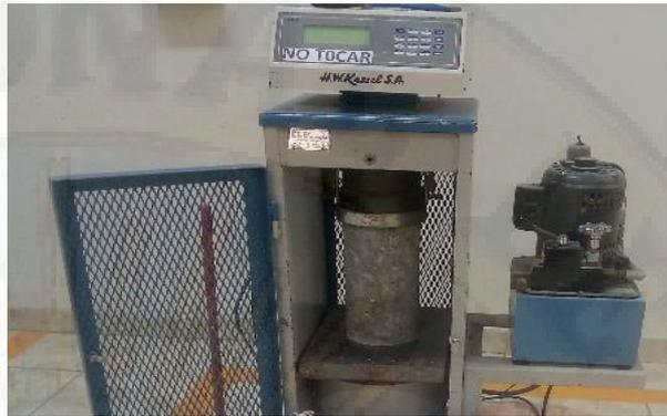
**Figura N° 66. Ensayo de resistencia a la compresión**
