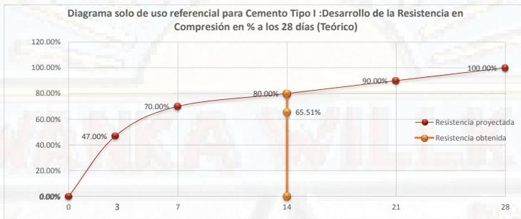
**CURADO POR INMERSIÓN- CONCRETO AUTOCOMPACTANTE F'c = 210 Kg/cm2**
