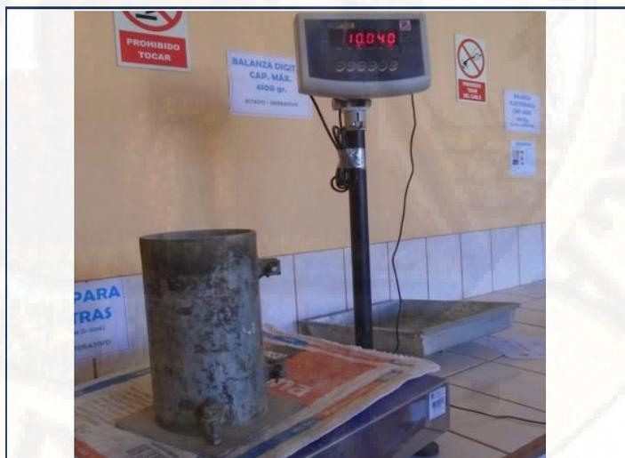
**Figura N° 23. Molde de briqueta de 15 cm x 30 cm para determinar los pesos unitarios de los agregados.
