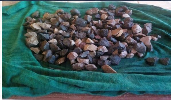
**Figura N° 29. Muestra del agregado grueso superficialmente seco manualmente**
