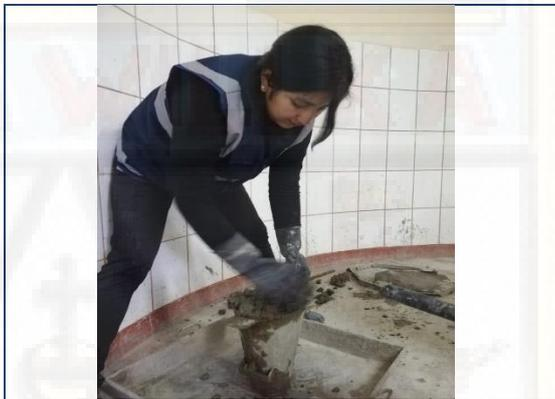
*Figura N° 45. Mezcla al ras de la superficie
