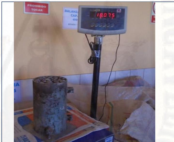
**Figura N° 25. Peso compactado del agregado grueso con la briqueta**
