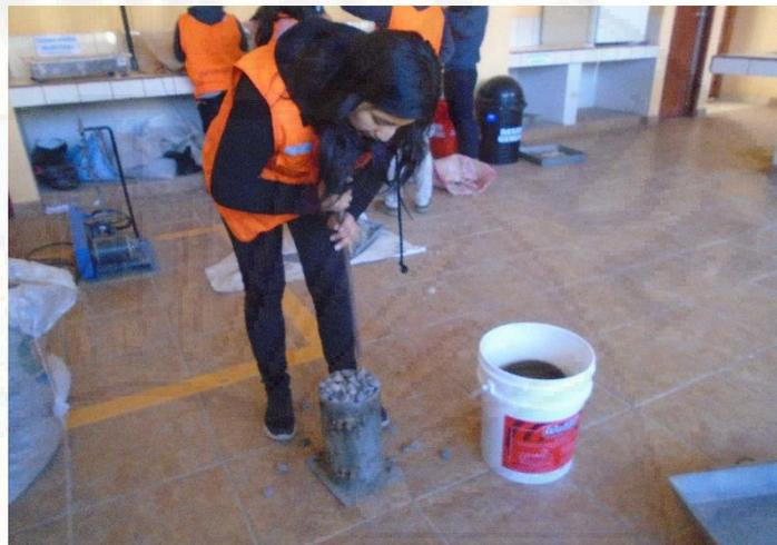
**Figura N° 24 Colocado del agregado grueso en el molde de briqueta**
