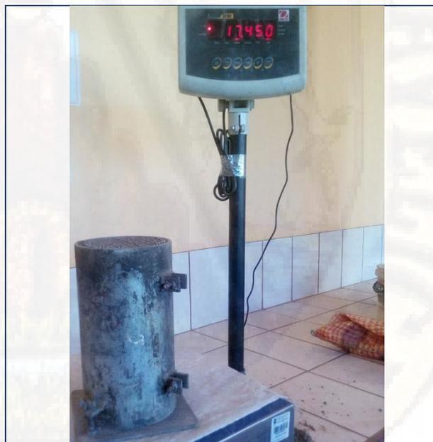
**Figura N° 27. Peso suelto del agregado grueso con la briqueta**
