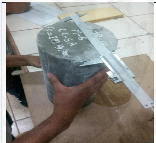
Figura N° 65. Medición del diámetro de la probeta con la regla de cálculo Vernier
