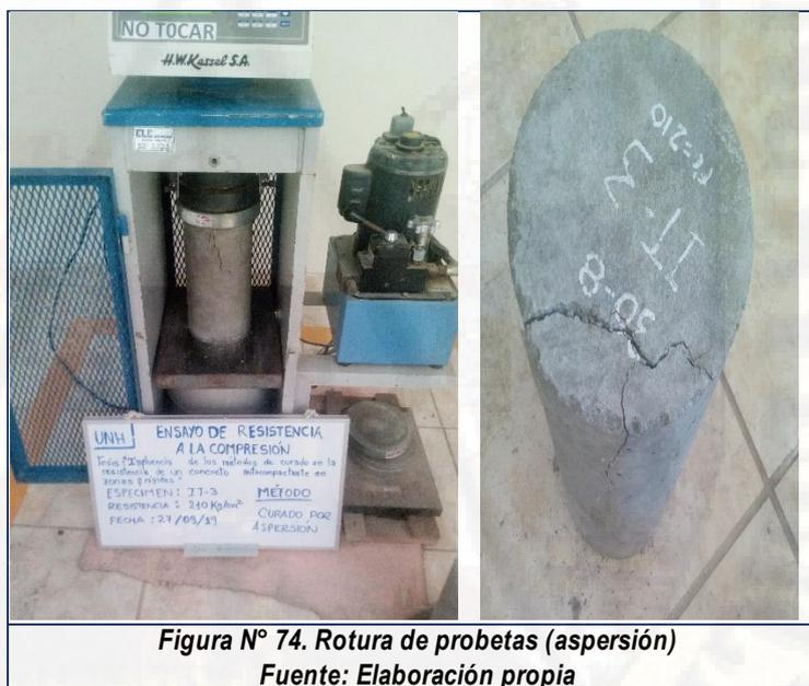
**Figura N° 74. Rotura de probetas (aspersión)**
