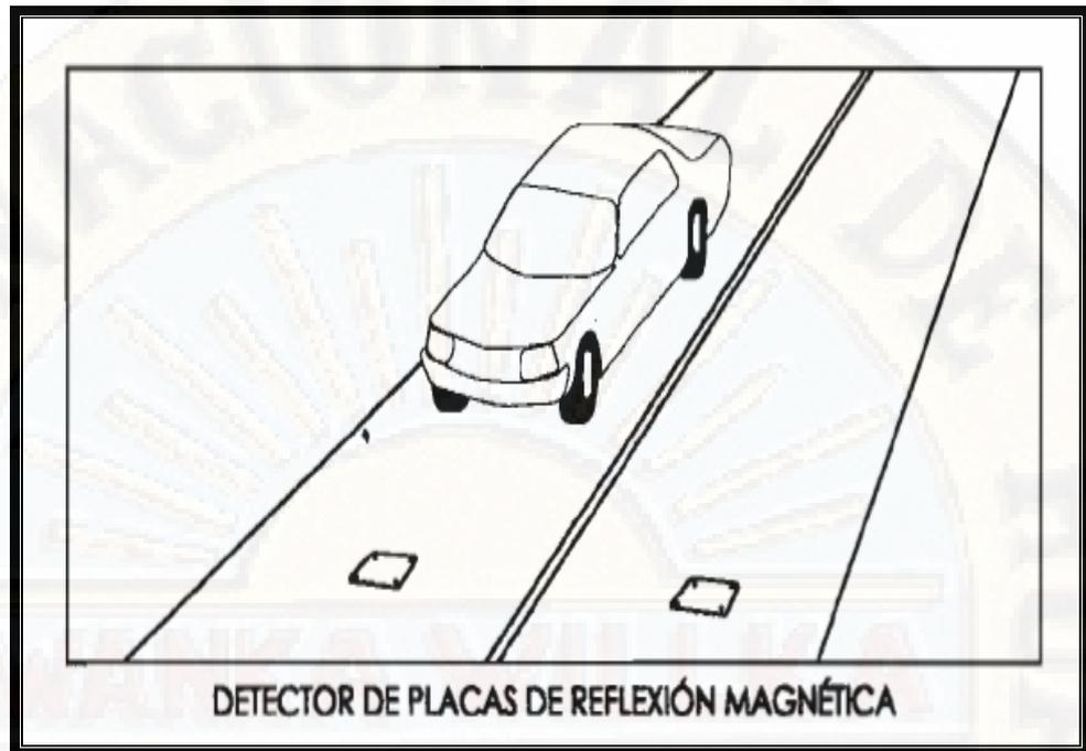
Figura 13: Detector de Placas de Reflexión Magnética
