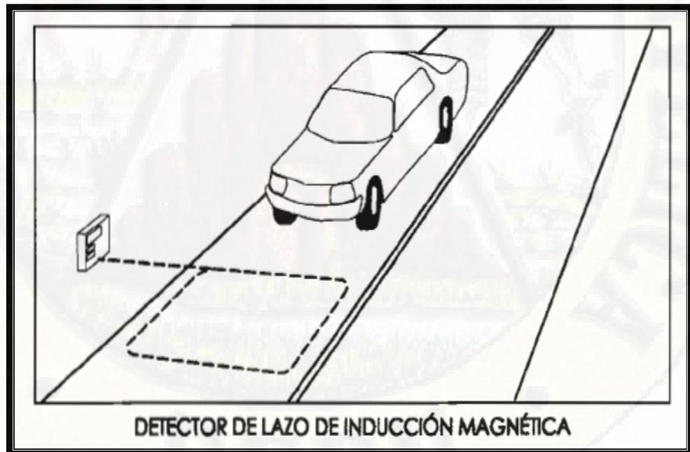
Figura 14: Detector de Lazo de Inducción Magnética
