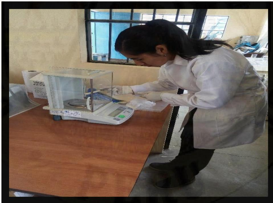
MEDICIÓN DE LA CANTIDAD DE LA *Moringa oleifera* EN UNA BALANZA ANALÍTICA
