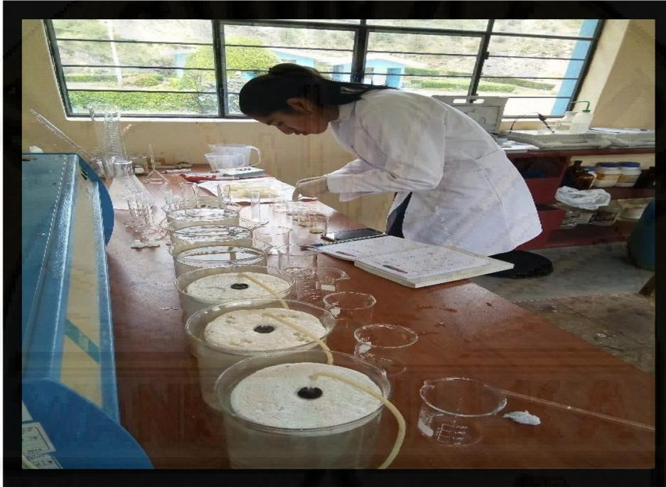
RETIRO DE MUESTRAS PARA ANALIZAR LA TURBIEDAD, TEMPERATURA Y pH
