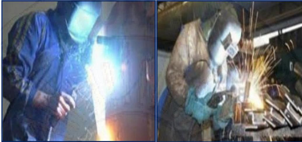
**Figura N° 1.** Soldador lado izquierdo no utiliza guantes, soldador lado derecho si utiliza guantes
