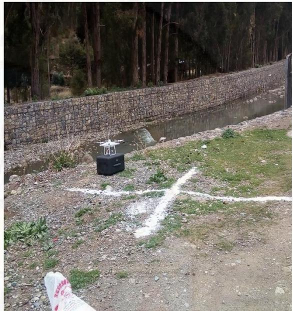
**IMAGEN N° 11.** Marcado del punto de control N° 04 para el levantamiento topográfico
