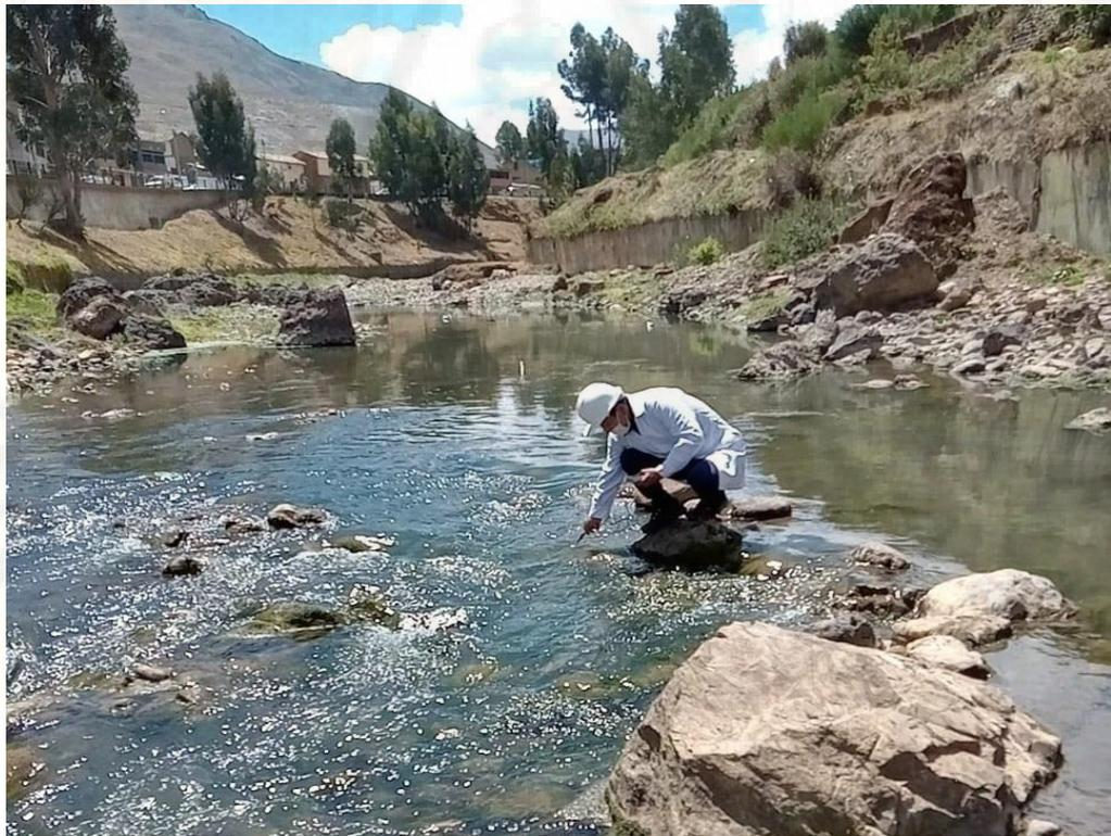
**Figura 30:** Medición de parámetros pH y temperatura de río Ichu en PM-4.
