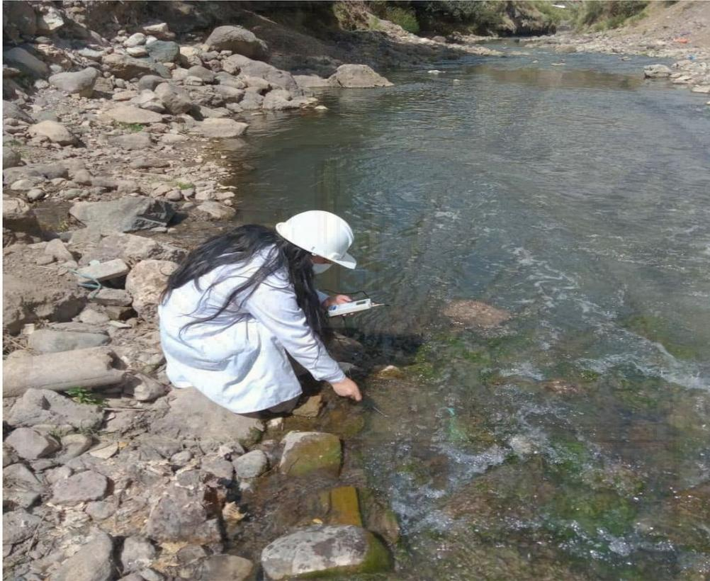
**Figura 33:** *Medición de parámetros pH y temperatura de río Ichu en PM-5.*
