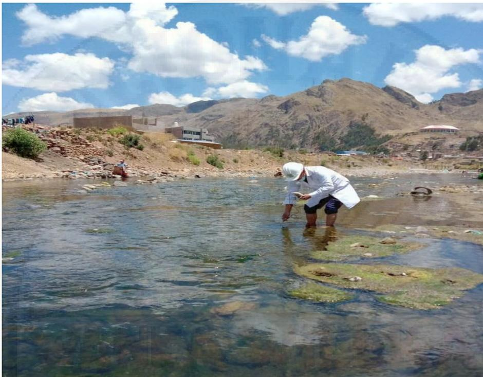
**Figura 27:** *Medición de parámetros pH y temperatura de río Ichu en PM-3.*
