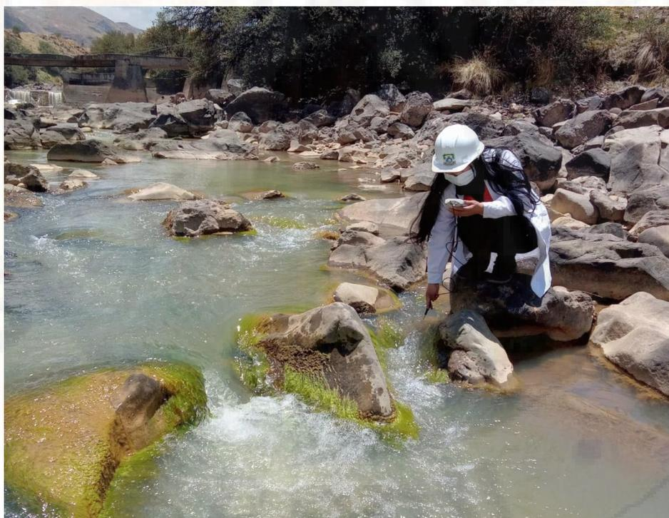
**Figura 24:** Medición de pH y temperatura de río Ichu en PM-2.
