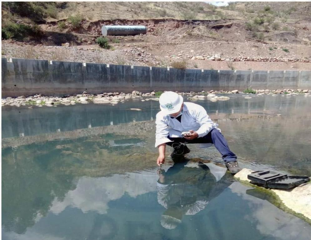
**Figura 36:** Medición de parámetros pH y temperatura de río Ichu en PM-6.
