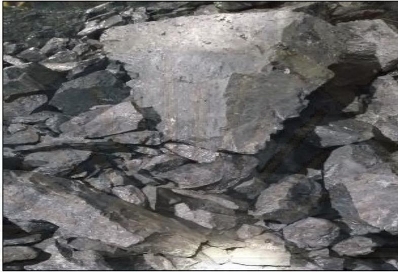
Verificación de tamaño de carga después de la voladura.
