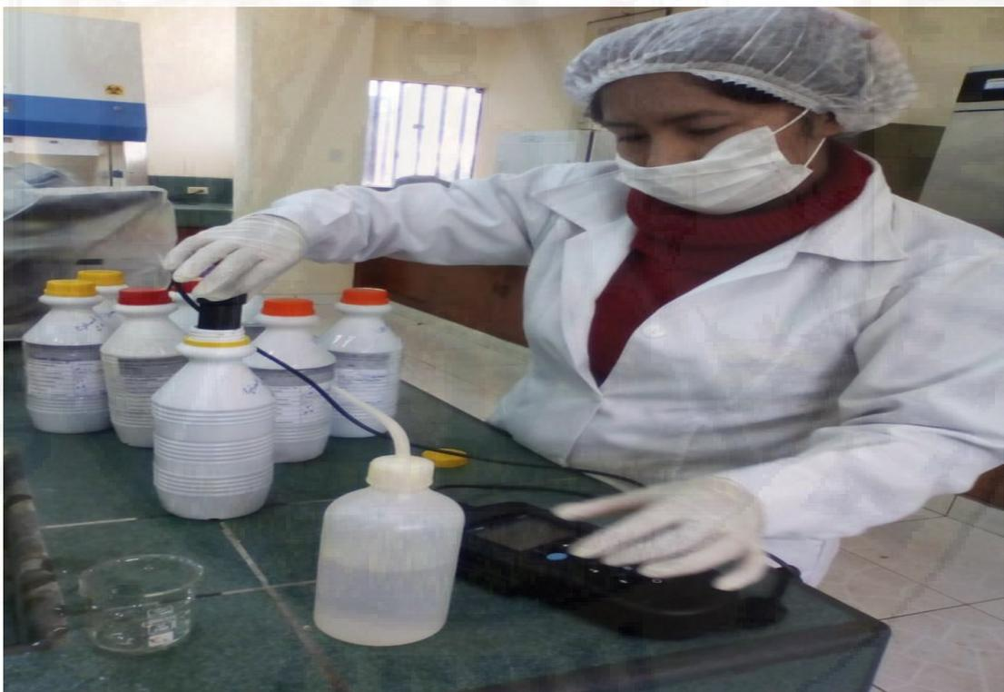
**Fotografía 29.** Parámetros tomados en laboratorio Temperatura y pH, con un Potenciómetro.
