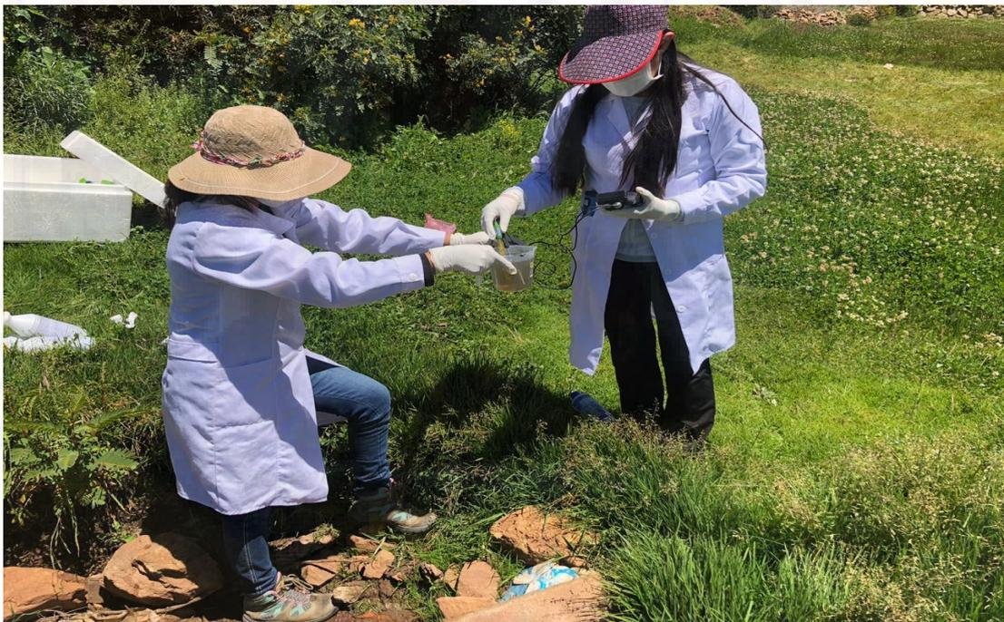
**Fotografía 27.** Parámetros tomados en campo Temperatura y pH, con un pH metro digital HI 8424.
