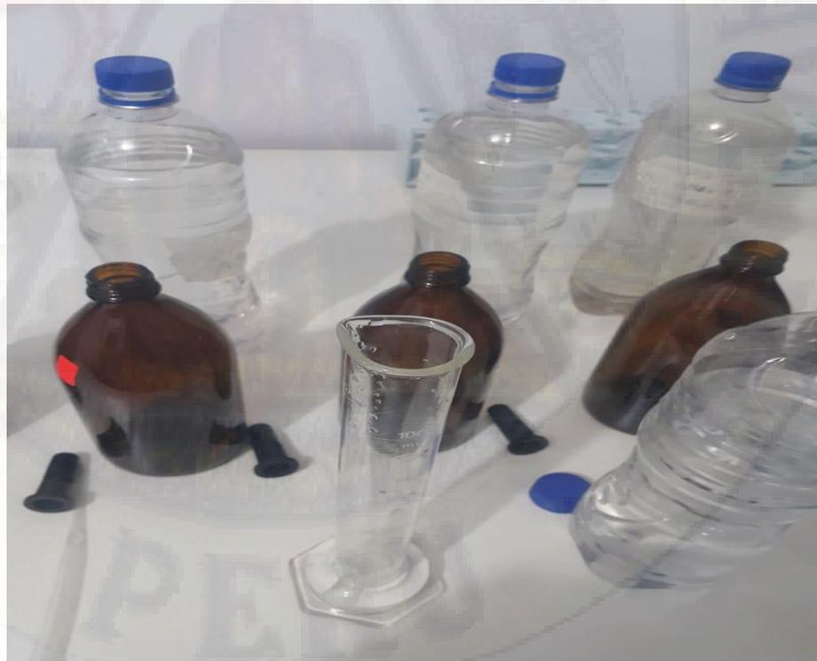
**Fotografía 10.** Botellas de DBO<sub>5</sub> y agua destilada estéril.
