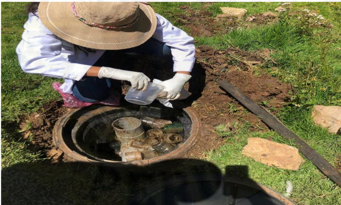
**Fotografía 25.** Punto de monitoreo del afluente tubo de ingreso al biodigestor.
