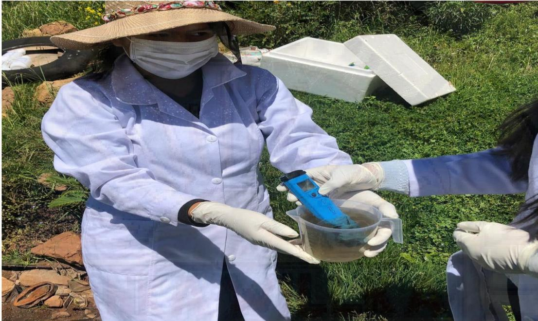
**Fotografía 28.** Parámetros tomados en campo Temperatura y pH, con un Multiparámetro marca Hanna.
