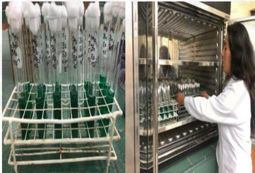
**Fotografía 19.** Incubación de las diluciones seriadas a 44.5 °C.
