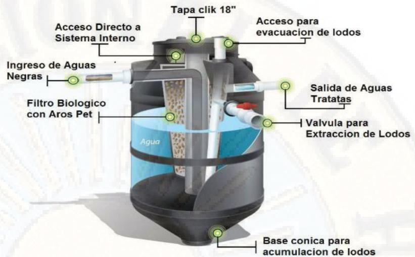
**Figura 18.** Nivel de agua y partes del biodigestor.
