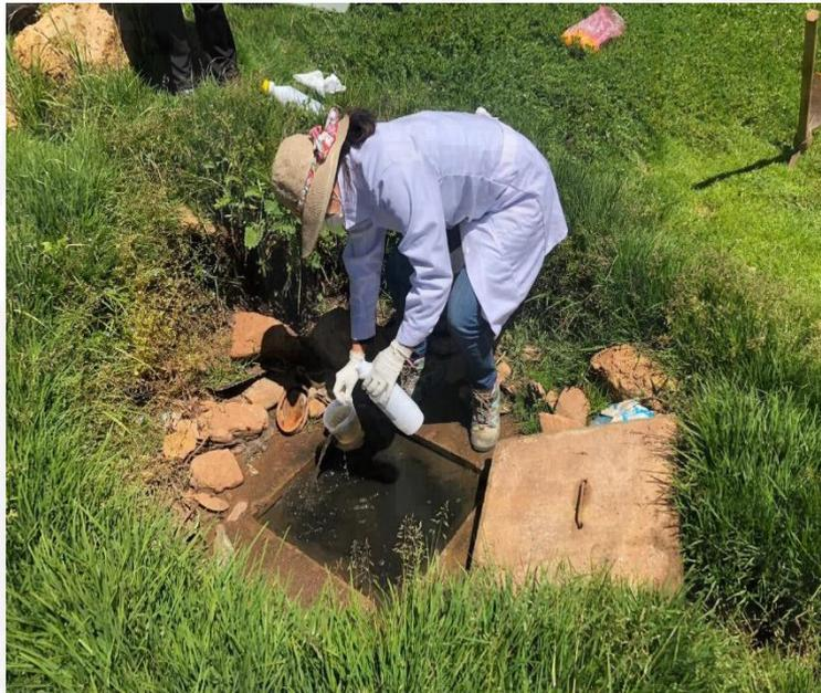
**Fotografía 3.** Punto de monitoreo del efluente (E), tomados del pozo de percolación.
