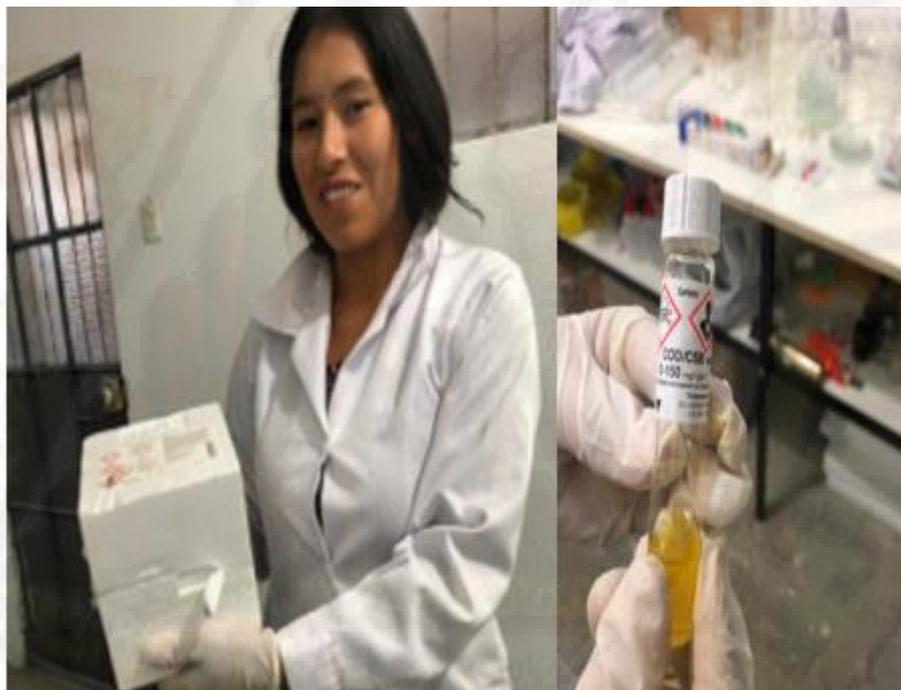
**Fotografía 7.** Viales para DQO de rango bajo marca Hach.
