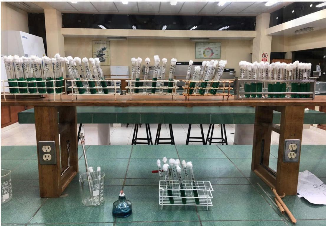
**Fotografía 31.** Tubos preparados para incubar, determinación de los coliformes termotolerantes.
