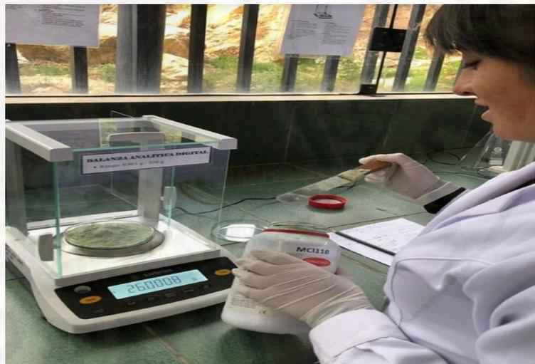
**Fotografía 14.** Pesaje de caldo bilis verde brillante en la balanza analítica digital.
