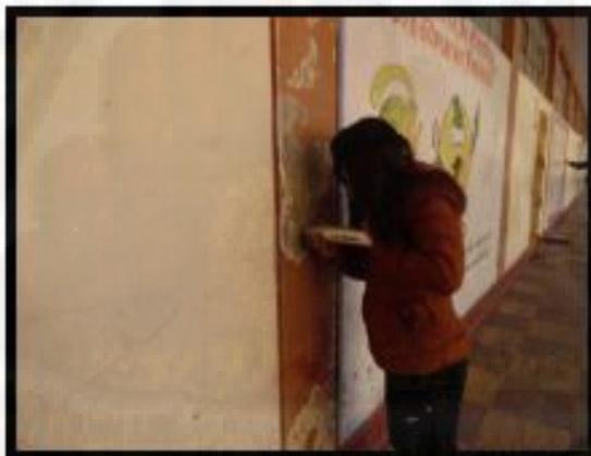
Imagen N°18: Recolección de datos con Esclerómetro
