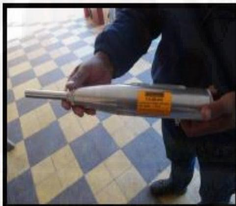
Imagen N°15: Vista del Esclerómetro
