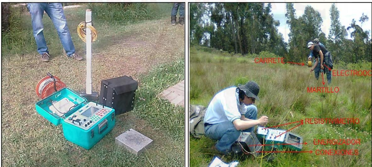
Fotografía 13. Equipo Geoeléctrico.
