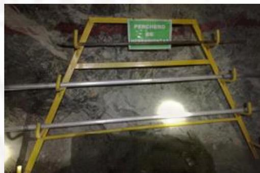
**IMAGEN Nª 24 : Barretillas para el desatado de rocas.**
