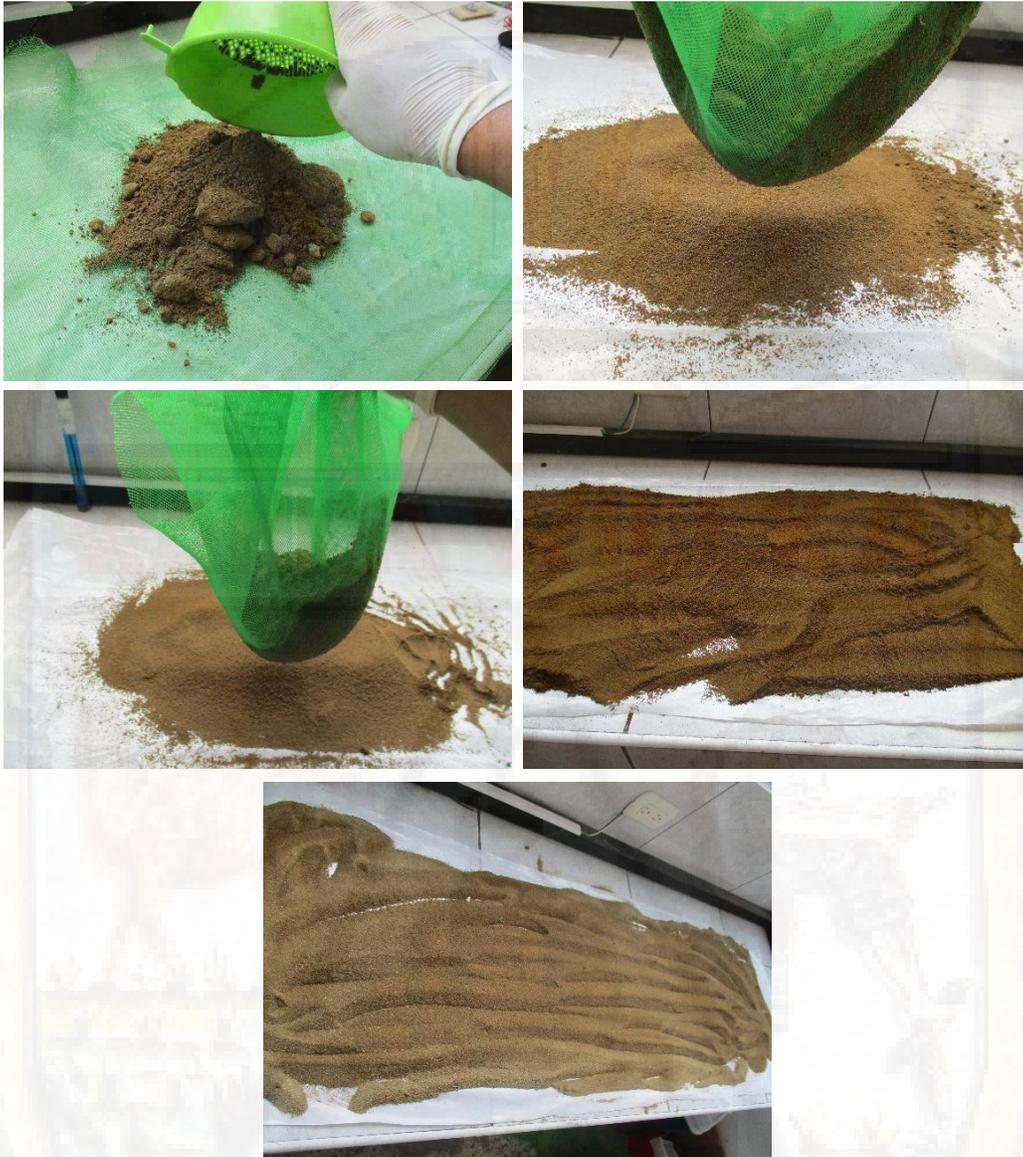
**Figura N° 11.** Homogenización y secado del relave de mina.
