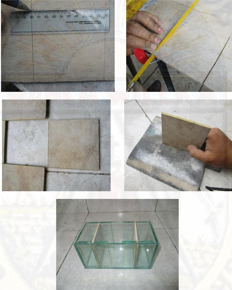
Figura N° 9. Medición, corte y montaje de placas de madera dentro de la celda.
