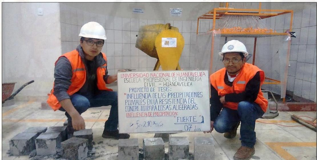
Foto 29: Probetas sometidas a compresión a la edad de 7 días con influencia de precipitación de una intensidad fuerte.
