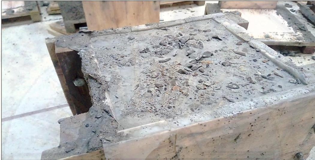
*Foto 22: Probeta con estragos visibles después de ser influenciada con una intensidad fuerte de precipitación artificial.*
