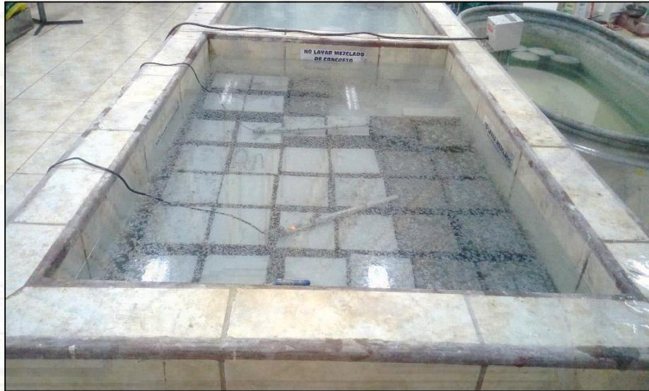
*Figura 35: Curado de las probetas después de su desmolde a una temperatura promedio de entre 23° - 25°.*
