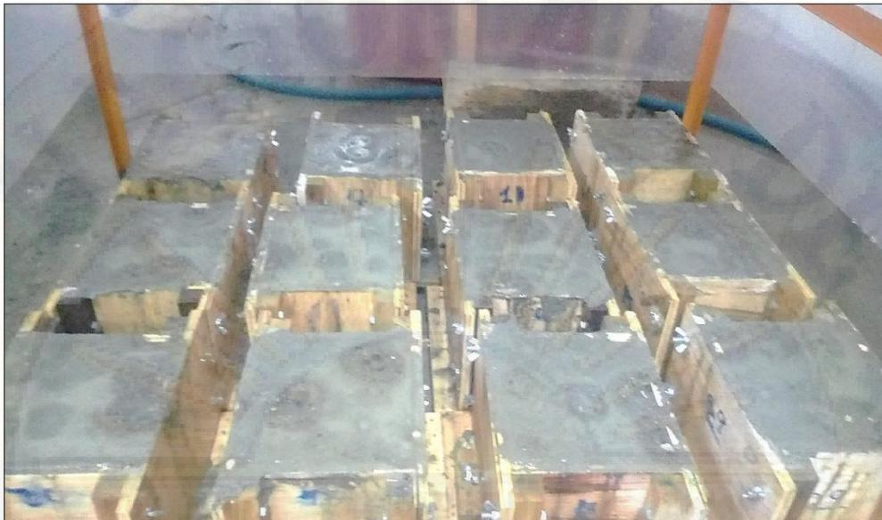
*Foto 20: Probetas con impacto de gotas pluviales del simulador de precipitación.*
