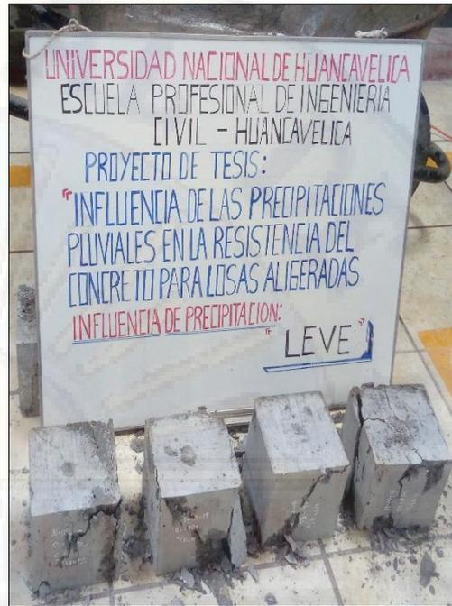
Foto 27: Probeta sometida a compresión. Foto 28: Probetas sometidas a compresión
