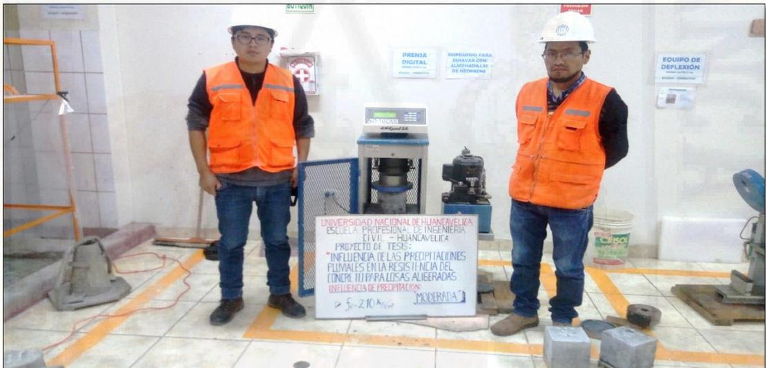
Foto 26: Ensayo a compresión de las probetas influenciadas con una intensidad de precipitación moderada a los 28 días de edad.
