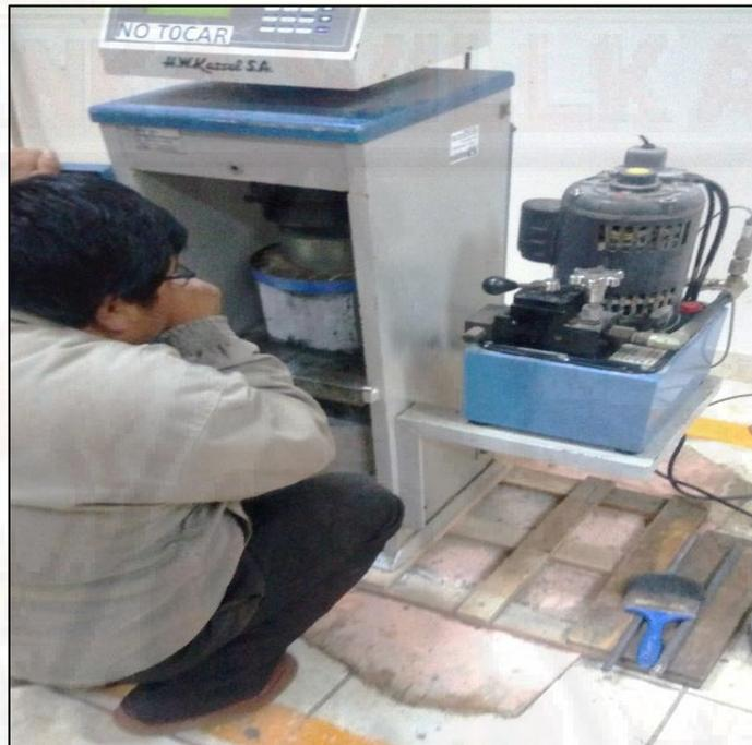
Figura 36: Roturas de probetas en la maquina a compresión.
