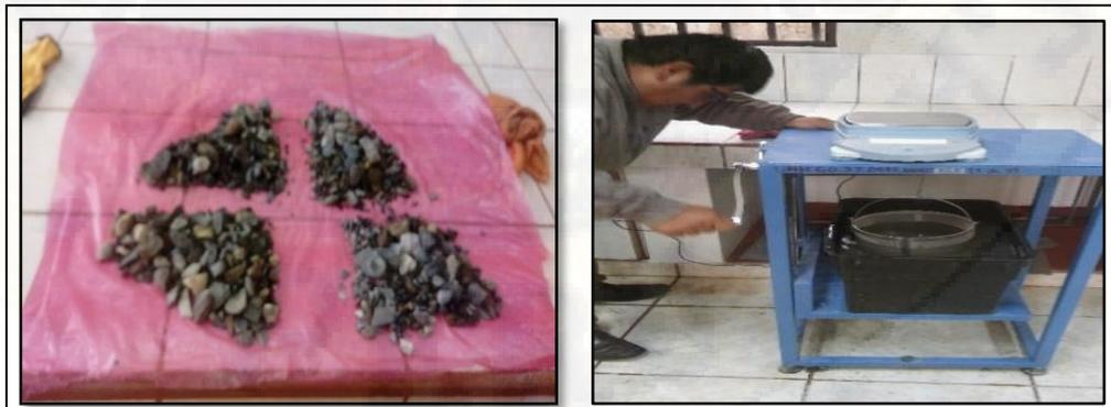
Figura 22: Peso específico y absorción de agregado grueso.
