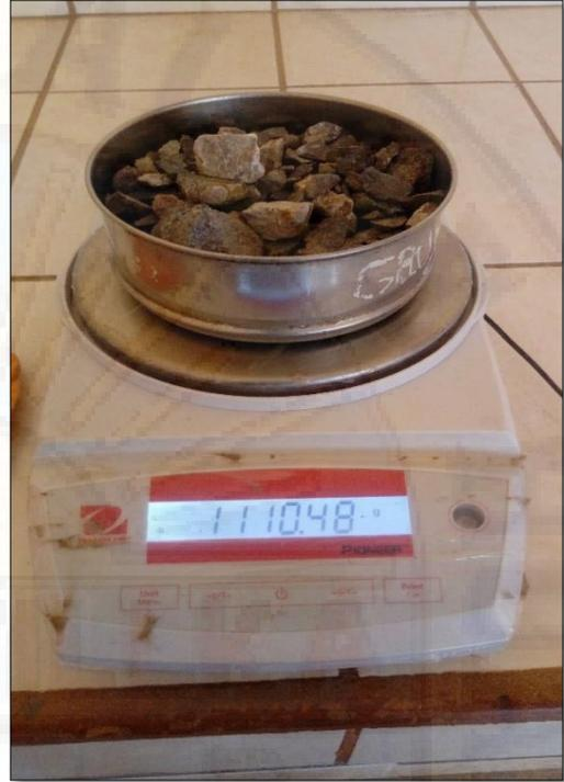
*Foto 10: Peso de muestra agregado grueso.*
