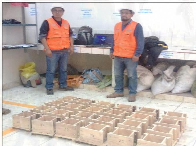
Figura 28: Moldes de probetas cubicas de arista 150 mm.
