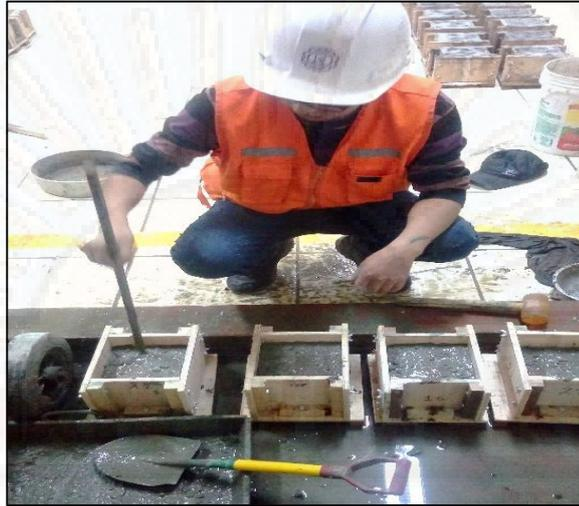
*Figura 29: Elaboración de las probetas cúbicas.*
