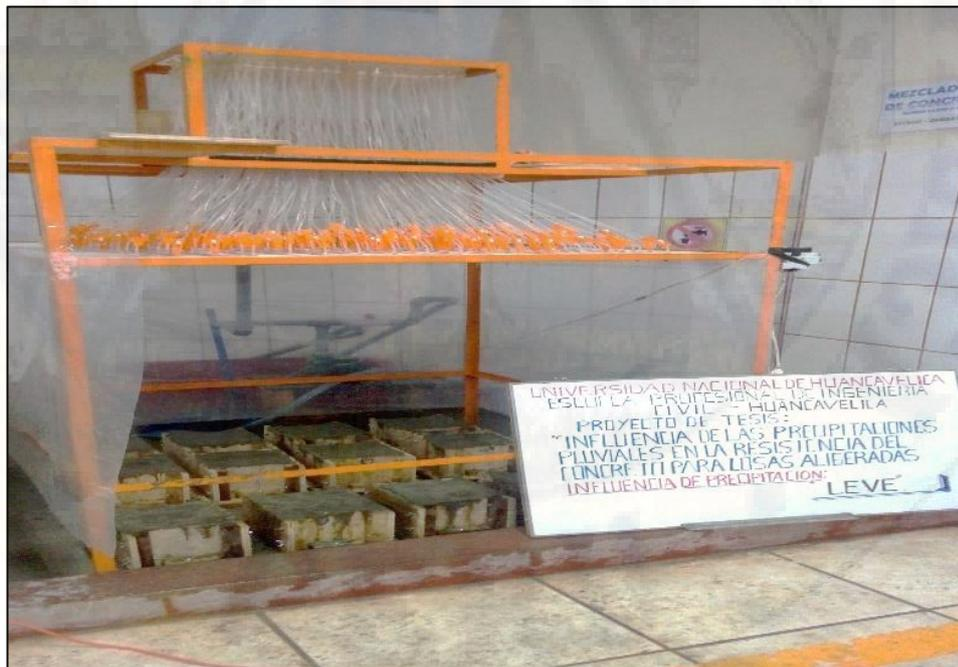
Figura 31: Probetas cúbicas sometidas a una intensidad de precipitación ligera.
