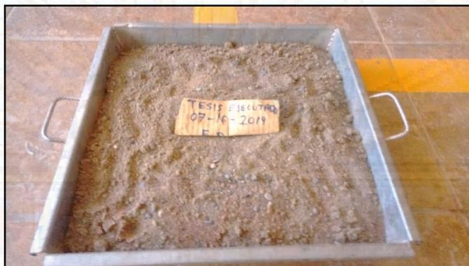
Figura 26: Muestra seca del agregado fino.
