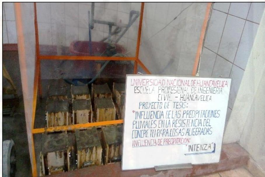
*Figura 33: Probetas de concreto sometidas a intensidad de precipitación artificial fuerte.*
