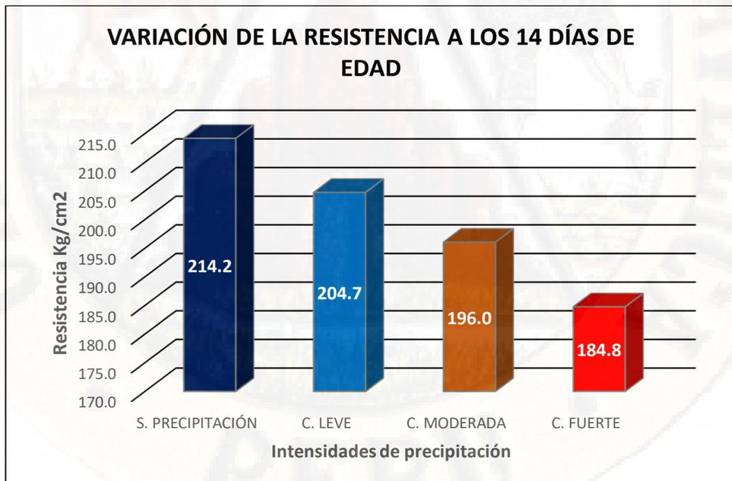
Figura 44: Comparación de resistencias entre los cuatro tipos de concreto con interferencia de precipitaciones a diferente intensidad de precipitación a la edad de 14 días de curado del concreto.
