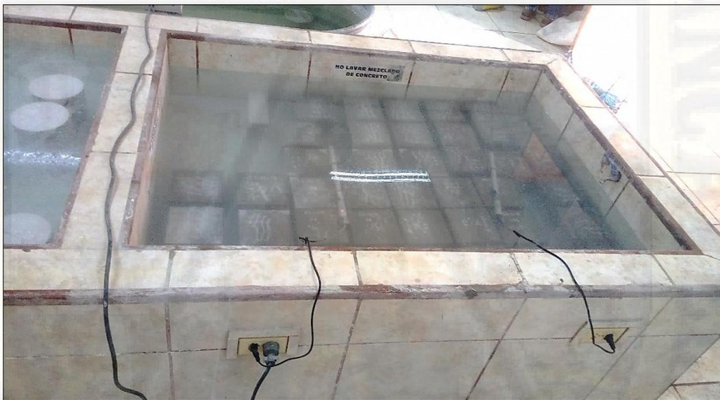
*Foto 23: Probetas sumergidas en el pozo de curado con una temperatura de 23° a 25°.*
