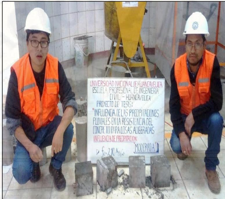
Figura 37: Probetas después de ser sometidas a compresión.
