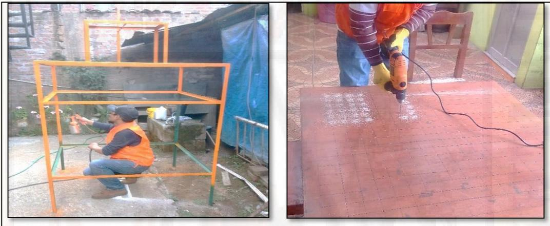
*Figura 14: Estructura metálica de soporte y plancha de distribución de agujas.*
