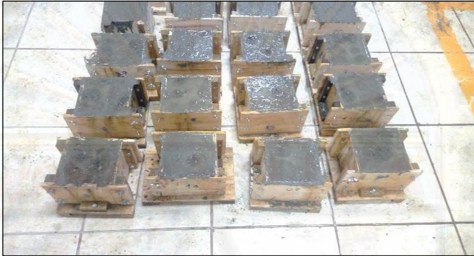
Figura 30: Probetas cúbicas de concreto terminadas de elaborar.
