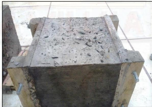
*Figura 34: Desmoldado de probetas cúbicas después de 24 horas.*
