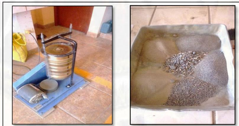
Figura 24: Granulometría del agregado fino.
