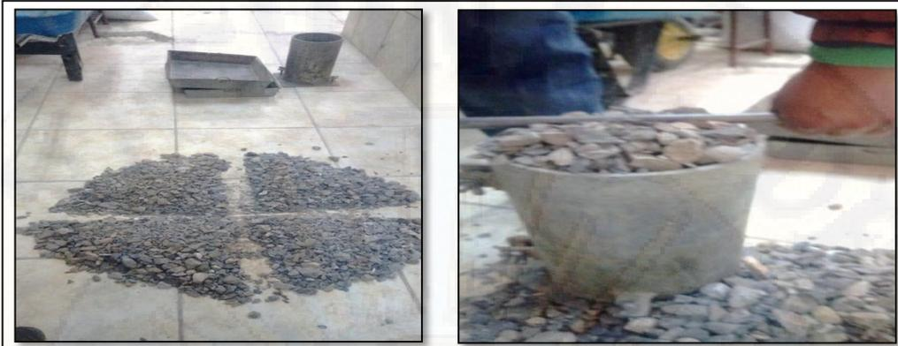
Figura 23: Peso específico del agregado grueso.
