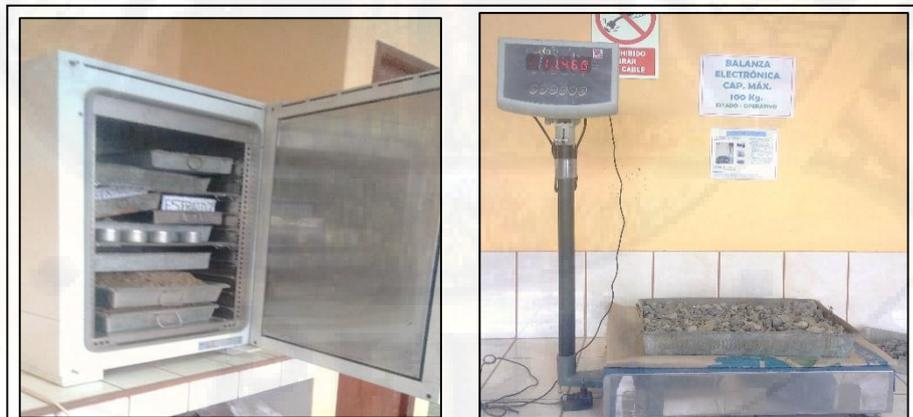
Figura 21: Muestra del agregado grueso para contenido de humedad.
