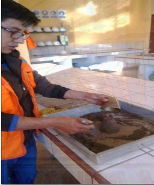
*Foto 05: Ensayo de absorción.*
