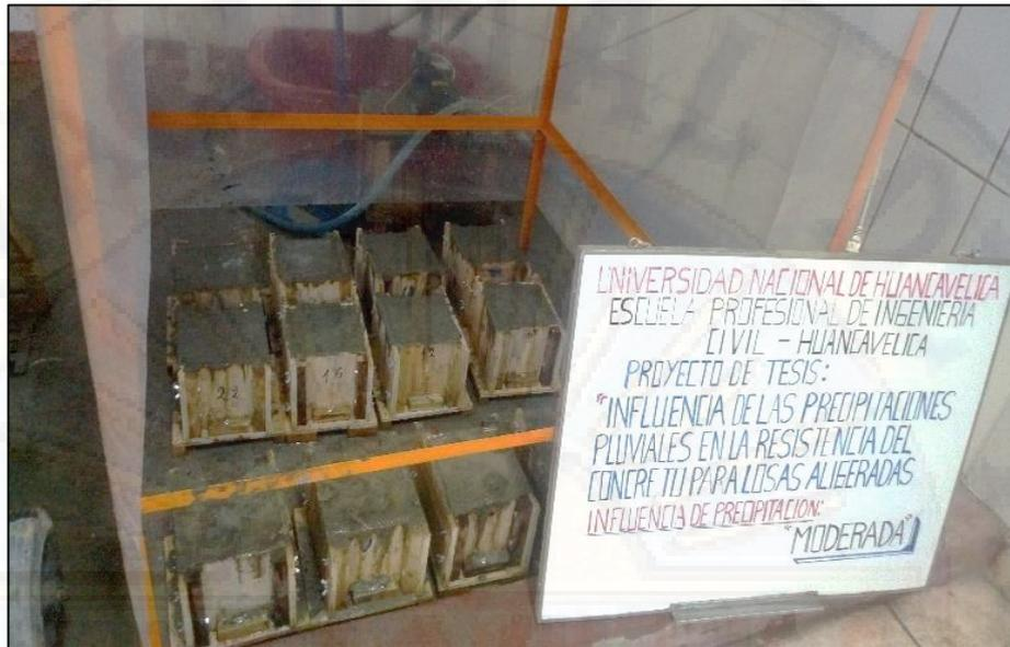
*Figura 32: Probetas de concreto sometidas de intensidad de precipitación artificial moderada.*
