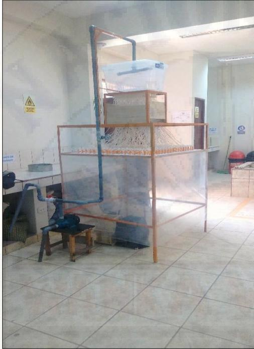
Foto 13: Simulador de precipitación pluvial
