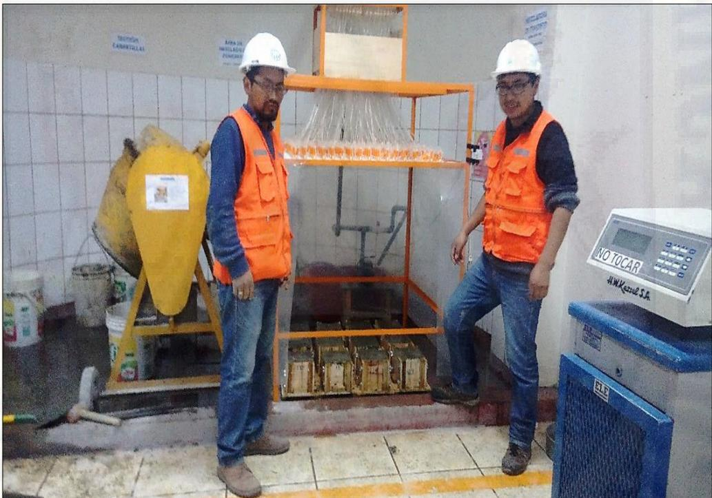
Foto 19: Probetas cubicas sometidas a una intensidad moderada de precipitación pluvial artificial.
