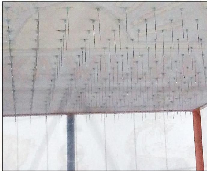
Figura 18: Distribución de agujas formadoras de gotas de lluvia artificial.
