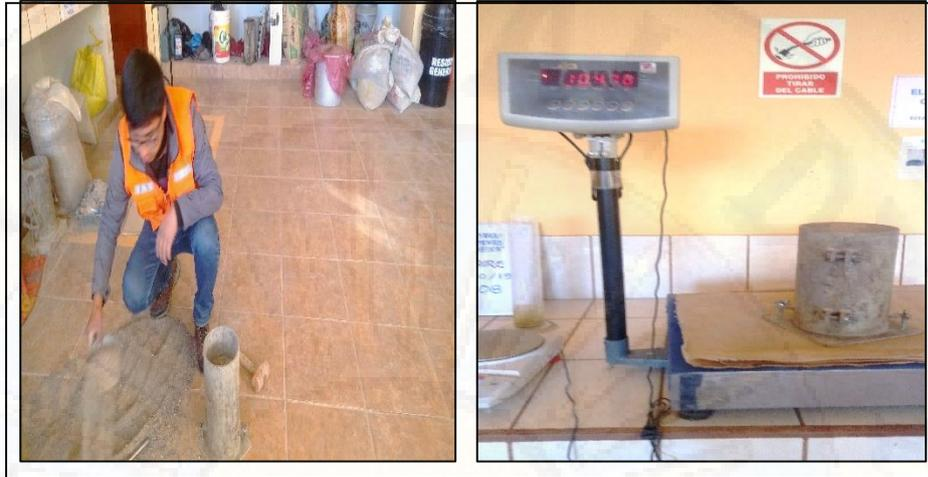
Figura 27: Peso suelto y peso compacto del agregado fino.
