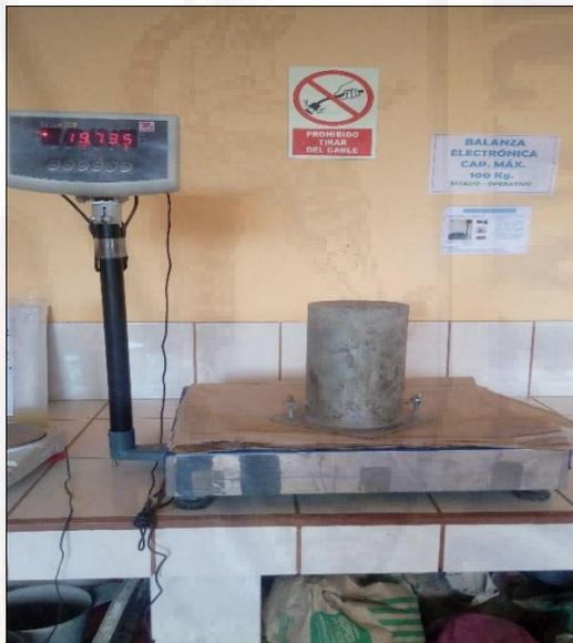
*Foto 03: Ensayo de P. U. suelto y compacto. Foto 04: Peso unitario suelto y compacto*
