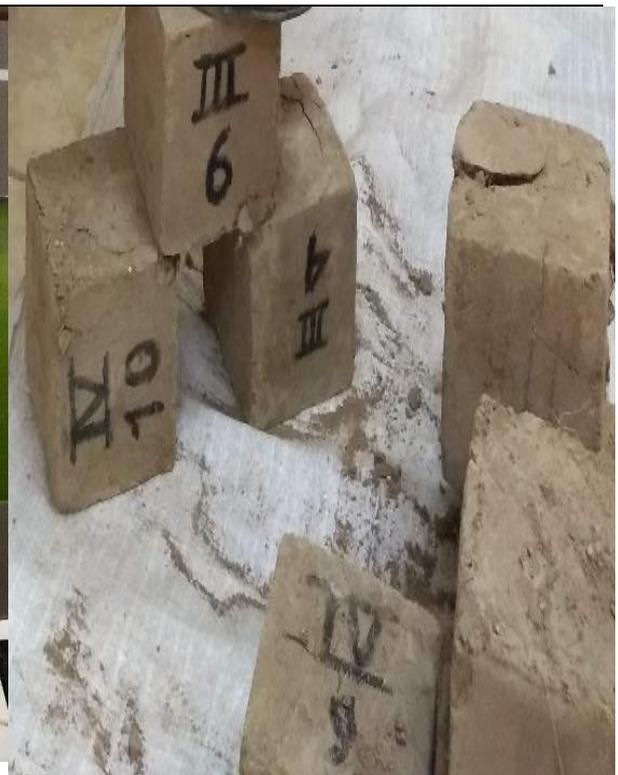
Carga maxima soportado por el bloque prismático IV 10 (33% de fibra)
