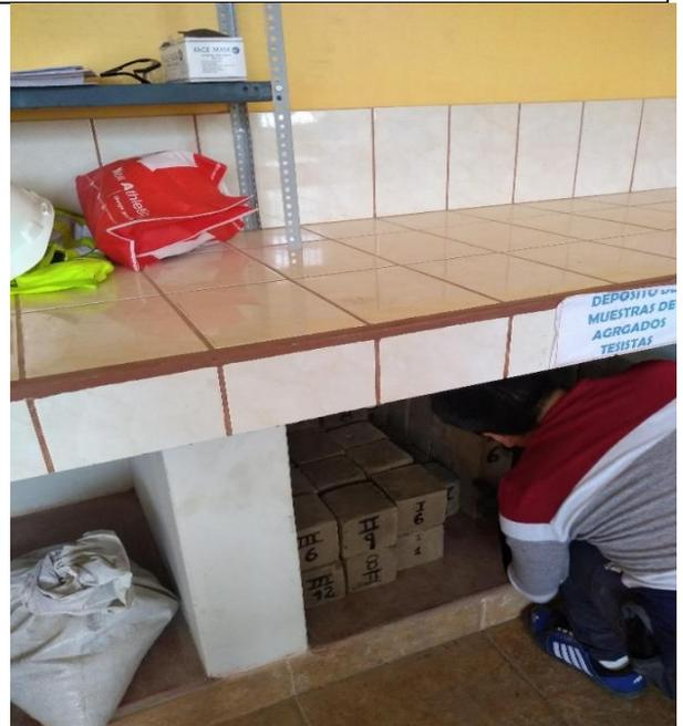
Almacenamiento de los bloques prismáticos para la prueba de compresión
