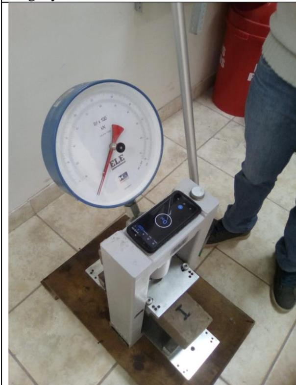
Máquina para ensayo a flexión
