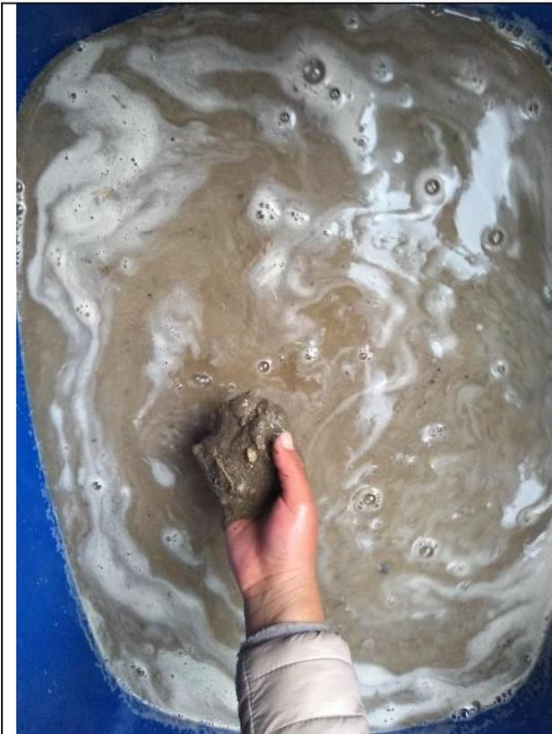
Disolución completa del adobe después de sumergir después de 12 horas
