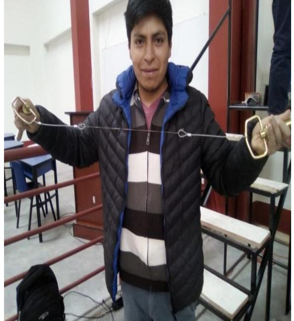
Piezas de la Maquina Universal Hidraulica con el cual se realizó el ensayo de tracción de la Fibra de Maguey
