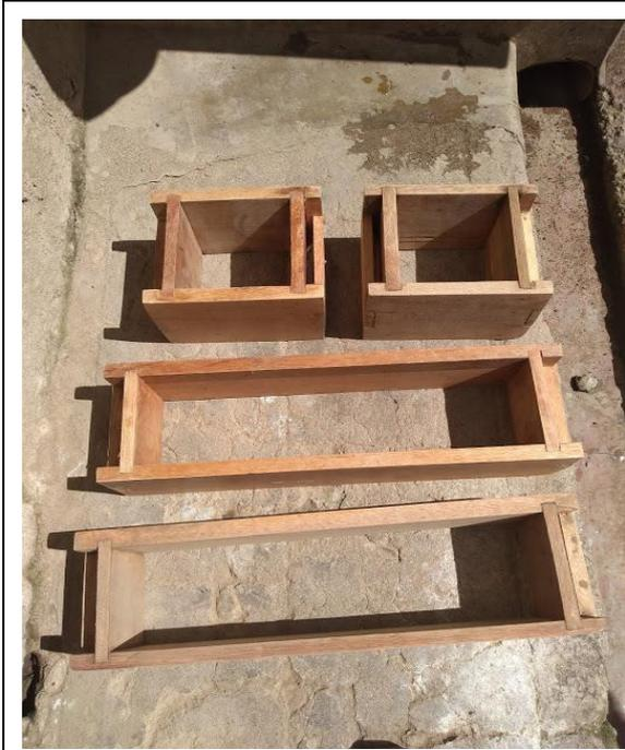
Moldes de las probetas prismaticas
