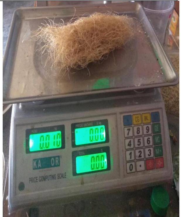
Utilizacion de balanza eletronica para pesar la muestra de maguey en estado seco y saturado
