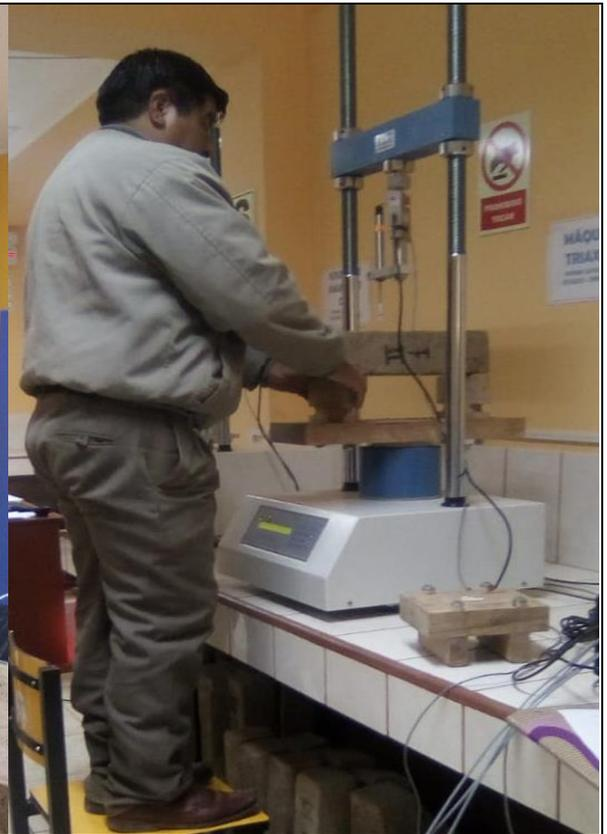
Adaptando la maquina triaxial por parte del técnico del laboratorio para ensayo a tracción por flexion
