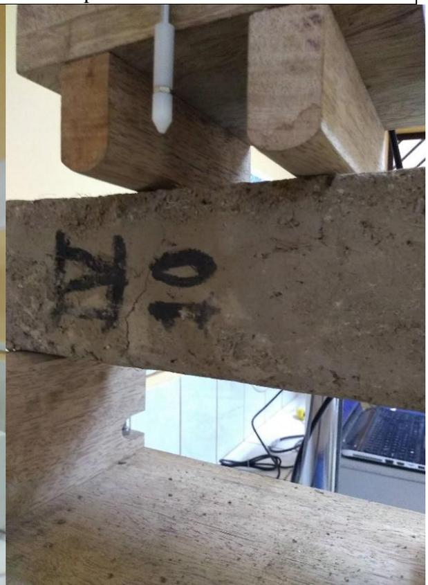
Adaptando la muestra en la maquina triaxial
