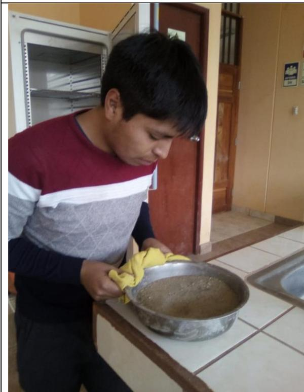
Muestra seca lista para la elaboración del ensayo de granulometría
