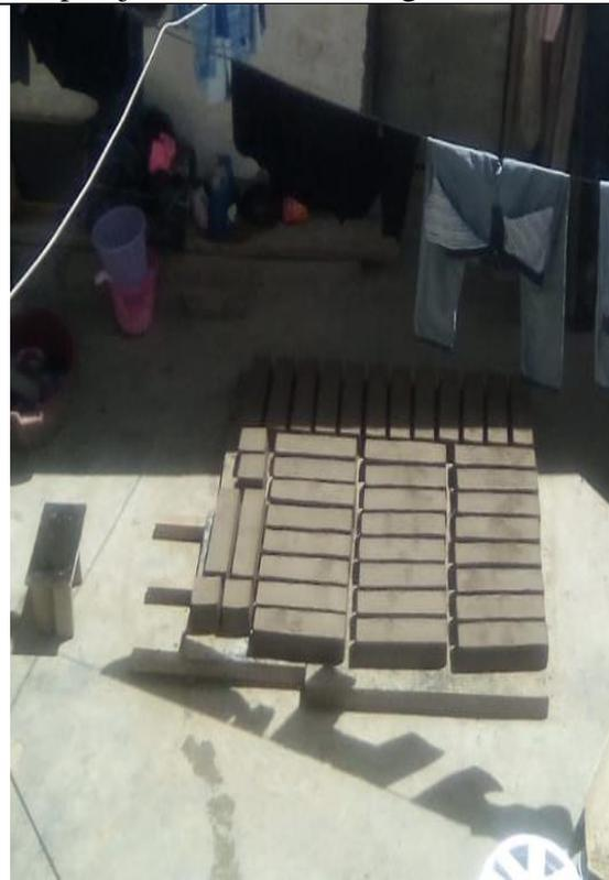
Secado y almacenamiento de las probetas
