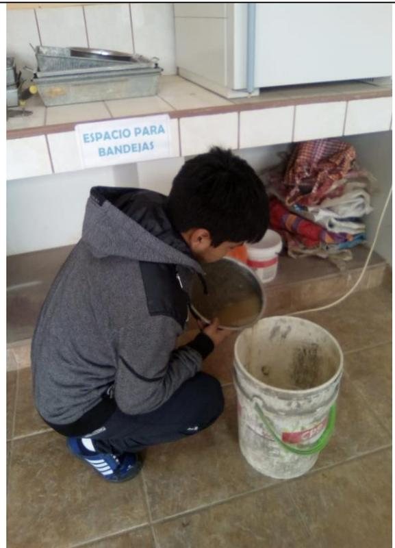
Expulsión del agua de la muestra para ser colocado al Horno por 24 h
