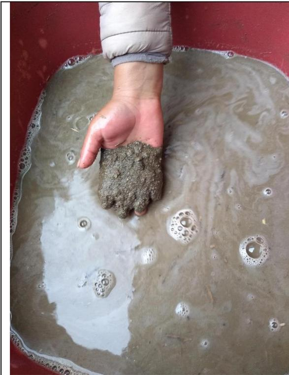
Disolución de una parte del adobe después de sumergir 24 horas
