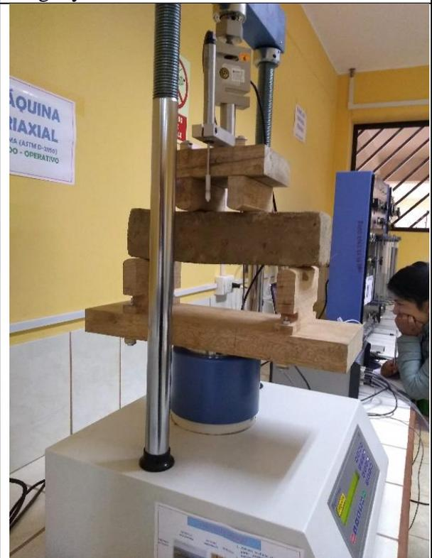
Triaxial asimilado para ensayo a flexión
