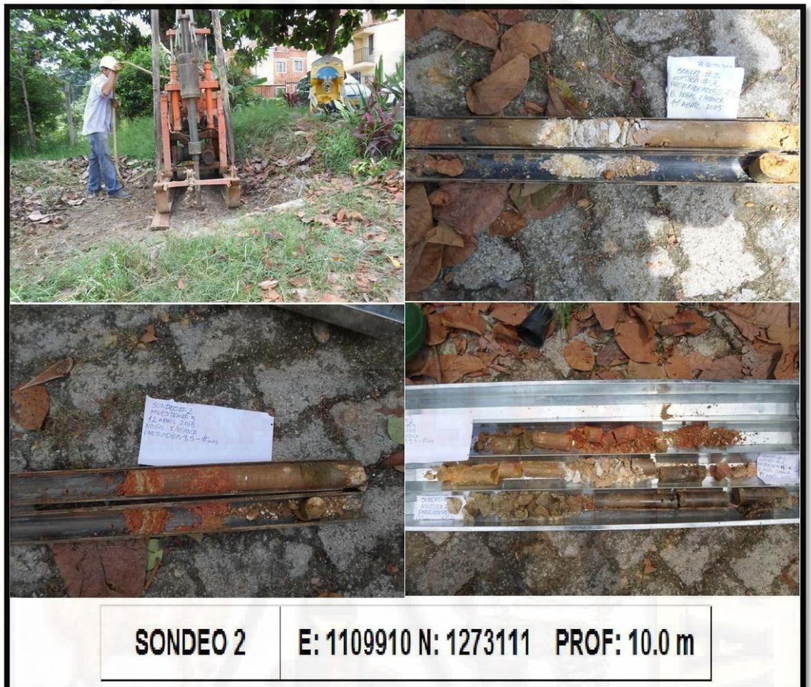
Figura 75. Registro del sondeo 2 con una profundidad de 10 metros. Fuente: Propia.
