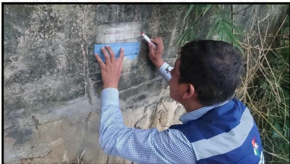
Figura 111. Ubicación del sector para la toma del dato de resistencia.
