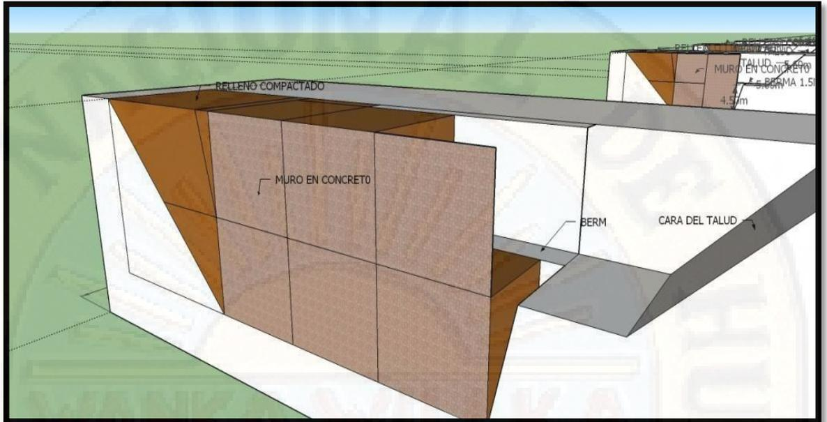
Figura 129. Esquema de la tercera sección del muro construido y parte del relleno, la excavación es proyectada para la siguiente sección.
