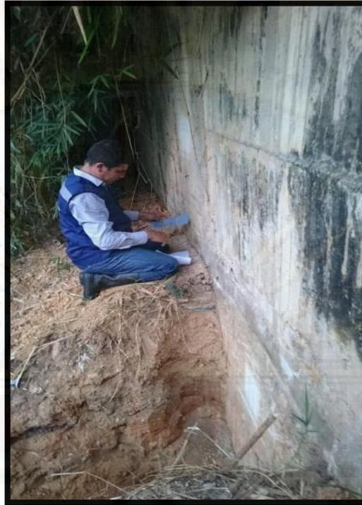
Figura 114. Toma de medidas del muro de contención en concreto existente.
