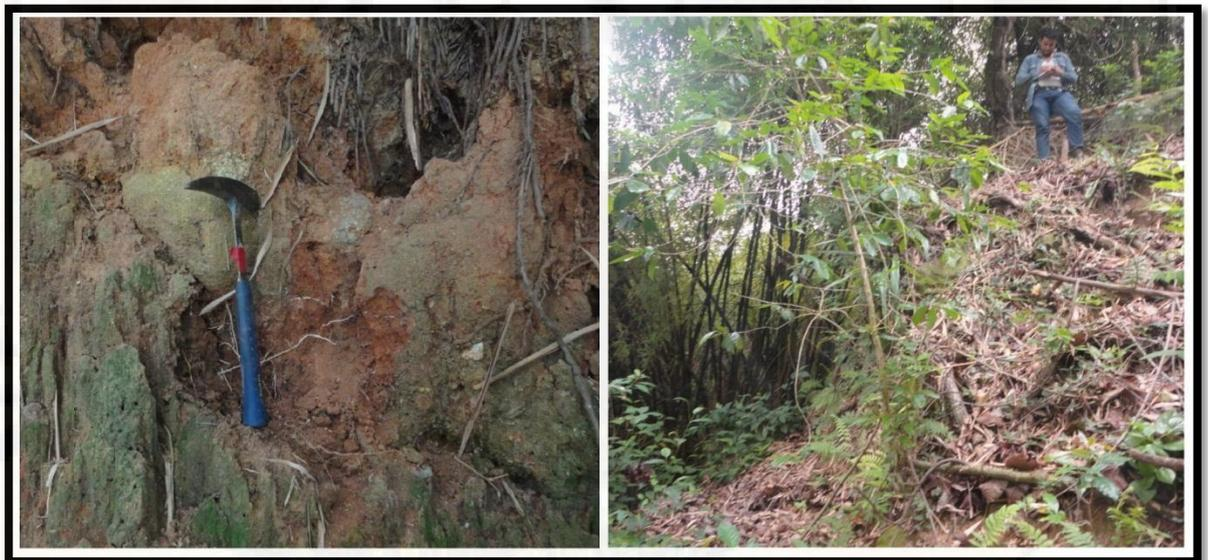
Figura 13. Suelos del cuaternario indefinido (Unidad A). Se observa la tonalidad y el grado de meteorización del suelo. Fuente: Propia.
