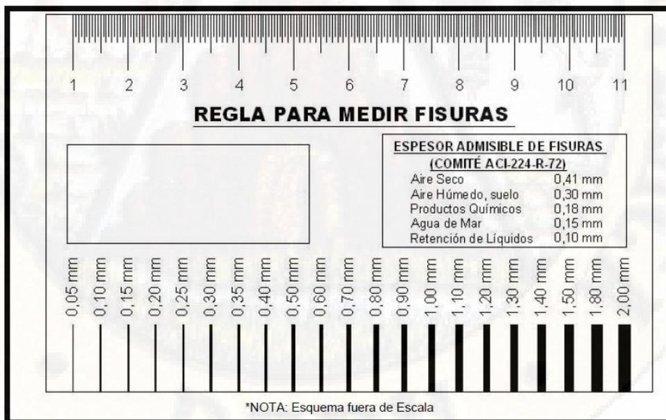
Figura 115. Regla guía para la medición de fisuras o agrietamientos.
