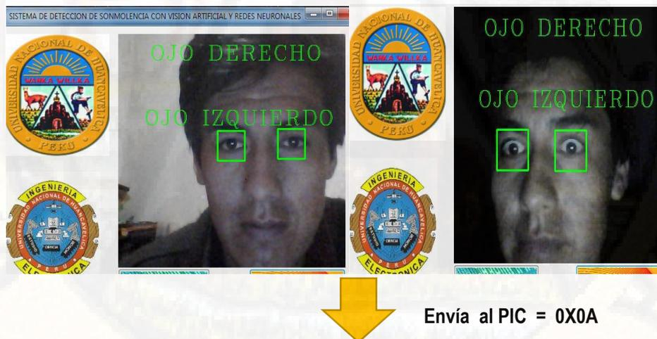
**Figura 4.20:** Detección de ojos despiertos para el PIC 0X0A.
