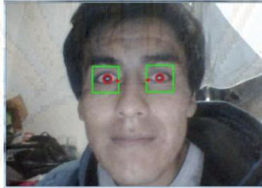
**Figura 4.9:** Detección de ojos y pupila durante la conducción.
