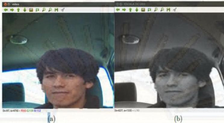
**Figura 4.8:** Conversión de color a escala de gris. (a) imagen RGB. (b) imagen en escala de grises.
