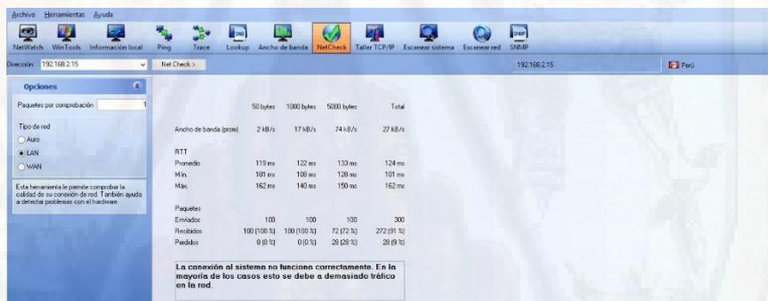
Figura 28. Evaluando Porcentaje de Error Lan Con el Software Axcence Nettools 5
