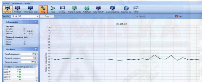
Figura 18. Evaluando tiempo de respuesta LAN en red actual utilizando el software axence nettools 5
