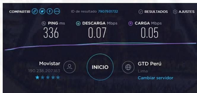
Figura 26. Evaluando Tasa de Transferencia Wan en Red Actual con el Medidor de Prueba de Velocidad de Ookla
