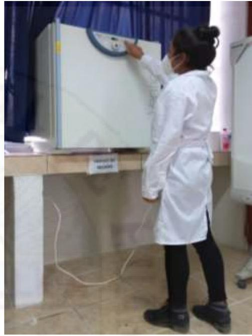
*Fotografía 2. Programación de la temperatura y tiempo de la estufa.*
