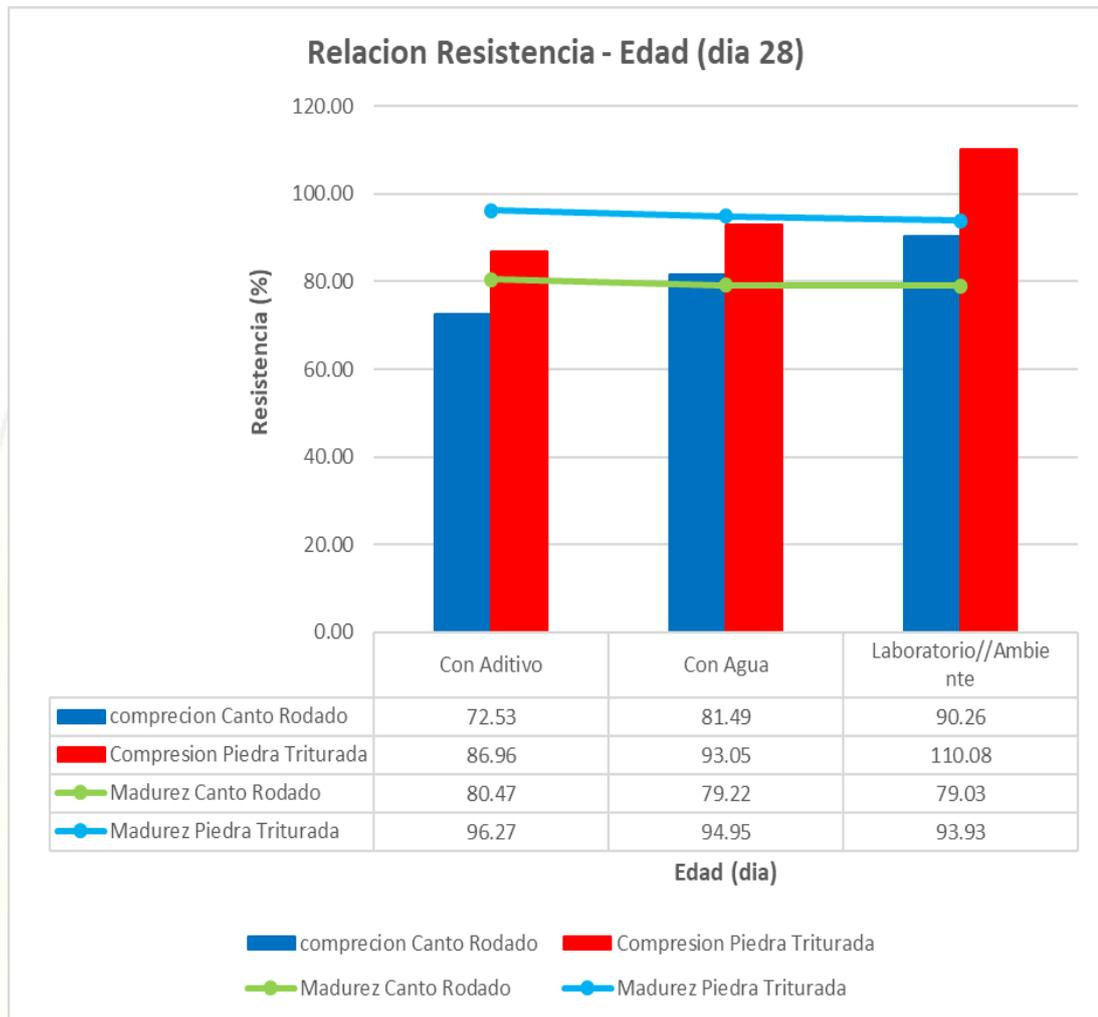
**Figura 5.33:** Gráfico que representa la resistencia a compresión y madurez, en porcentaje. Para la edad de 28 días, tipo de agregado grueso, tipo de curado en obra y laboratorio
