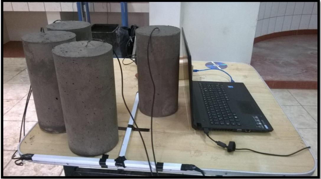
**Fotografía 17 : Colocación de los sensores en las probetas curado en laboratorio para su respectivo registro de temperaturas**
