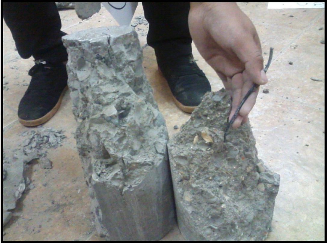
Fotografía 25: Probeta con sensor después de haber pasado por la máquina de compresión
