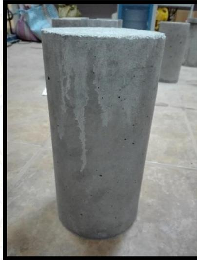
**Figura 2.6:** Probeta de concreto 15 cm de diámetro por 30 cm de altura
