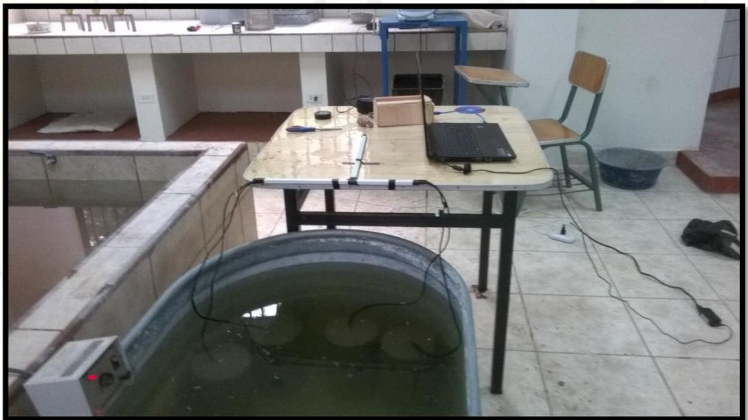
Fotografía 19 : Sumergiendo las probetas de concreto para su respectivo curado durante los 28 días
