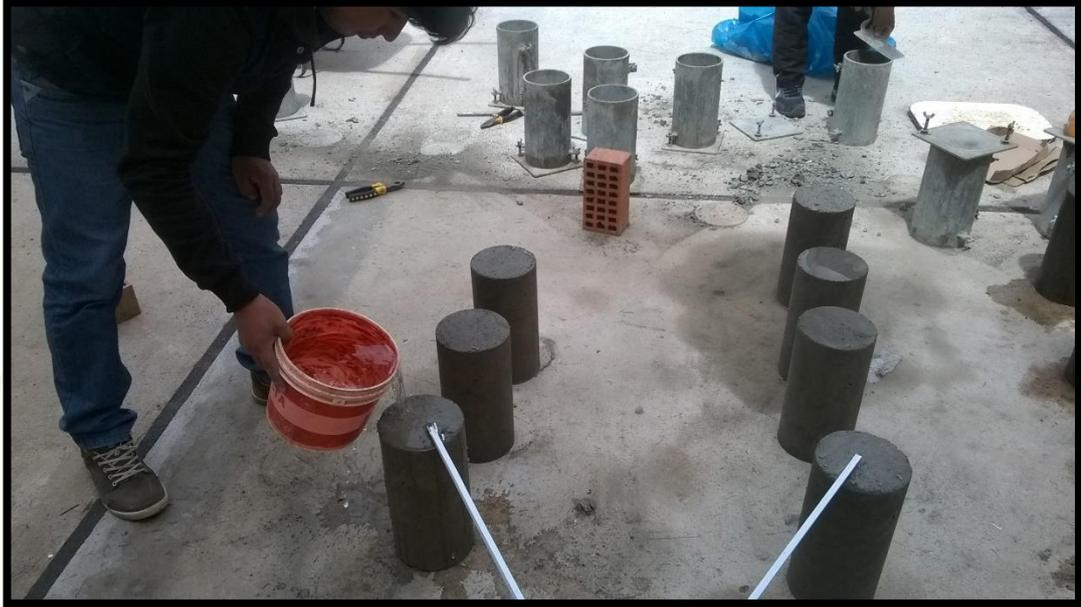
Fotografía 14 : Curado de probetas de concreto con agua
