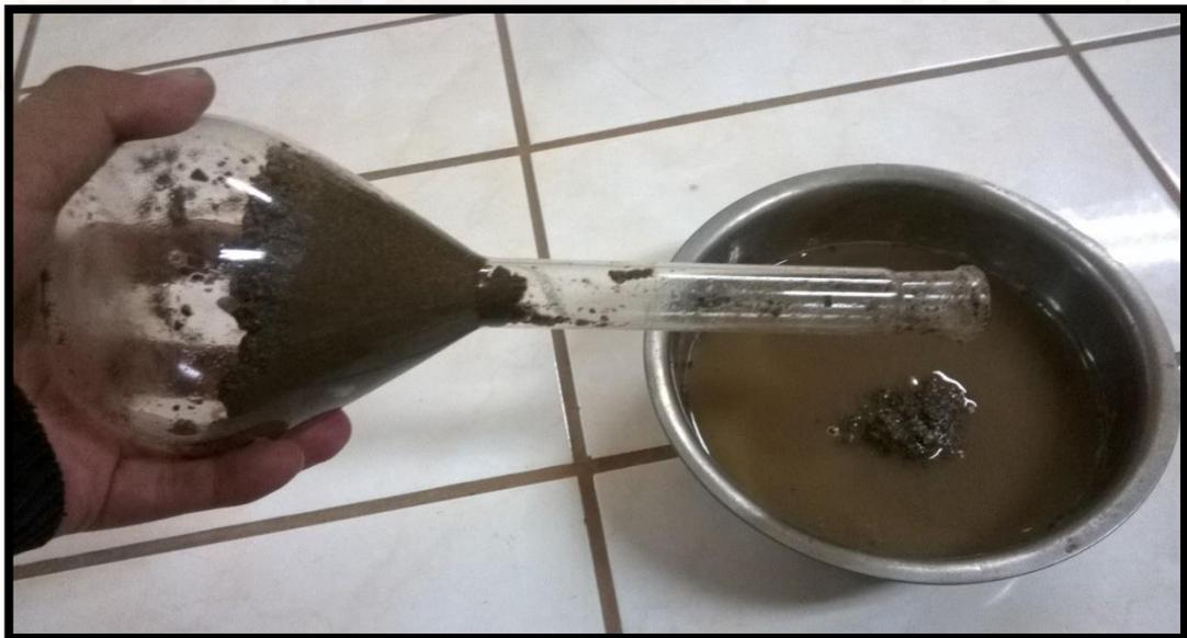
Fotografía 3 : Ensayo de la gravedad específica para el agregado fino
