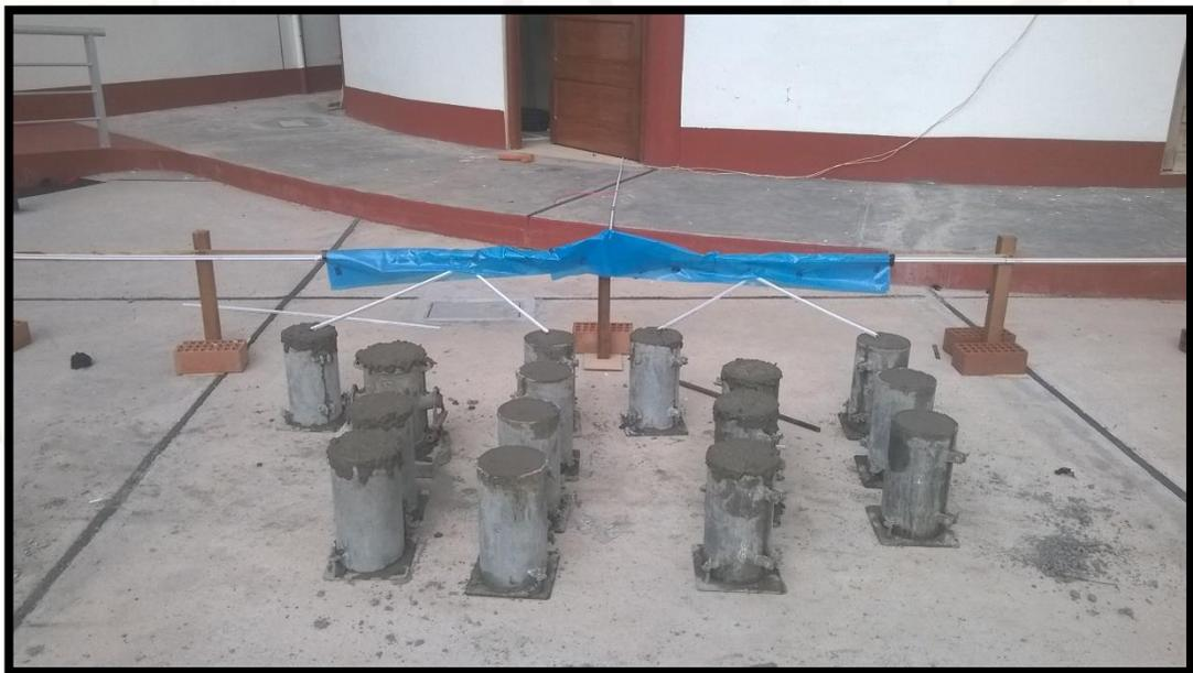
**Fotografía 11 : Colocación de los sensores dentro de las probetas para el respectivo registro de temperaturas**
