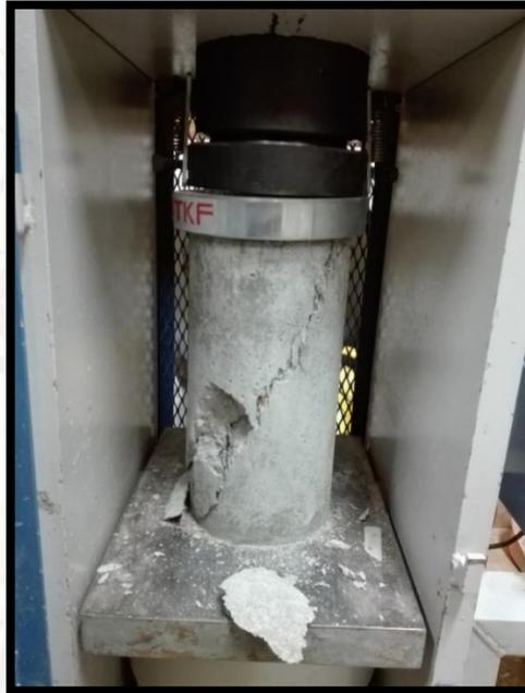
*Figura 2.8:* Imagen de la rotura a compresión de la probeta de concreto
