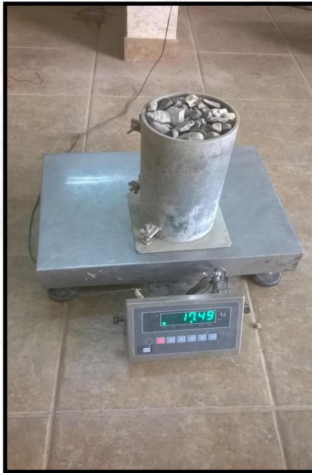
Fotografía 5 : Pesado de la briqueta más el agregado grueso (piedra triturada)
