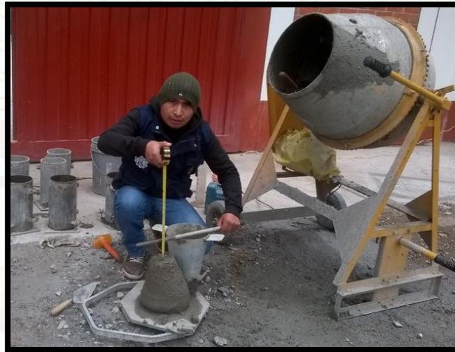
*Figura 2.5:* Medición del slump
