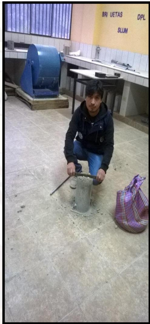
Fotografía 6 : Obtención del peso específico compactado de los agregados
