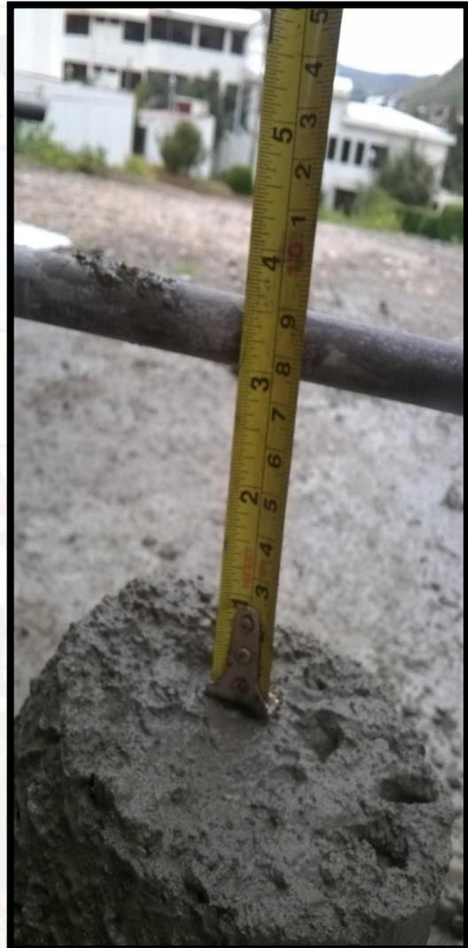
Fotografía 9 : Obtención del slum para cada tipo de diseño
