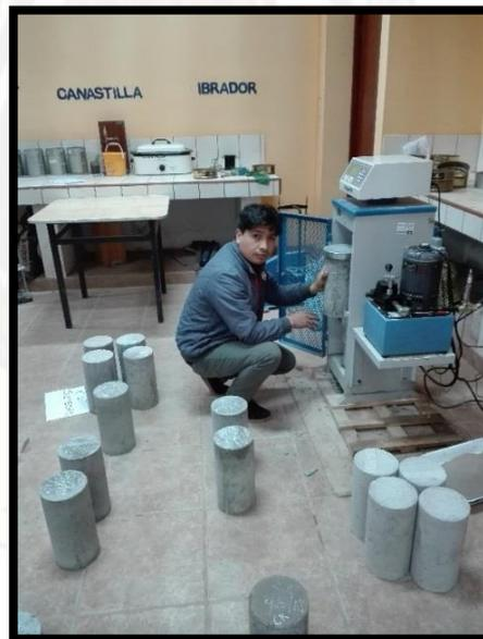
**Figura 2.7:** Colocación de la probeta de concreto en la máquina para su respectiva rotura a compresión
