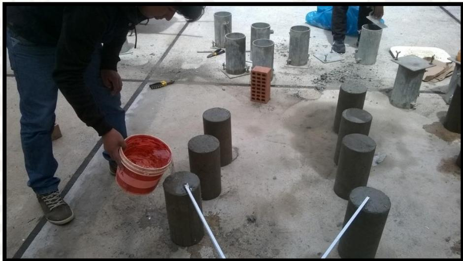
**Figura 2.11:** Curado de probetas de concreto con agua
