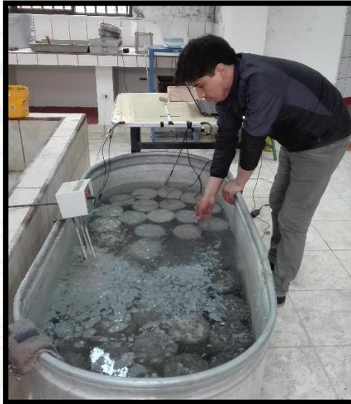
**Figura 2.10:** Probetas de concreto sumergido en agua para su curado
