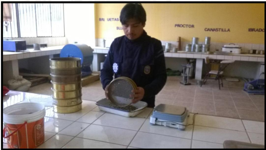
Fotografía 4 : Tamizado de los agregados (grueso, fino y global)
