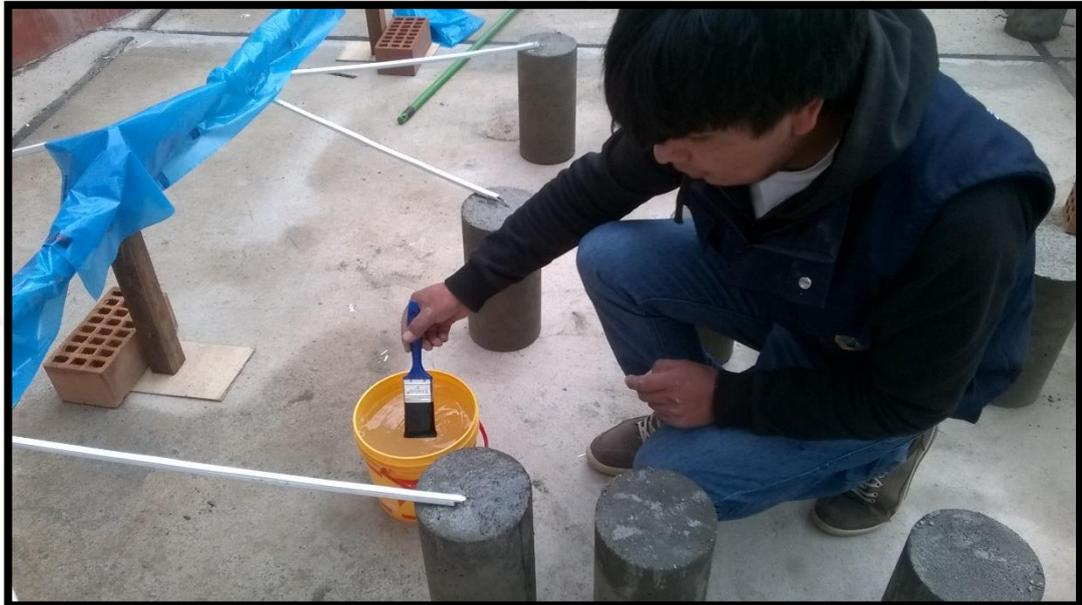
Fotografía 13 : Curado de las probetas de concreto con aditivo
