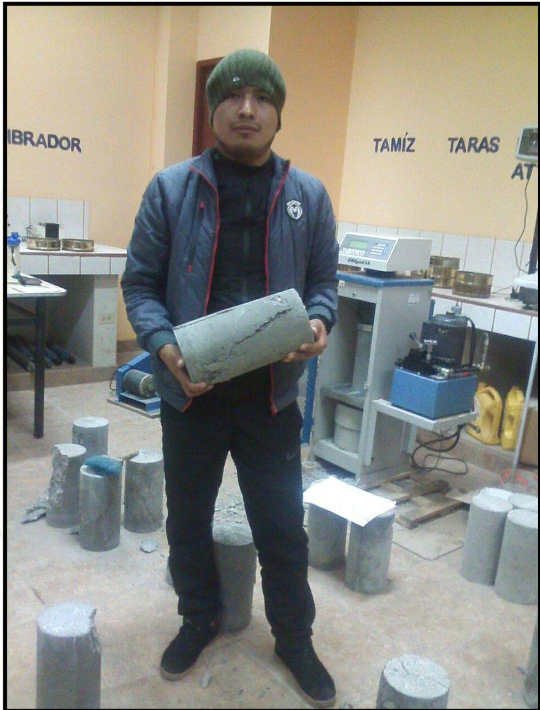
Fotografía 22 : Rotura a compresión de las probetas de concreto
