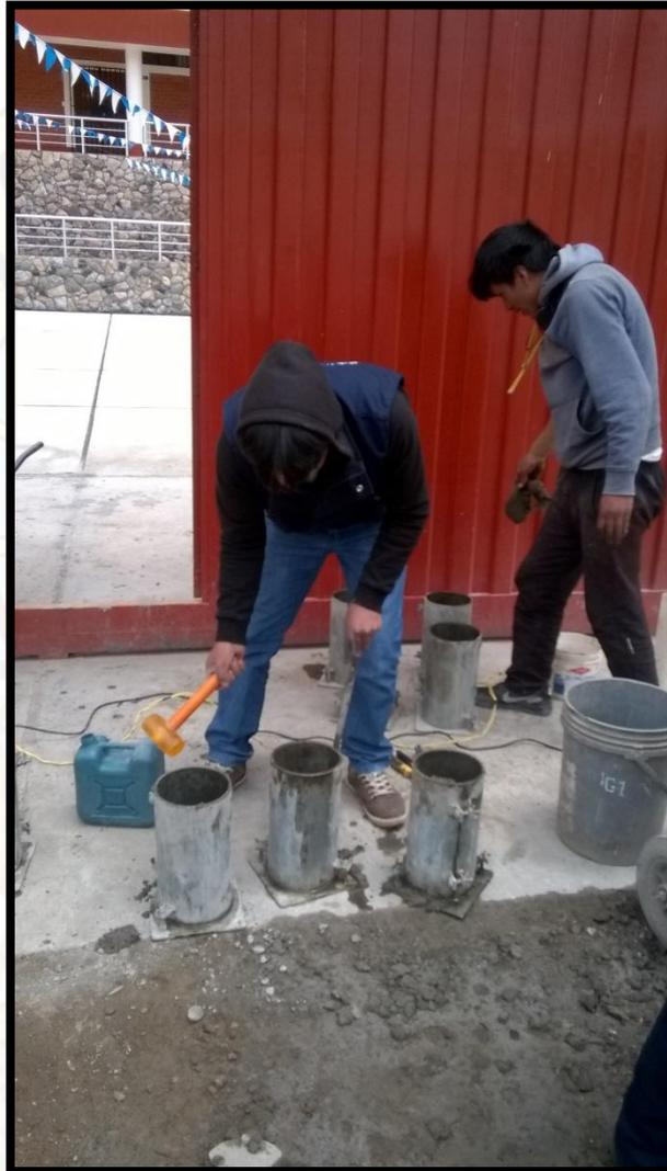
Fotografía 10 : Extracción de los espacios vacíos al momento del vaciado, del concreto a las briquetas
