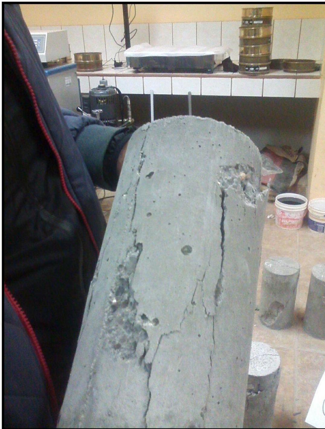
Fotografía 24 : Probeta después de haber pasado por la máquina de compresión
