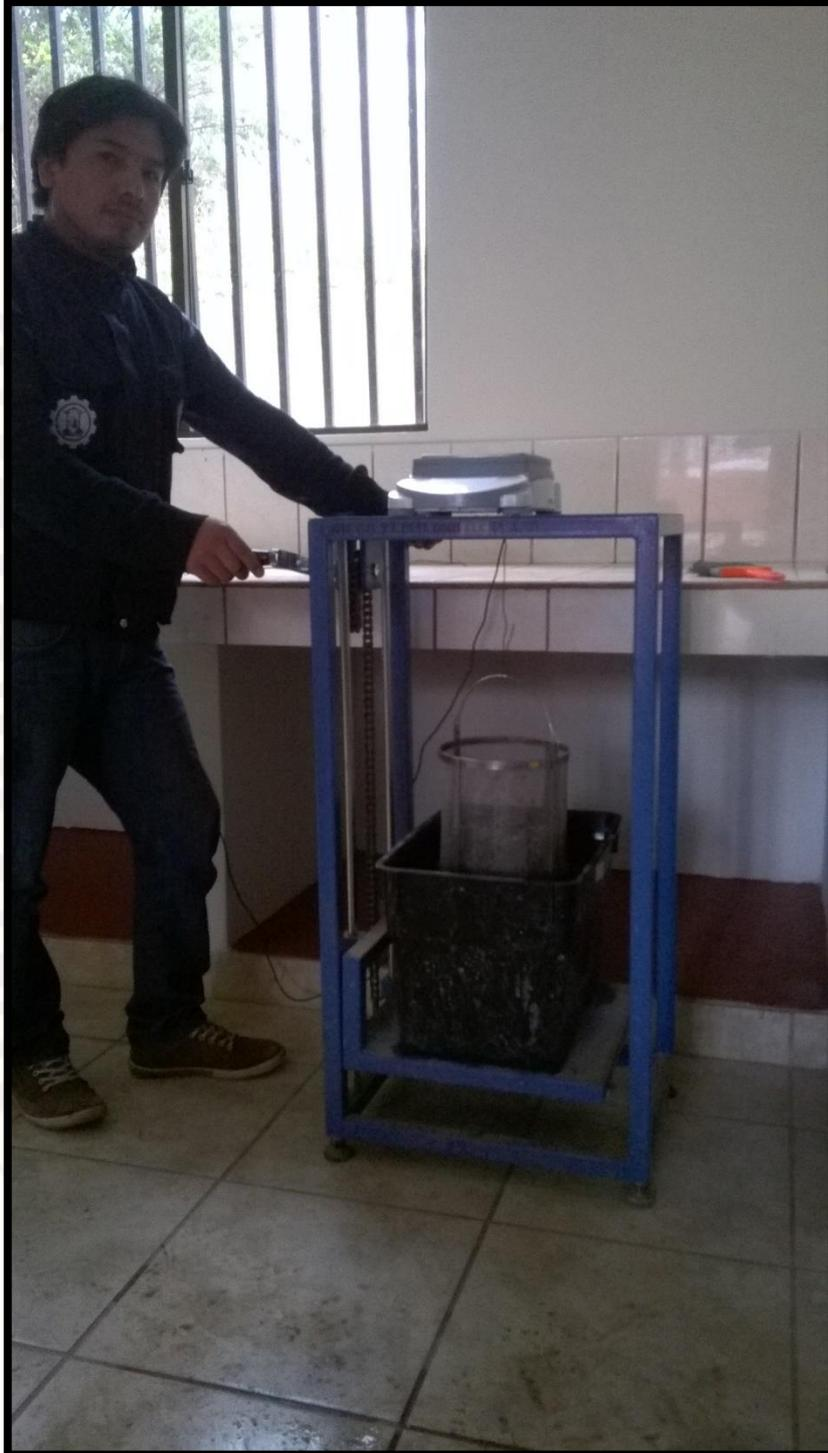
Fotografía 2 : Ensayo del peso específico del agregado grueso
