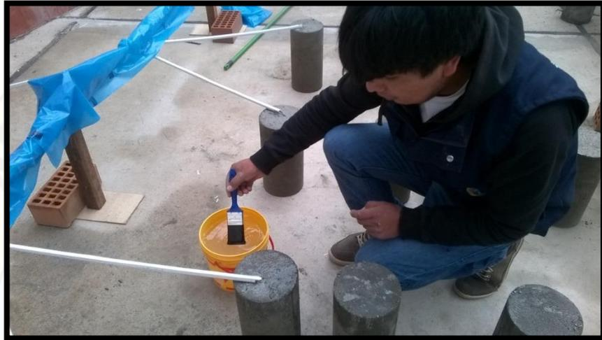
**Figura 2.12:** Curado de las probetas de concreto con aditivo
