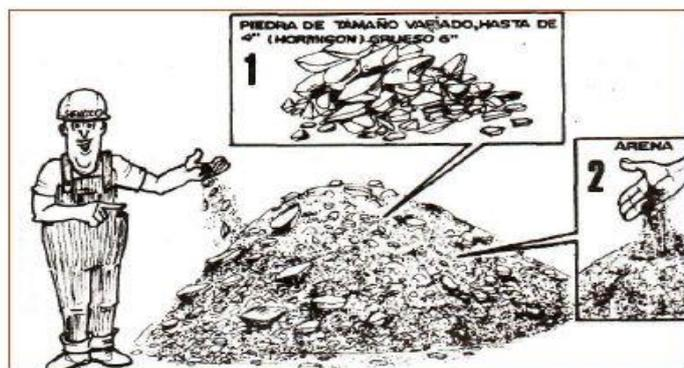
*Figura 2.4:* Agregado global o hormigón
