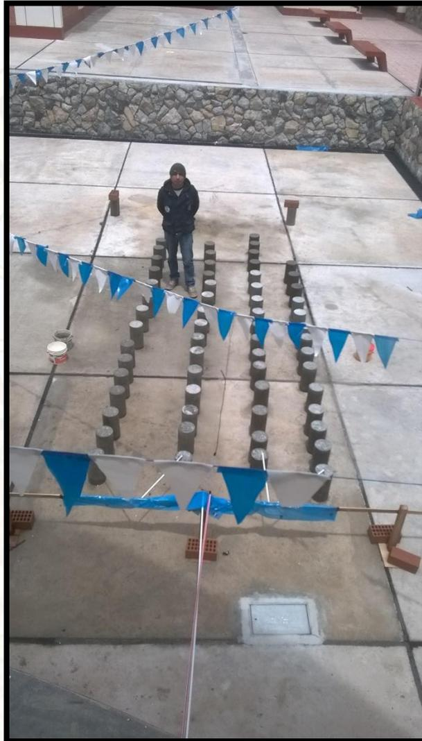
Fotografía 16 : Probetas con sensores y sin sensores para el respectivo ensayo de compresión en obra
