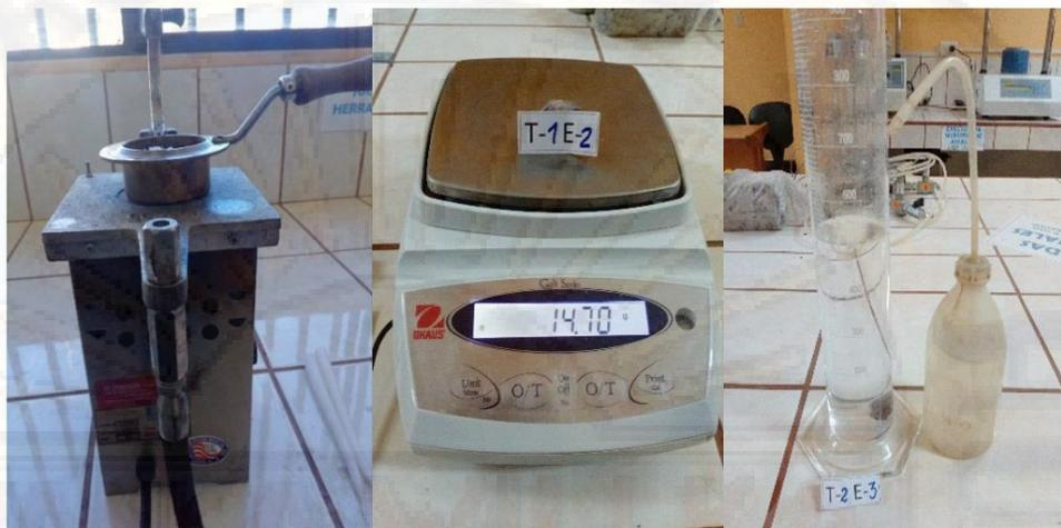
**Imagen N° 9:** Aparatos y equipos utilizados para el ensayo de peso específico.
