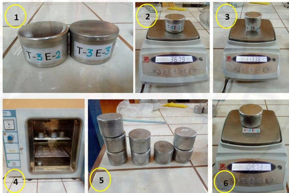
**Imagen N° 8:** Procedimiento para el ensayo de contenido de humedad (w%)
