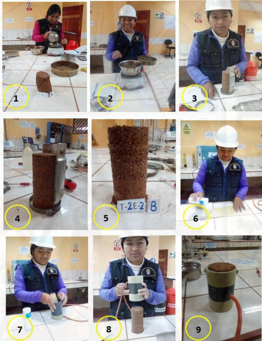
*Imagen N° 13 Procedimientos realizados para la obtención del espécimen.*
