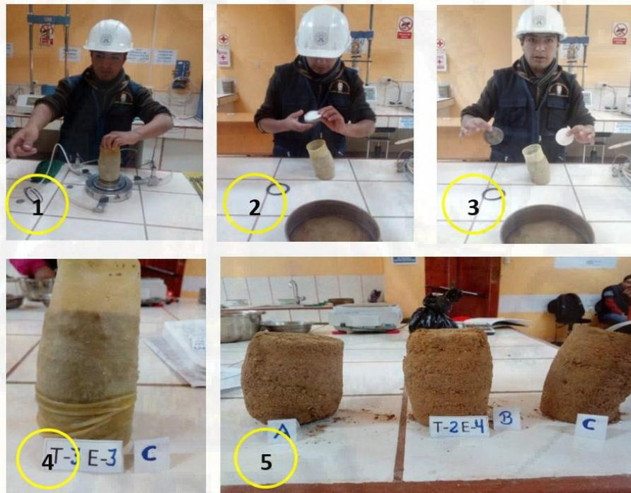
**Imagen N° 16** Procedimientos luego de la culminación del ensayo triaxial.
