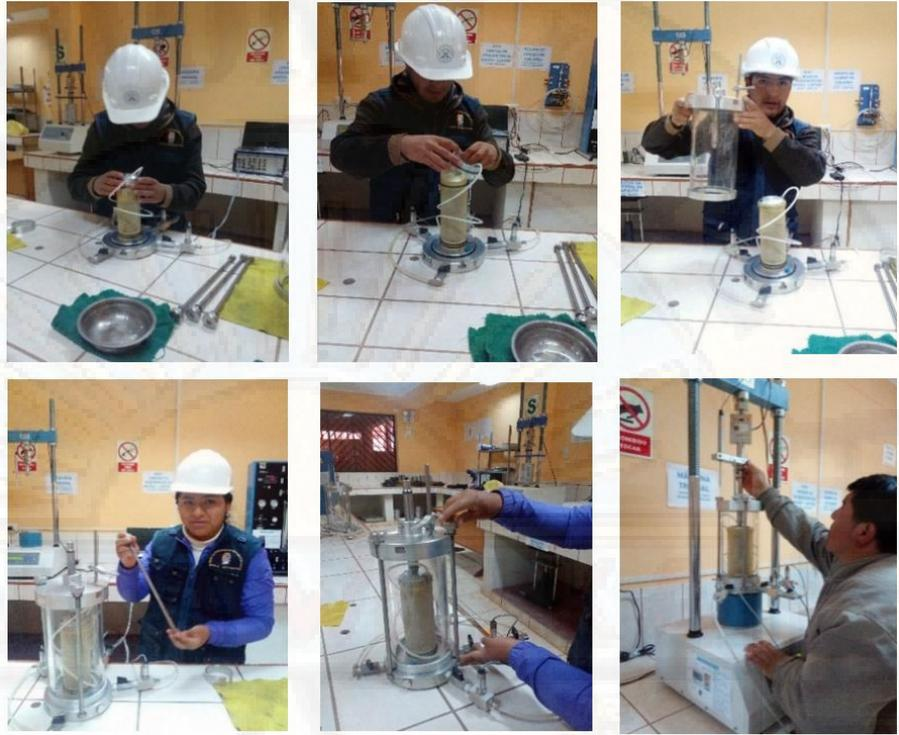
**Imagen N° 15** Procedimientos de la colocación de la celda en el equipo triaxial.
