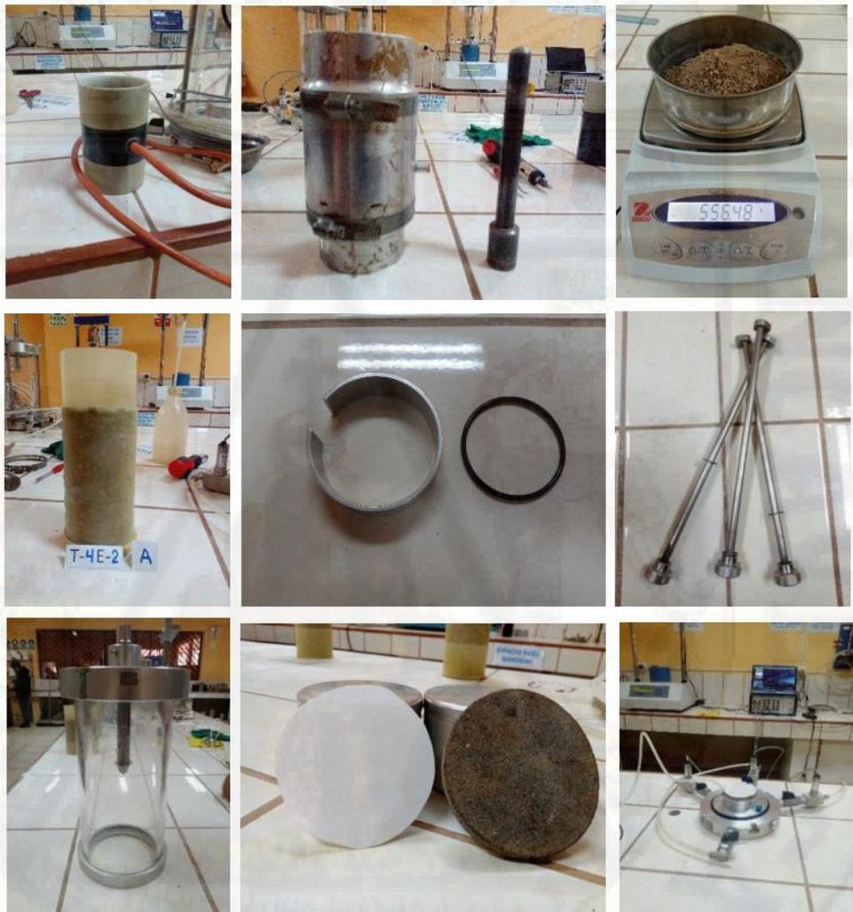
**Imagen N° 11** Aparatos y equipos utilizados para el ensayo Triaxial.
