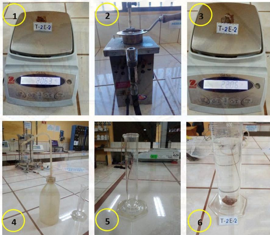
**Imagen N° 10:** Procedimientos realizados del ensayo de peso específico.
