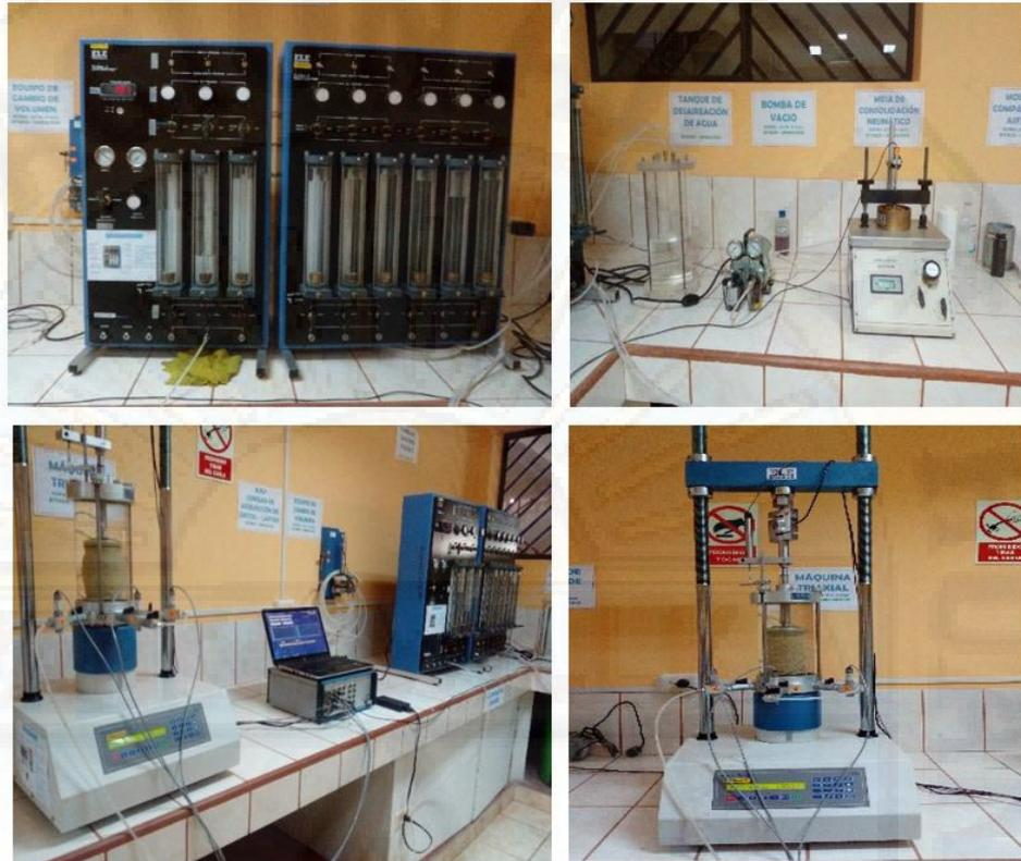
**Imagen N° 12** Aparatos del Equipo Triaxial.
