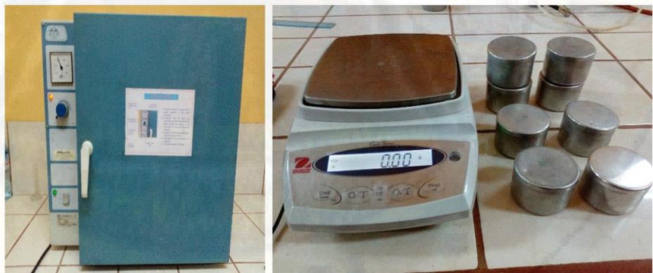
*Imagen N° 7: Aparatos y equipos utilizados en el ensayo de contenido de humedad (w%).*
