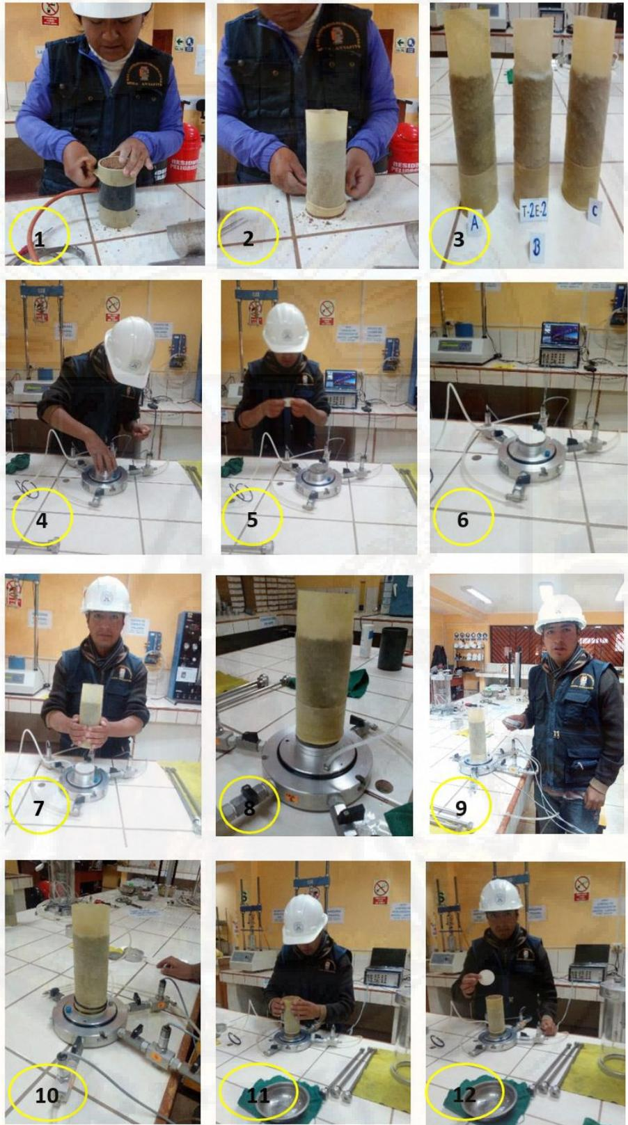
*Imagen N° 14 Procedimientos de la colocación del espécimen en la celda triaxial.*
