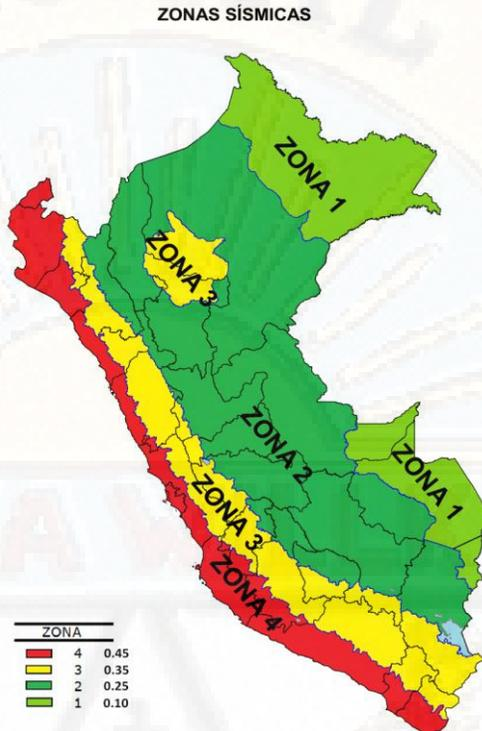
Figura 20. A cada zona se asigna un factor  $Z_n$  según se indica en la Tabla. El factor  $Z$  se expresa como una fracción de la aceleración de la gravedad.
