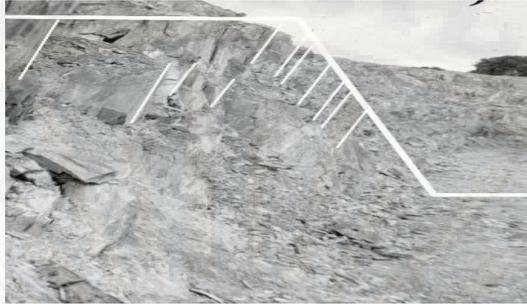
Figura 11. Foto y esquema, Rotura por vuelco
