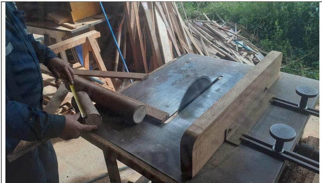
Fotografía 18: Corte de probeta con máquina de corte, con base liso parte superior e inferior de una altura 20cm
