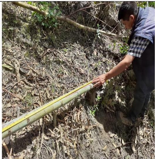
Fotografía 3: Medición de rollizo de eucalipto con wimcha de 2.6m de longitud.
