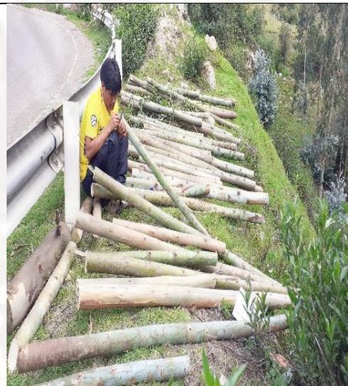
Fotografía 4: Enumeración de rollizos de eucalipto para los ensayos de compresión y flexión.
