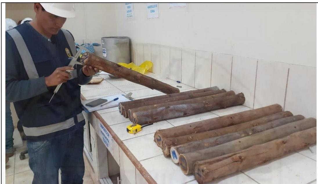
Fotografía 13: Enseguida se continua la medición de diámetro en pulgadas de rollizos de eucalipto en estado seco al aire, haciendo uso de herramienta de vernier. Con contenido de porcentaje de humedad mínima.
