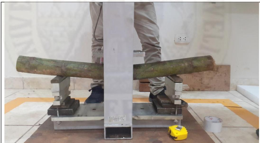
Fotografía 12: Se aplica la carga en el centro de la luz, obteniendo la resistencia a flexión para cada rollizo de eucalipto en estado inicial verde, estado húmedo y estado seco al aire.
