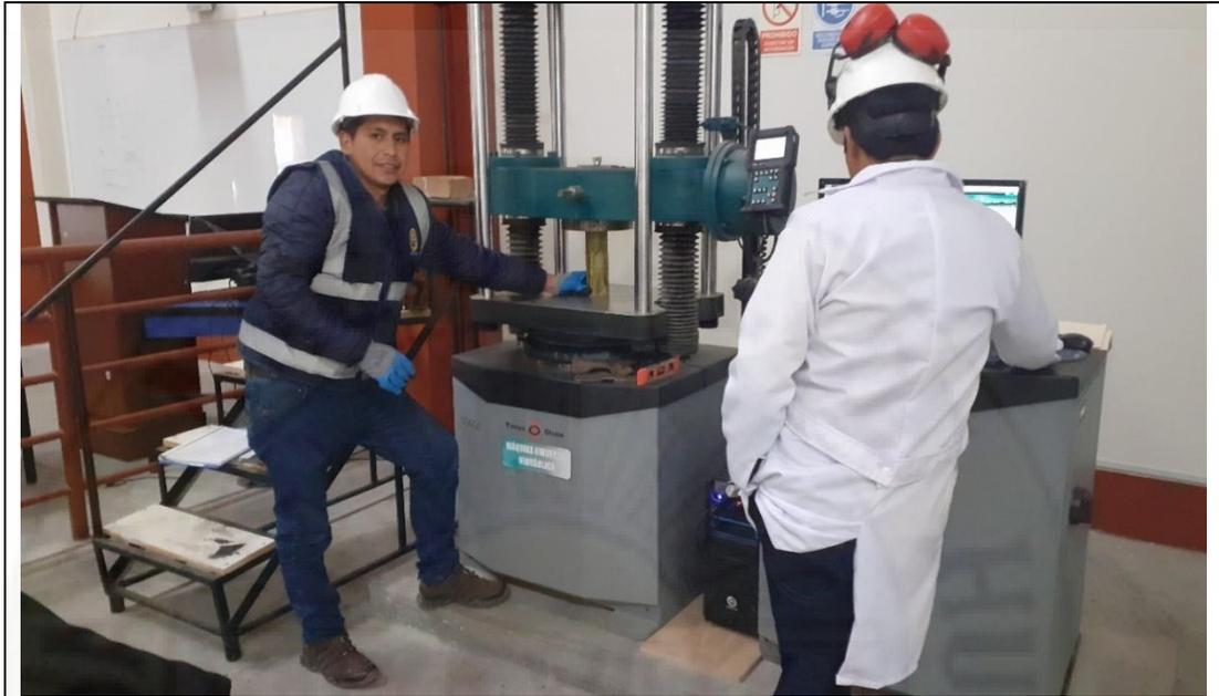
Fotografía 21: En seguida ubicamos nuestro rollizo de eucalipto y programamos nuestro software para someter a la resistencia de compresión.
