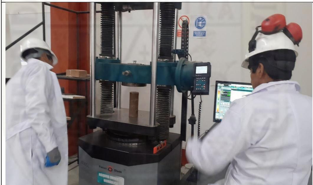
Fotografía 24: Nivelación la probeta de rollizo de eucalipto previo al ensayo
