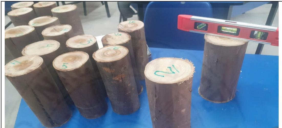
Fotografía 19: Una vez que tenemos las muestras de probetas de rollizos de eucalipto en estado inicial verde, estado húmedo y estado seco al aire, nivelamos con la regla de nivel, mantener una base inferior y superior homogéneo y liso.
