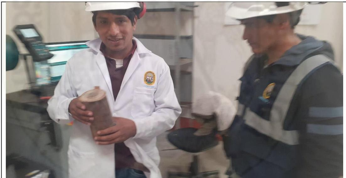
Fotografía 20: Verificamos muestra de probetas de rollizo de eucalipto que tenga una sección transversal uniforme y someter al ensayo de compresión dentro de máquina de prensa hidráulica
