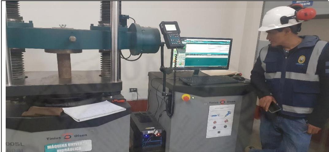
Fotografía 23: Prosiguiendo con el ensayo de resistencia a compresión dentro de software, procesamos el área de la sección transversal, altura.
