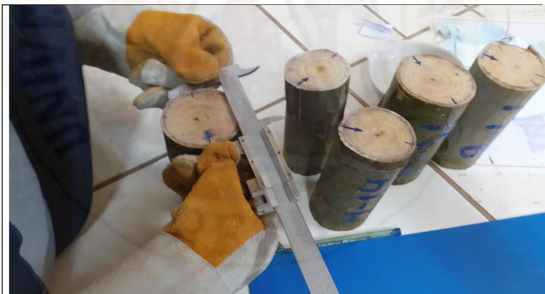
Fotografía 14: Medición de diámetros de rollizos de eucalipto mediante el uso del vernier de los rollizos de eucalipto en estado inicial verde, estado húmedo y estado seco al aire con una altura de consideración de 20cm para conocer el contenido de humedad iniciales.
