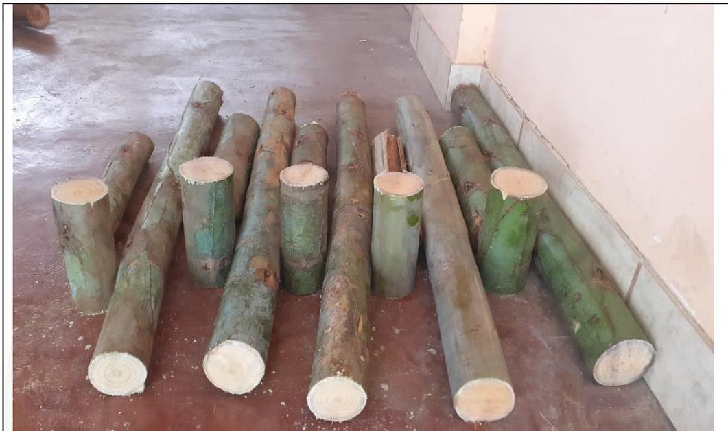
Fotografía 5: Corte de muestra de rollizos de eucalipto en estado inicial verde, estado húmedo y estado seco al aire para los ensayos de compresión y flexión de igual longitud para cada ensayo respectivo.
