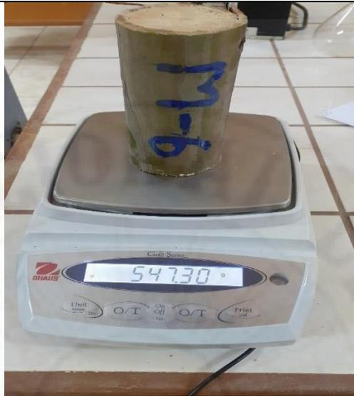
Fotografía 15: Medición peso inicial del porcentaje de humedad de cada muestra de rollizos de eucalipto en estado inicial verde, estado húmedo y estado seco al aire.
