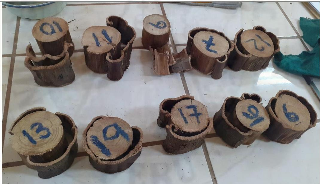
Fotografía 16: Las muestras de rollizos de eucalipto en estado inicial verde, estado húmedo y estado seco al aire. Se sometió al horno para conocer el Contracción, hinchamiento y peso específico con respecto a la variación de humedad.
