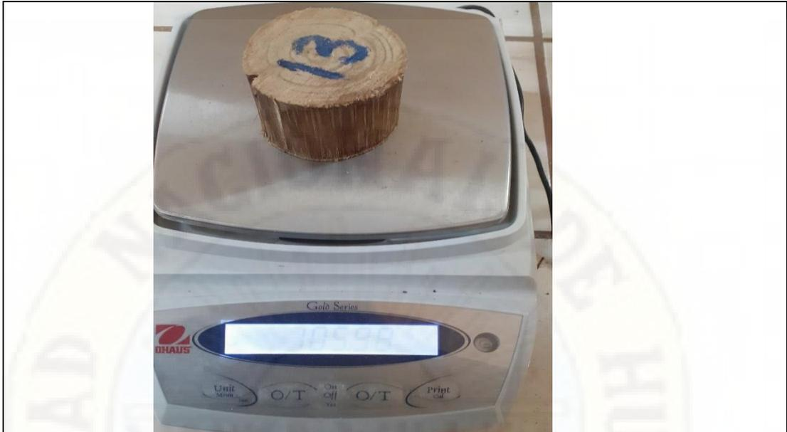
Fotografía 17: Obtenemos el peso específico para cada muestra, peso de la muestra entre volumen de la muestra de una altura promedio de 14cm.
