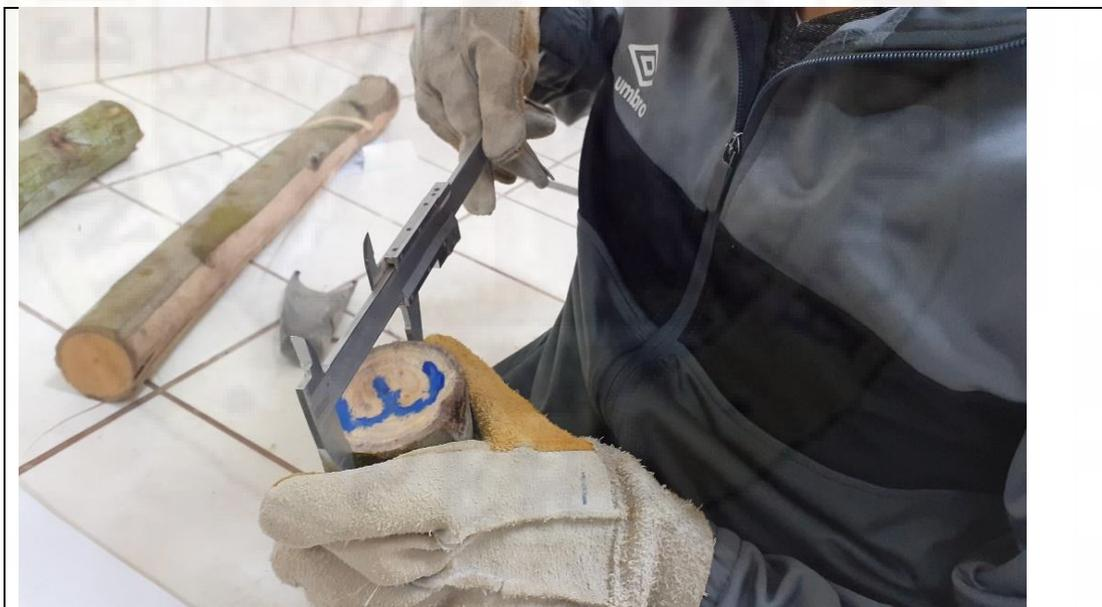
Fotografía 6: Medición de diámetros en pulgadas de rollizos de eucalipto en estado inicial verde, estado húmedo y estado seco al aire, haciendo uso de herramienta de vernier.
