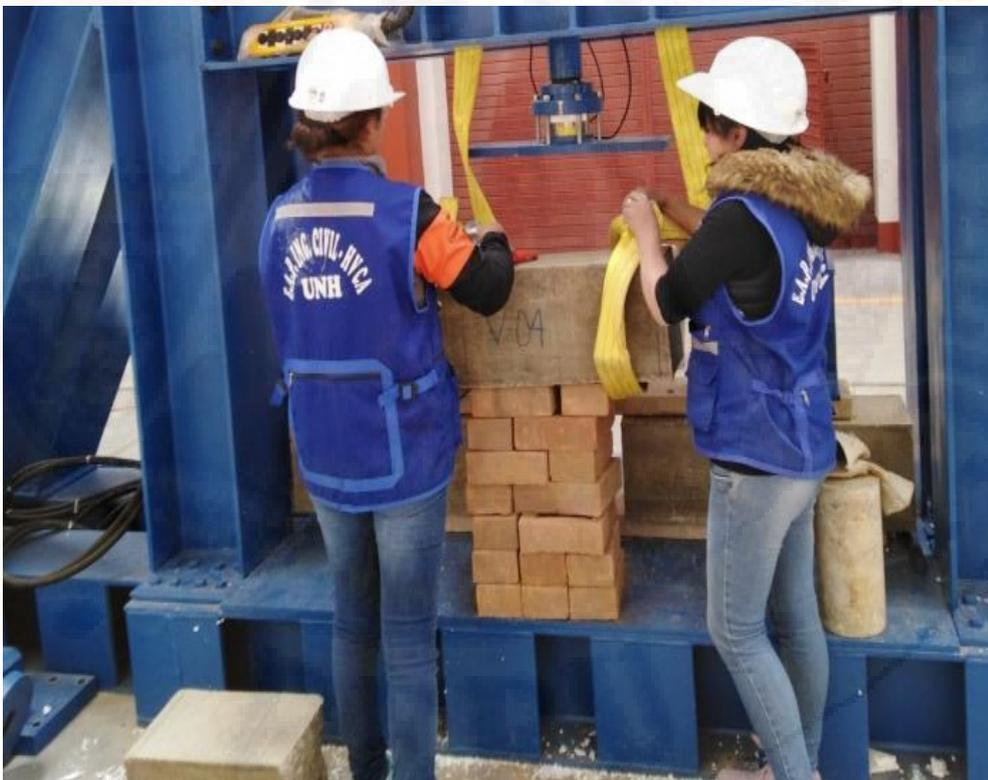
**Fotografía 6:** Ensayo de flexión de vigas.
