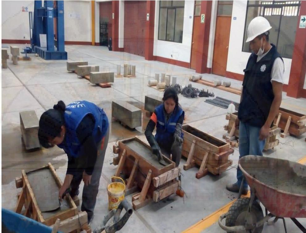
**Fotografía 3:** Vaciado de vigas de concreto.
