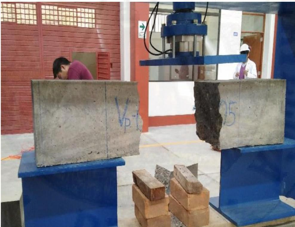
**Fotografía 10:** Rotura de viga 05 elaborado con piedra chancada
