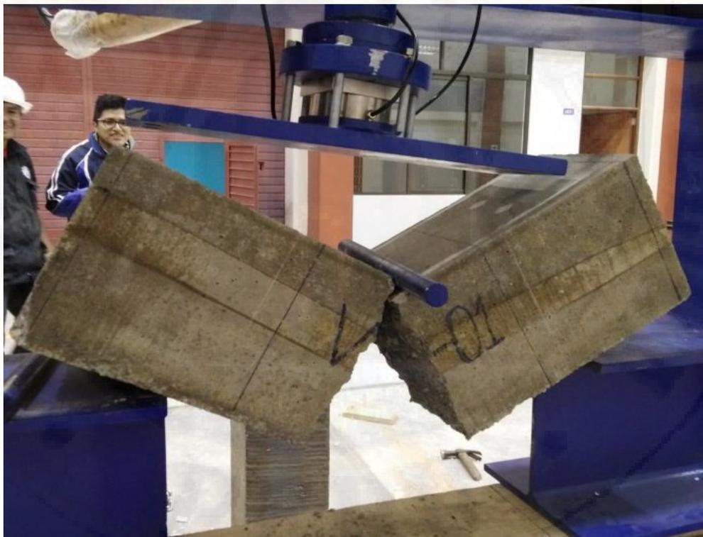
**Fotografía 8:** Rotura de viga 01 elaborado con canto rodado
