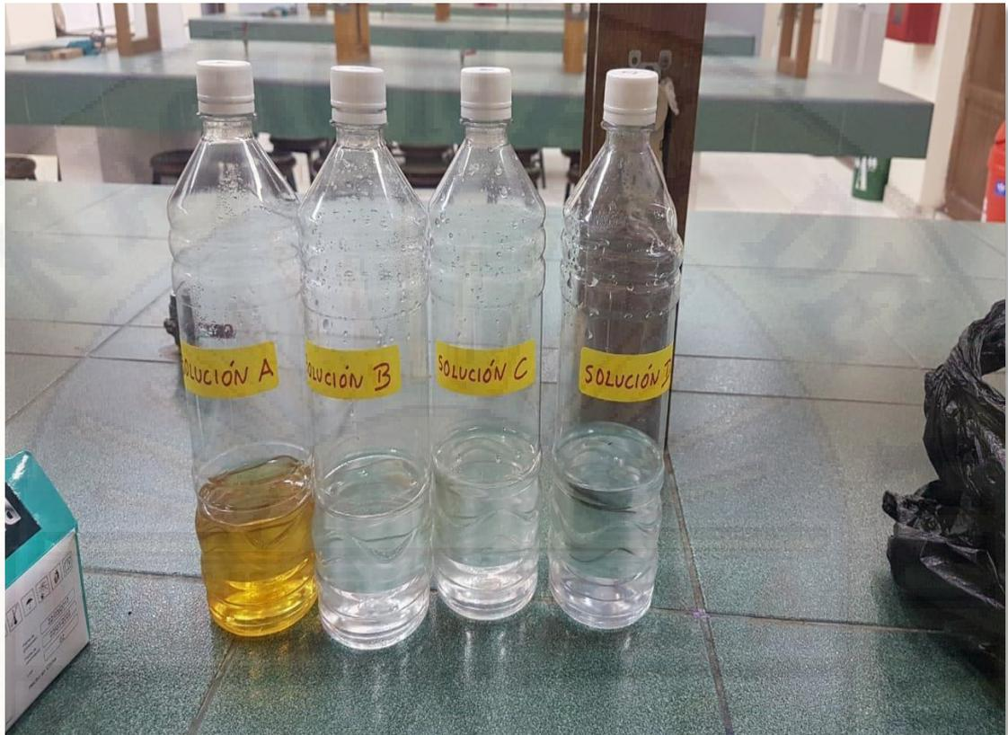
Fotografía 43. Adición de nutrientes para el análisis de la demanda bioquímica de oxígeno ( $\text{DBO}_5$ ) del agua residual doméstica.
