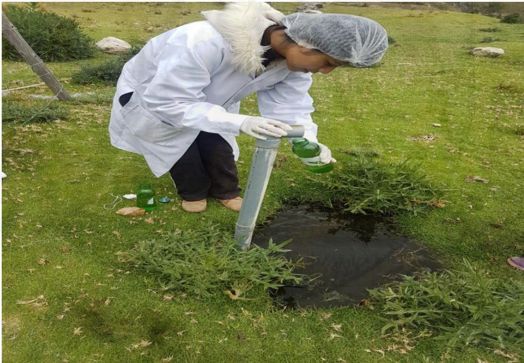
Fotografía 42. Muestreo del efluente proveniente del lombrifiltro.
