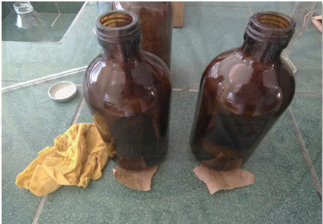
Fotografía 44. Frascos de color ámbar donde se llena la muestra a 90 ml para el análisis de  $\text{DBO}_5$ .
