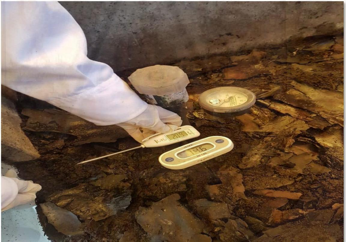
Fotografía 36. Toma de datos de campo de temperatura y humedad en el Lombrifiltro.
