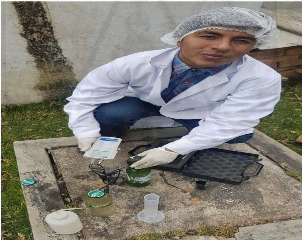
Fotografía 40. Medición del pH del agua residual del efluente y afluente.
