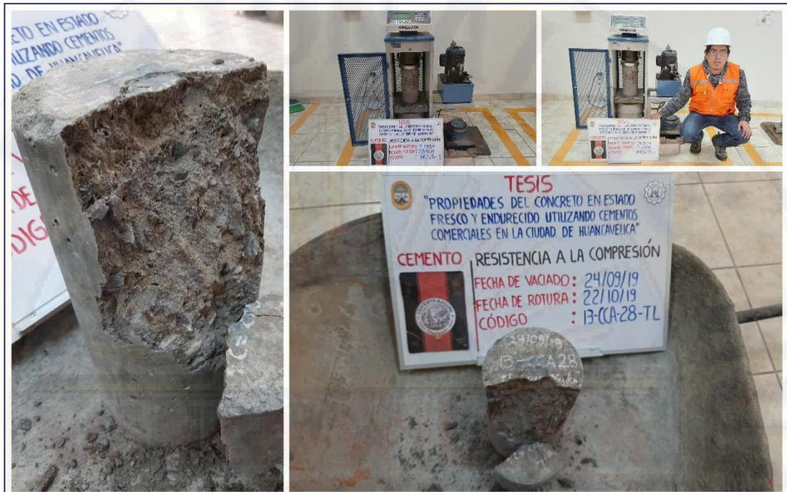
Figura A-33. Ensayo de resistencia a la compresión del concreto (muestra 13-CCA-28-TL), del cemento Andino tipo I a la edad de 28 días.
