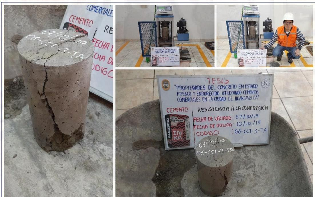
Figura A-42. Ensayo de resistencia a la compresión del concreto (muestra 06-CCI-3-TA), del cemento Inka tipo ICo a la edad de 3 días.
