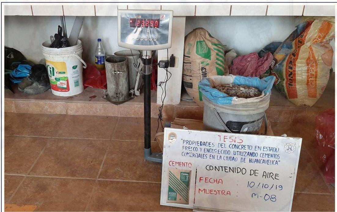
Figura A-24. Medición de pesos para el ensayo de contenido de aire del concreto (método gravimétrico) utilizando cemento Nacional tipo I.
