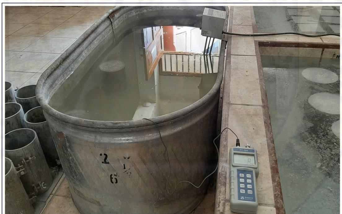
Figura A-26. Medición de temperatura para el curado de especímenes de concreto, curado en laboratorio.
