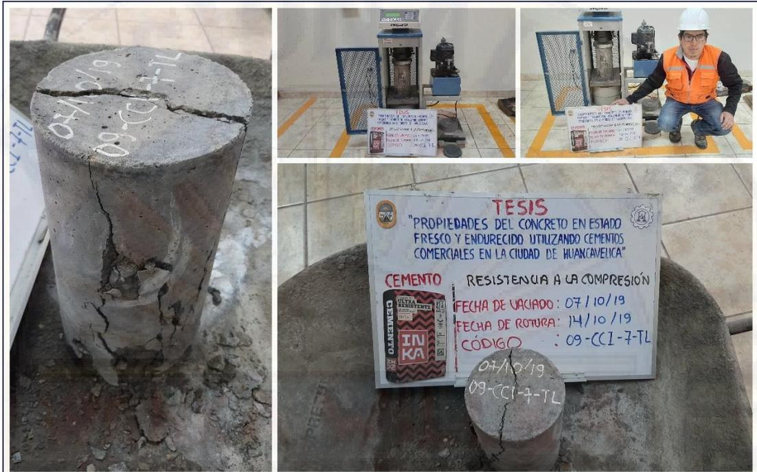
Figura A-43. Ensayo de resistencia a la compresión del concreto (muestra 09-CCI-7-TL), del cemento Inka tipo ICo a la edad de 7 días.
