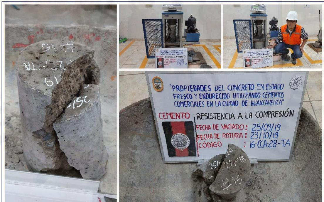
Figura A-34. Ensayo de resistencia a la compresión del concreto (muestra 16-CCA-28-TA), del cemento Andino tipo I a la edad de 28 días.
