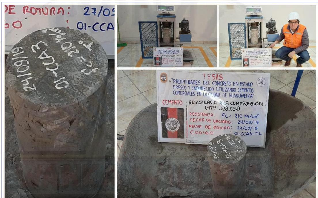
Figura A-29. Ensayo de resistencia a la compresión del concreto (muestra 01-CCA-3-TL), utilizando cemento Andino tipo I a la edad de 3 días.
