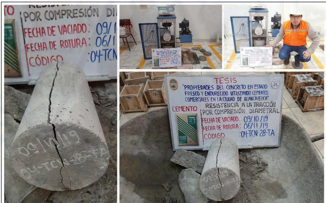
Figura A-60. Ensayo de resistencia a la tracción por compresión diametral del concreto (muestra 04-TCN-28-TA), del cemento Nacional tipo I.
