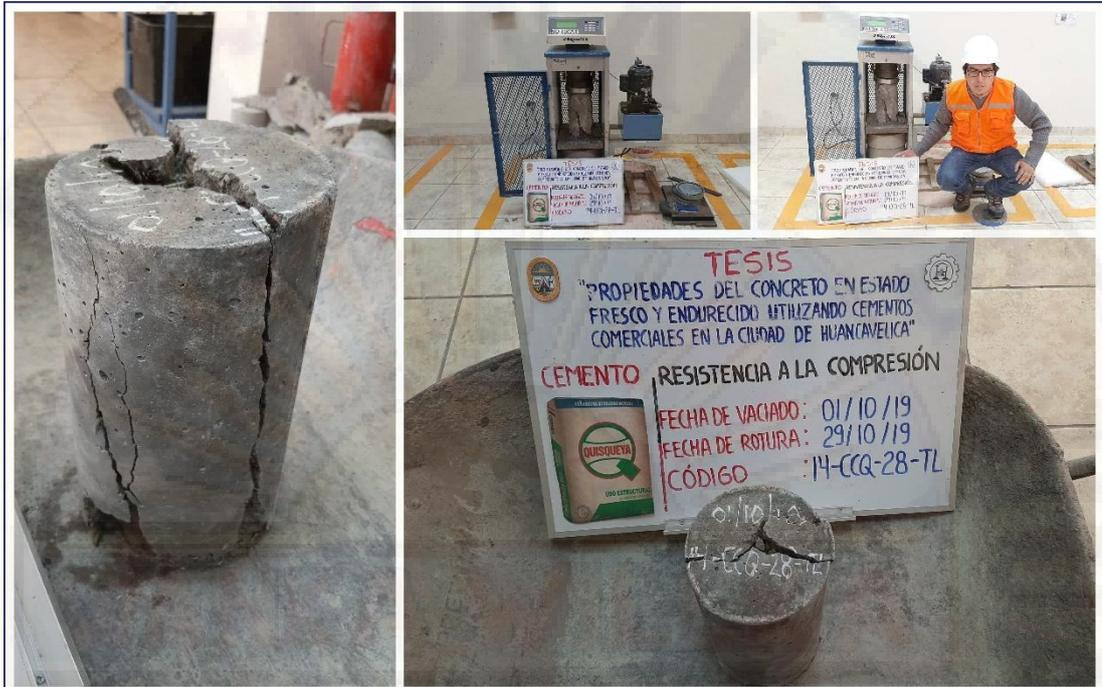
Figura A-39. Ensayo de resistencia a la compresión del concreto (muestra 14-CCQ-28-TL), del cemento Quisqueya tipo I a la edad de 28 días.
