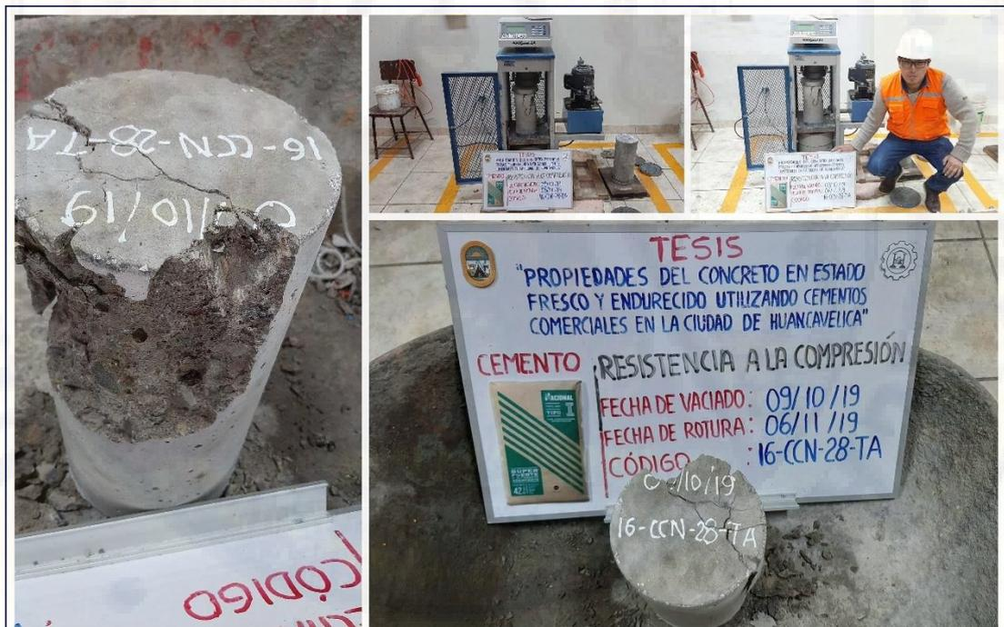
Figura A-52. Ensayo de resistencia a la compresión del concreto (muestra 16-CCN-28-TA), del cemento Nacional tipo I a la edad de 28 días.
