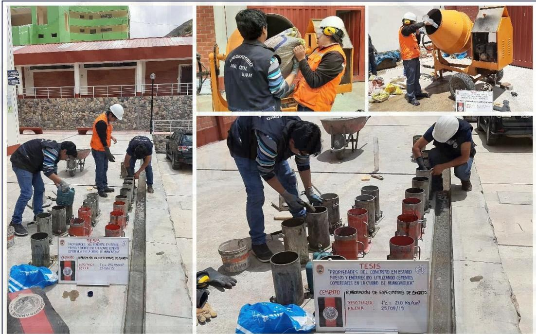
Figura A-05. Elaboración de muestras y especímenes de concreto utilizando cemento Andino tipo I.
