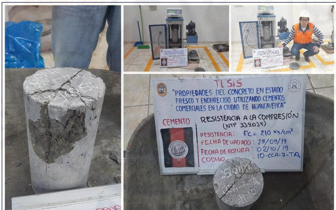
Figura A-32. Ensayo de resistencia a la compresión del concreto (muestra 10-CCA-7-TA), utilizando cemento Andino tipo I a la edad de 7 días.
