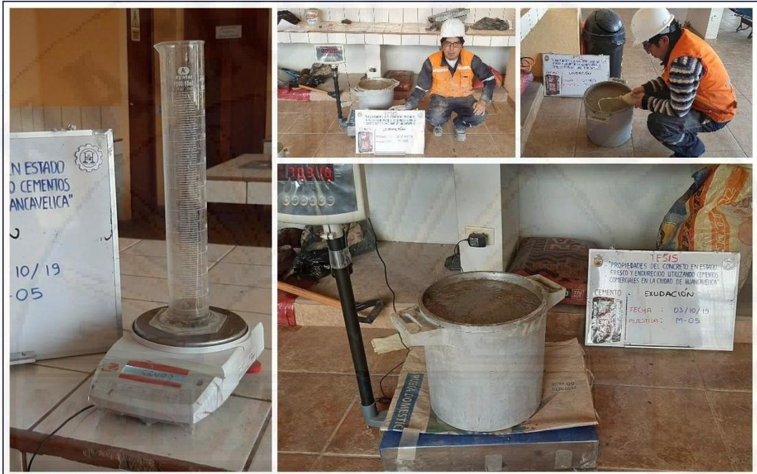
Figura A-19. Ensayo a la exudación del concreto utilizando cemento Inka tipo ICo.
