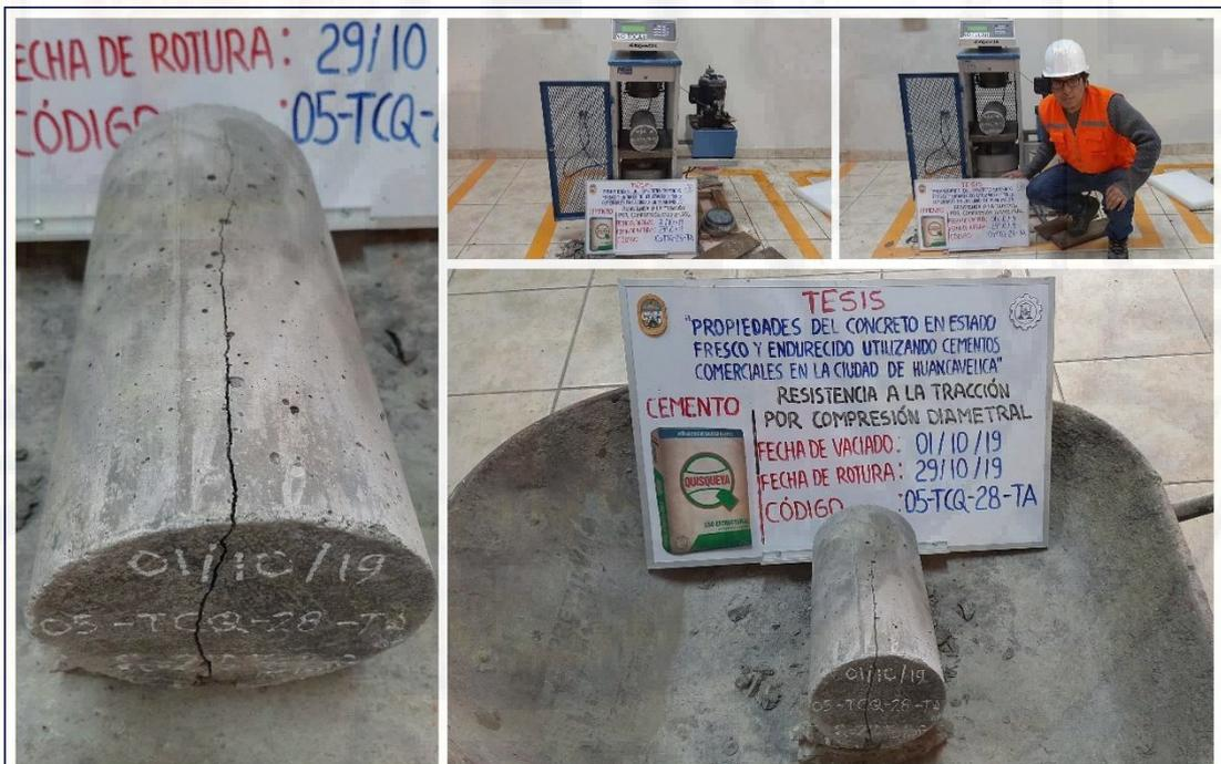
Figura A-56. Ensayo de Resistencia a la Tracción por Compresión Diametral del concreto (muestra 05-TCQ-28-TA), del Cemento Quisqueya Tipo I.
