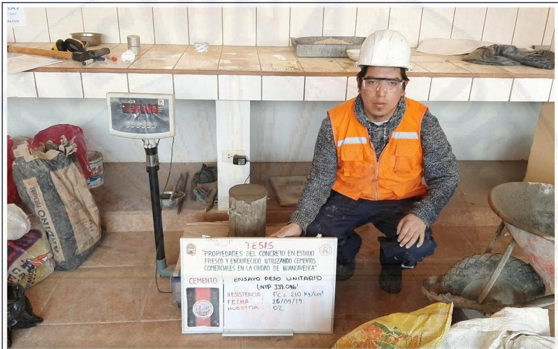
Figura A-13. Medición del peso del concreto utilizando cemento Andino tipo I, para determinar el peso unitario del concreto.
