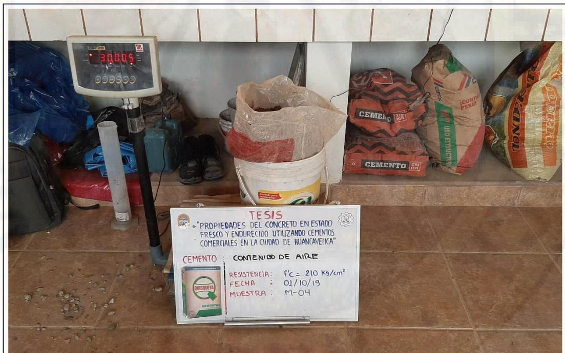
Figura A-22. Medición de pesos para el ensayo de contenido de aire del concreto (método gravimétrico) utilizando cemento Quisqueya tipo I.
