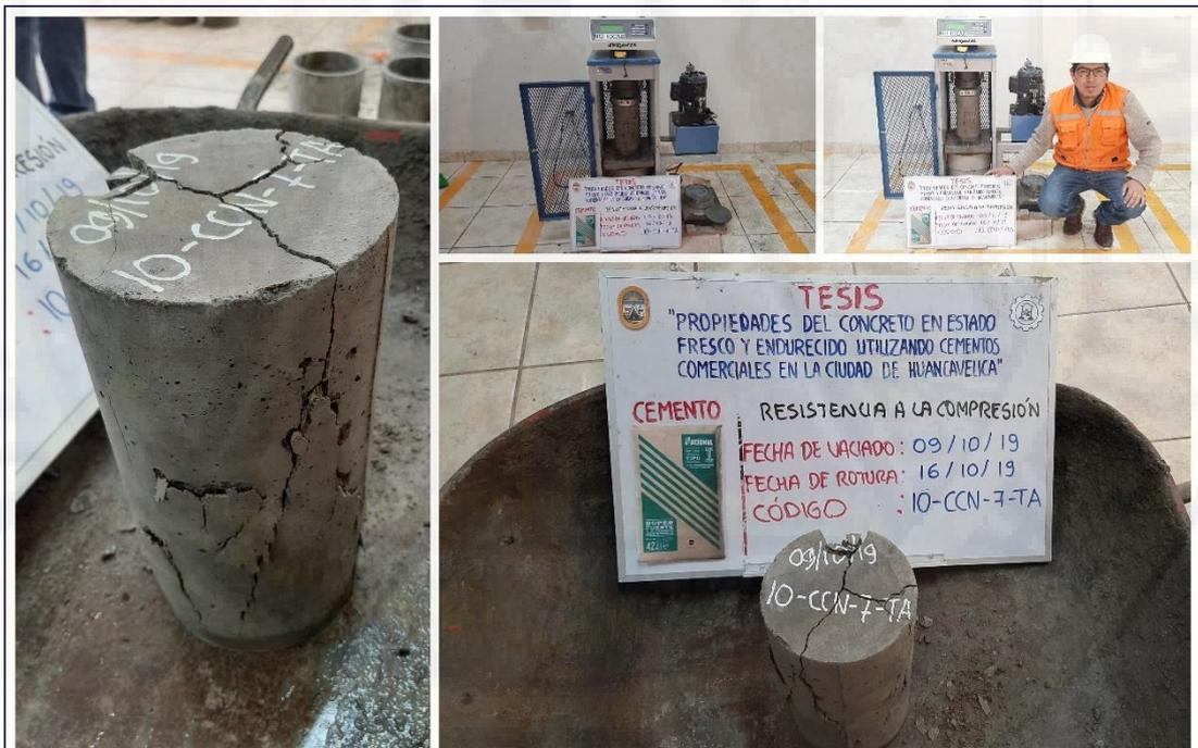
Figura A-50. Ensayo de resistencia a la compresión del concreto (muestra 10-CCN-7-TA), del cemento Nacional tipo I a la edad de 7 días.
