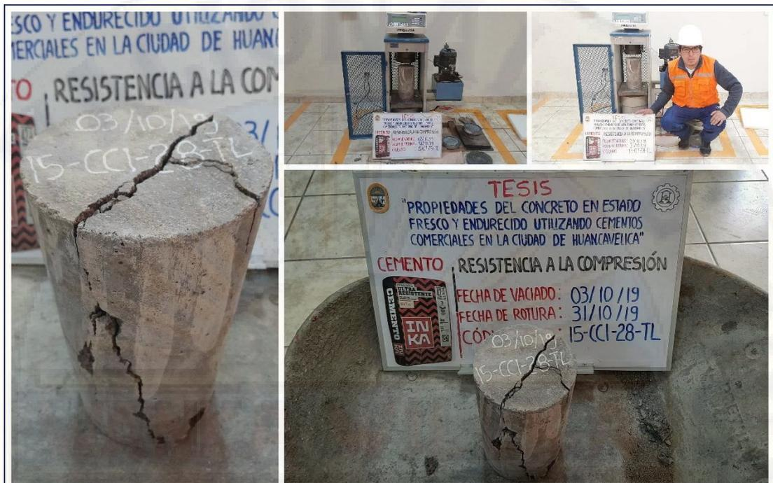
Figura A-45. Ensayo de resistencia a la compresión del concreto (muestra 15-CCI-28-TL), del cemento Inka tipo ICo a la edad de 28 días.
