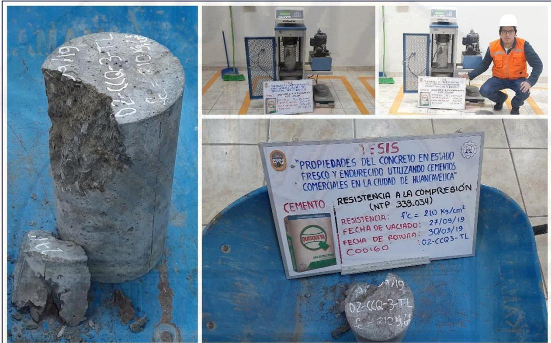
Figura A-35. Ensayo de resistencia a la compresión del concreto (muestra 02-CCQ-3-TL), del cemento Quisqueya tipo I a la edad de 3 días.
