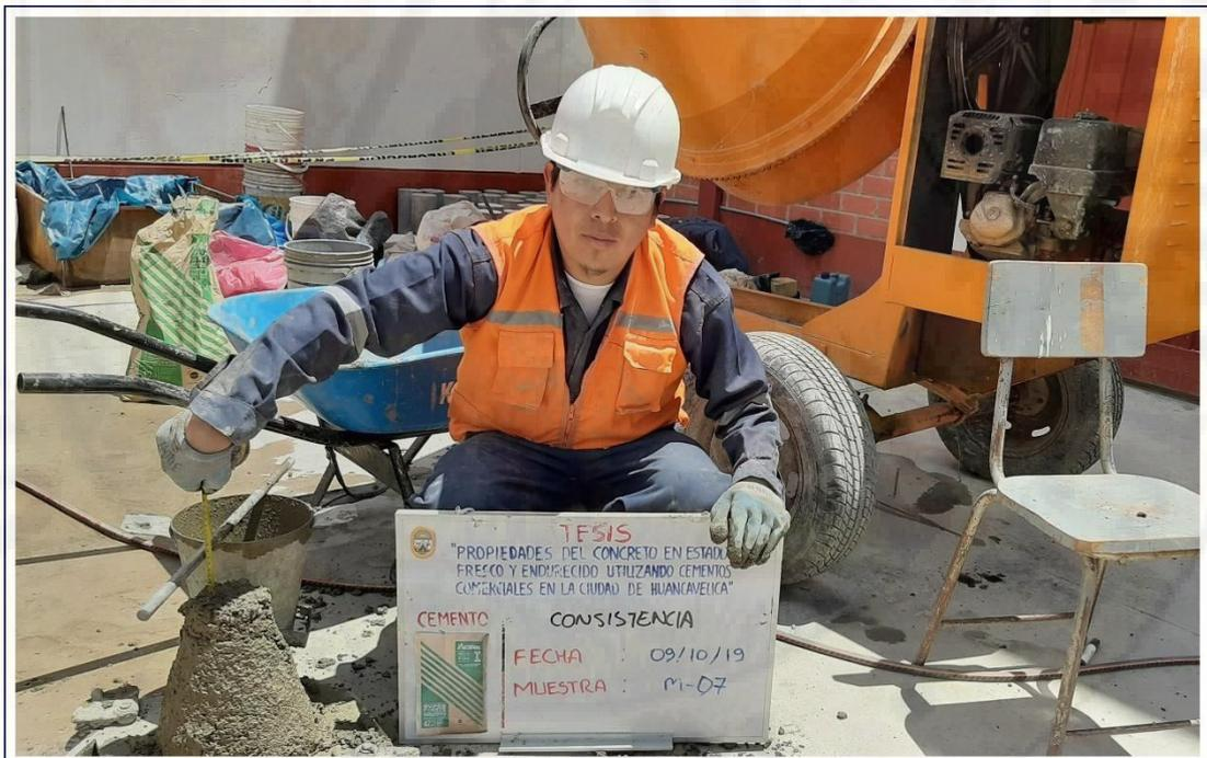
Figura A-12. Asentamiento del concreto utilizando cemento Nacional tipo I.
