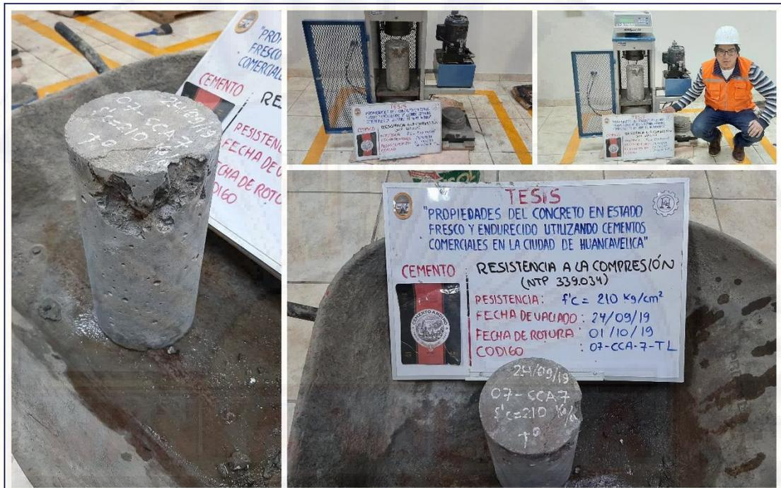
Figura A-31. Ensayo de resistencia a la compresión del concreto (muestra 07-CCA-7-TL), utilizando cemento Andino tipo I a la edad de 7 días.
