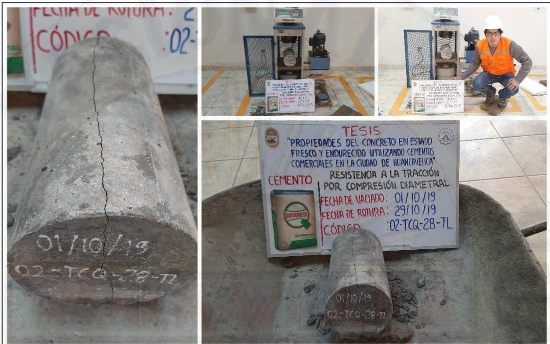
Figura A-55. Ensayo de resistencia a la tracción por compresión diametral del concreto (muestra 02-TCQ-28-TL), del cemento Quisqueya tipo I.
