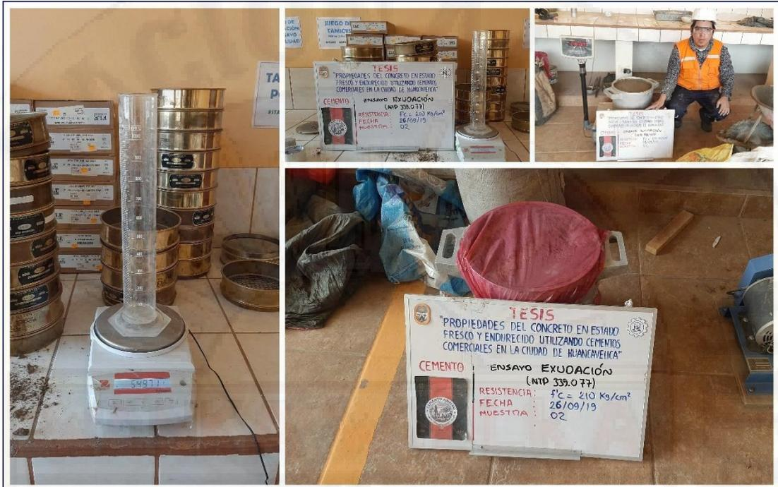
Figura A-17. Ensayo a la exudación del concreto utilizando cemento Andino tipo I.
