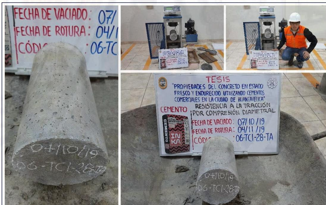
Figura A-58. Ensayo de resistencia a la tracción por compresión diametral del concreto (muestra 06-TCI-28-TA), del cemento Inka tipo ICo.
