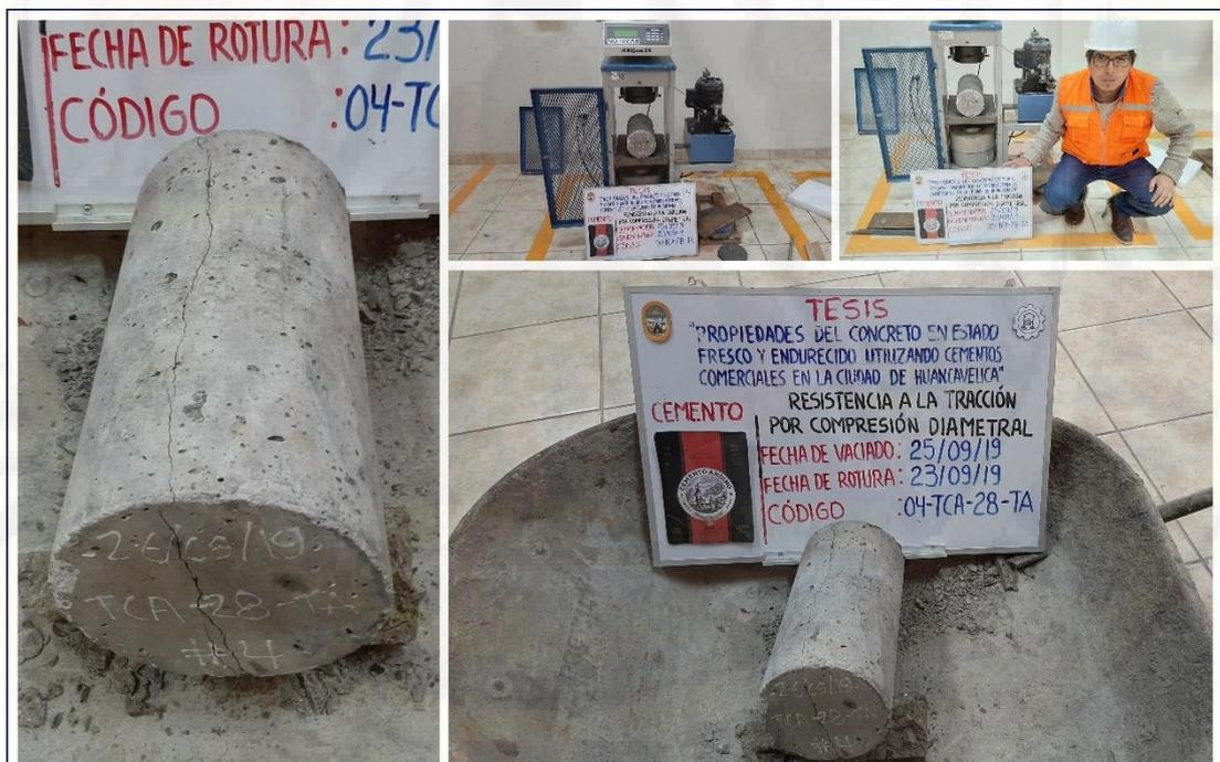
Figura A-54. Se observa el ensayo de resistencia a la tracción por compresión diametral del concreto (muestra 04-TCA-28-TA), del cemento Andino tipo I.
