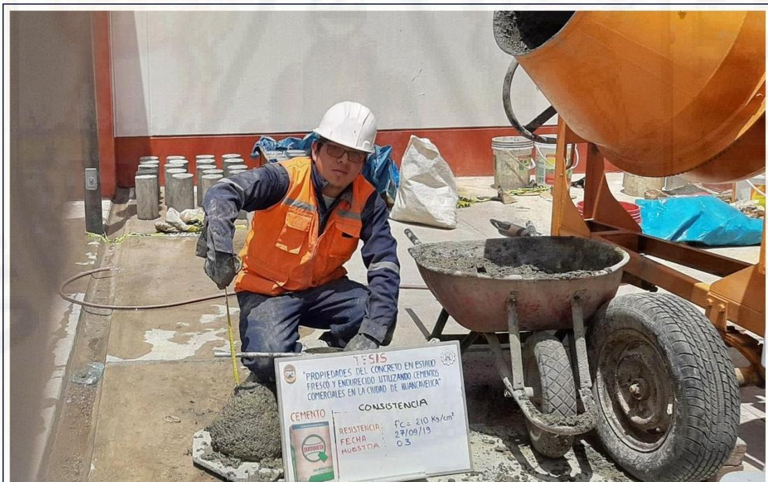
Figura A-10. Asentamiento del concreto utilizando cemento Quisqueya tipo I.
