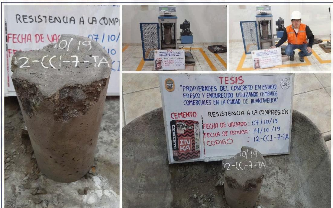
Figura A-44. Ensayo de resistencia a la compresión del concreto (muestra 12-CCI-7-TA), del cemento Inka tipo ICo a la edad de 7 días.
