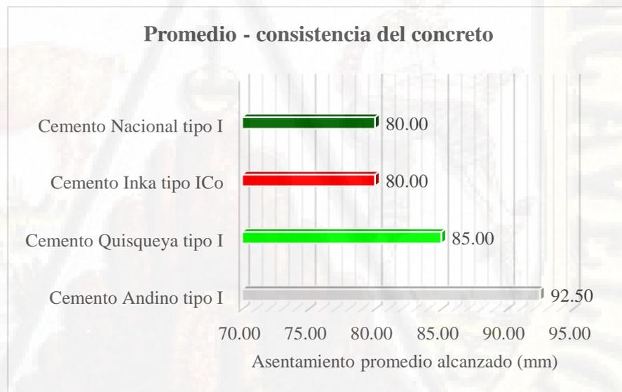
Figura 10. Promedio – consistencia del concreto de diferentes cementos.
