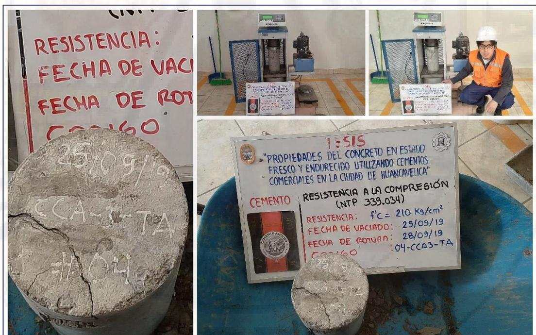
Figura A-30. Ensayo de resistencia a la compresión del concreto (muestra 04-CCA-3-TA), utilizando cemento Andino tipo I a la edad de 3 días.
