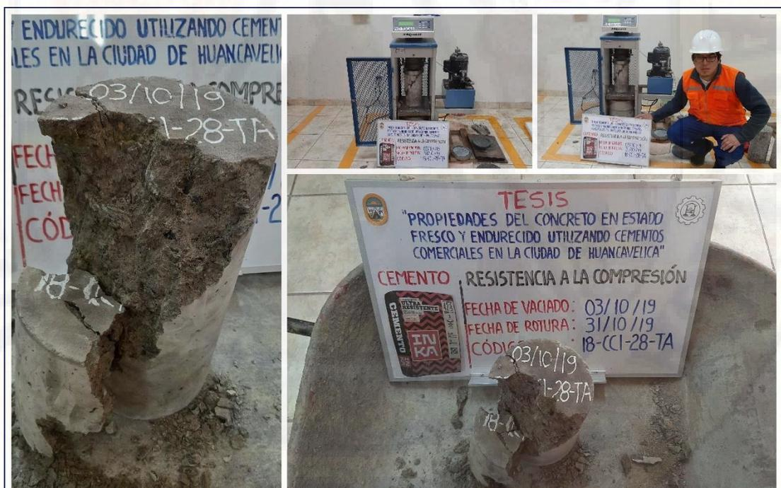
Figura A-46. Ensayo de resistencia a la compresión del concreto (muestra 18-CCI-28-TA), del cemento Inka tipo ICo a la edad de 28 días.
