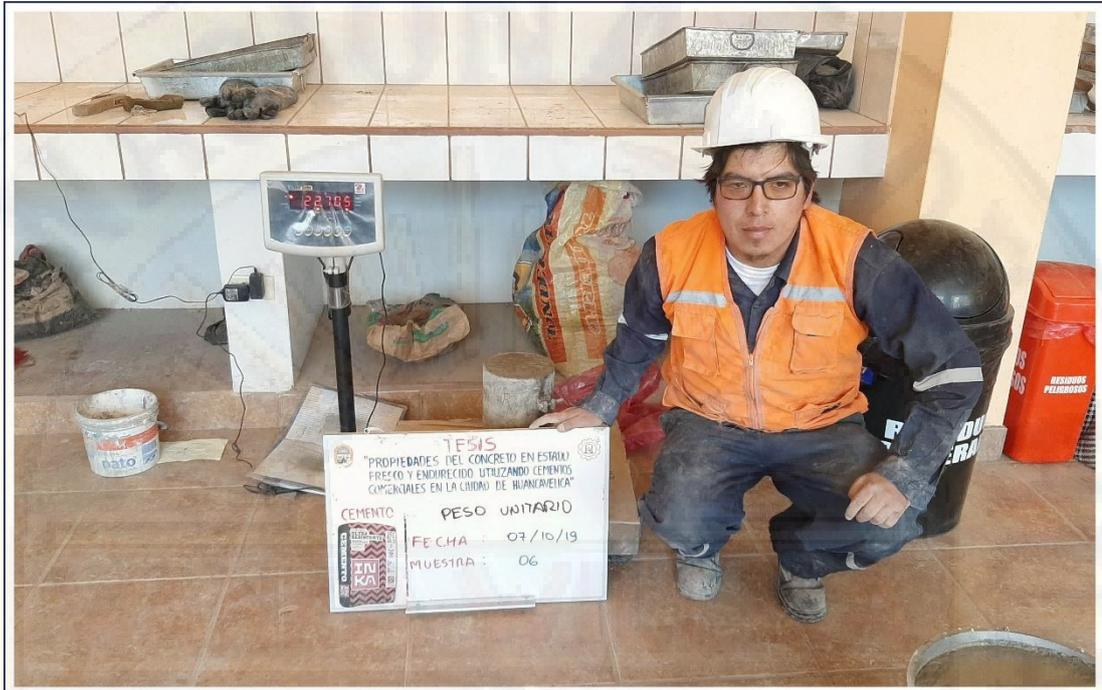
Figura A-15. Medición del peso del concreto utilizando cemento Inka tipo IC<sub>0</sub>, para determinar el peso unitario del concreto.
