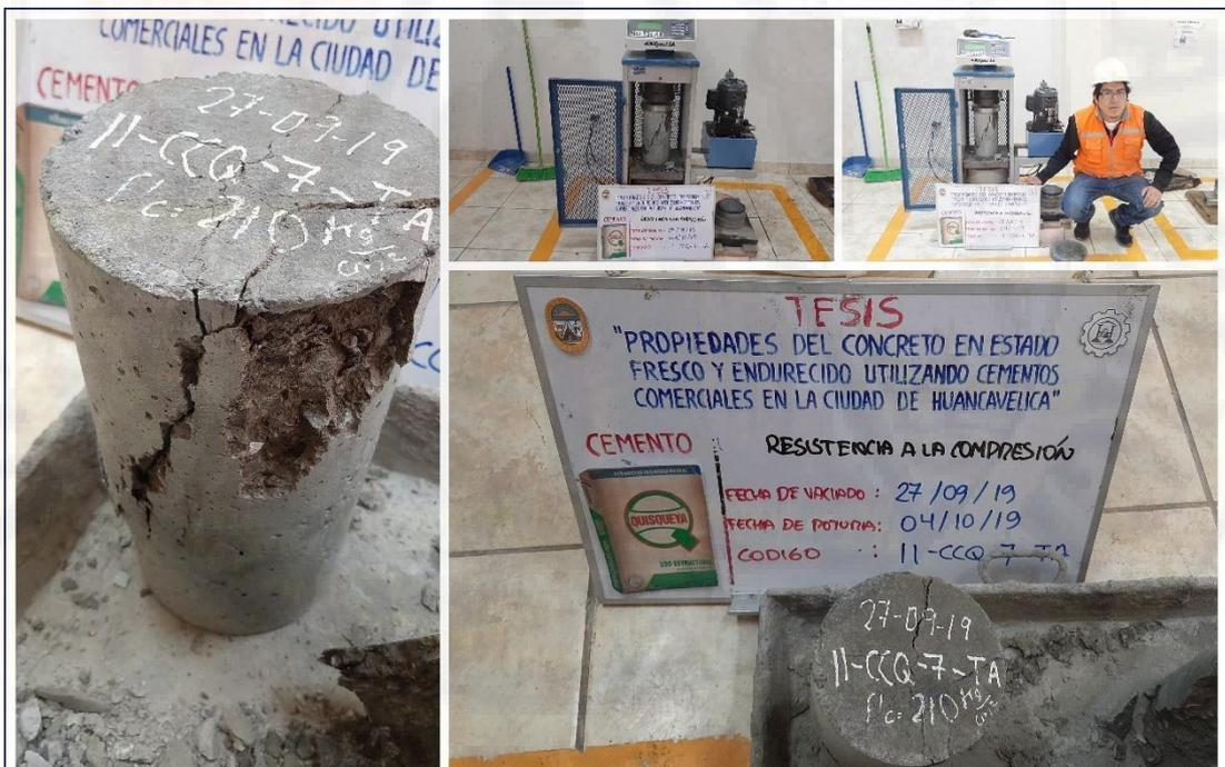
Figura A-38. Ensayo de resistencia a la compresión del concreto (muestra 11-CCQ-7-TA), del cemento Quisqueya tipo I a la edad de 7 días.
