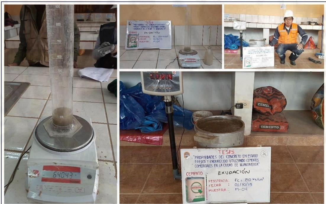
Figura A-18. Ensayo a la exudación del concreto utilizando cemento Quisqueya tipo I.
