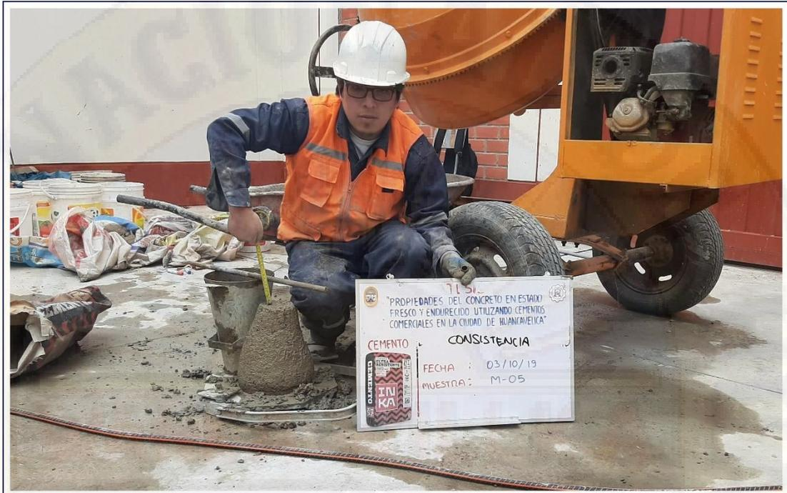
Figura A-11. Asentamiento del concreto utilizando cemento Inka tipo ICo.
