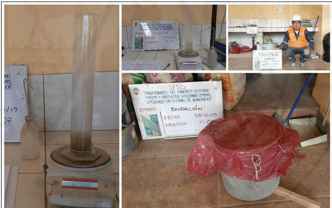
Figura A-20. Ensayo a la exudación del concreto utilizando cemento Nacional tipo I.
