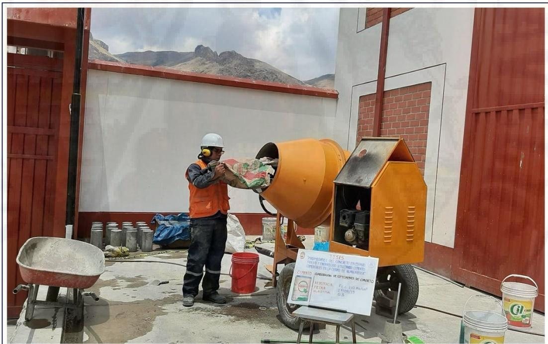
Figura A-06. Elaboración de muestras y especímenes de concreto utilizando cemento Quisqueya tipo I.
