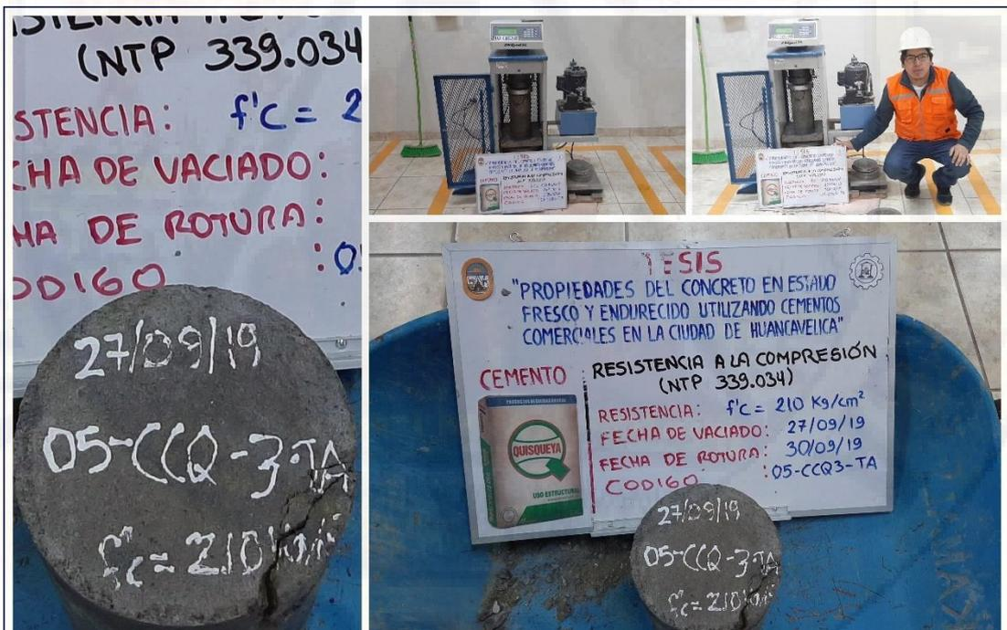
Figura A-36. Ensayo de resistencia a la compresión del concreto (muestra 05-CCQ-3-TA), del cemento Quisqueya tipo I a la edad de 3 días.
