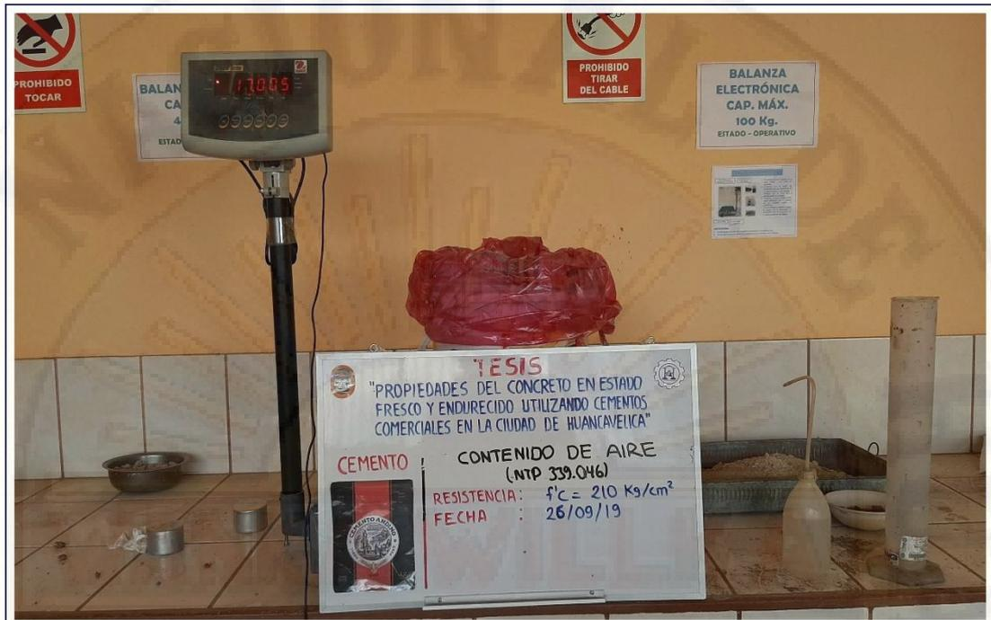
Figura A-21. Medición de pesos para el ensayo de contenido de aire del concreto (método gravimétrico) utilizando cemento Andino tipo I.
