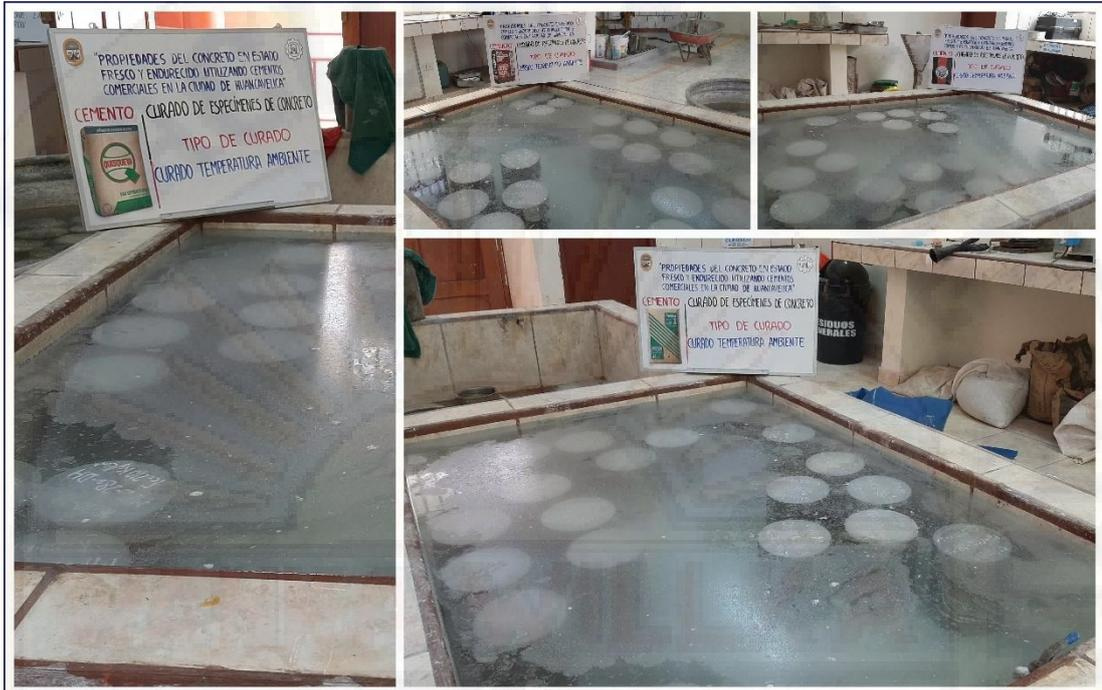
Figura A-27. Curado de especímenes de concreto, curado a T° ambiente.
