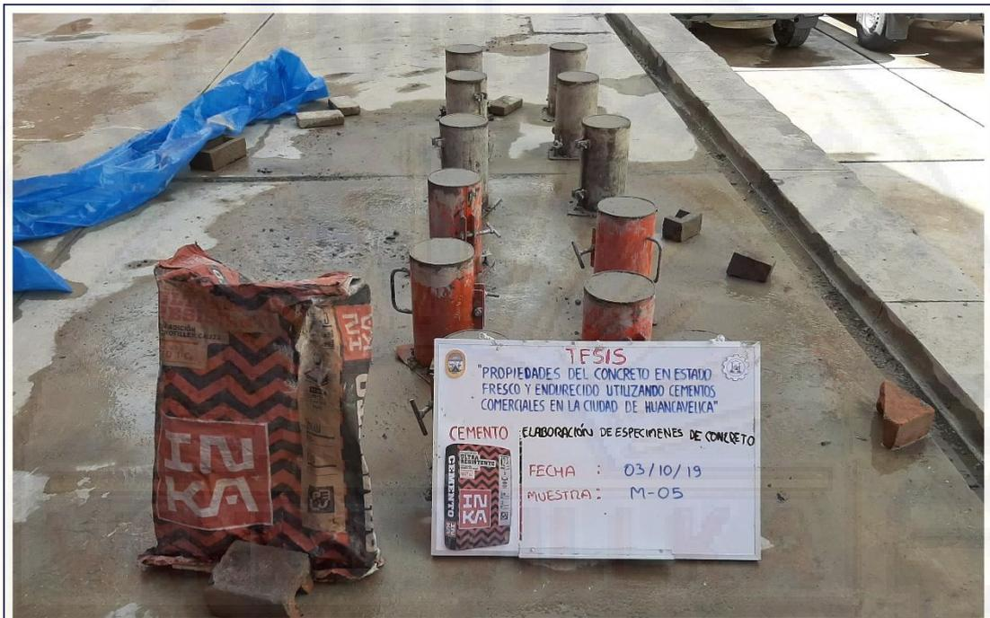
Figura A-07. Elaboración de muestras y especímenes de concreto utilizando cemento Inka tipo ICo.
