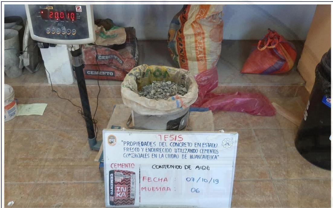
Figura A-23. Medición de pesos para el ensayo de contenido de aire del concreto (método gravimétrico) utilizando cemento Inka tipo ICo.
