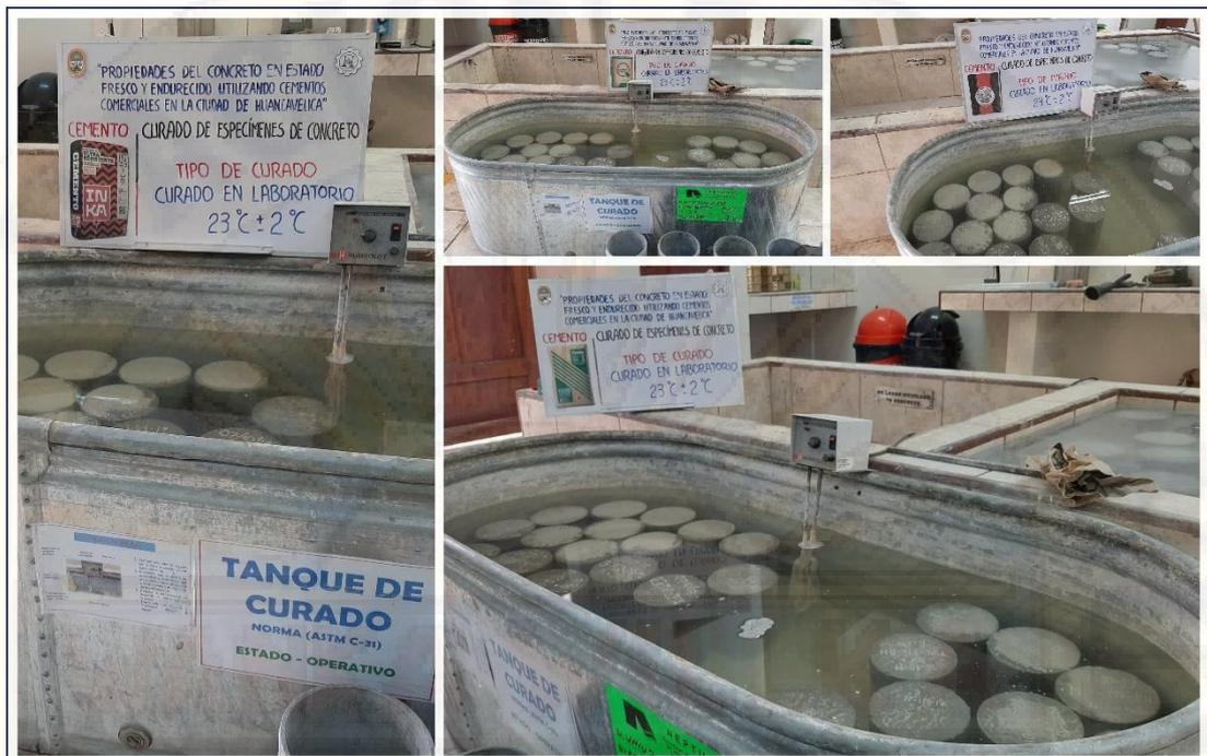
Figura A-25. Curado de especímenes de concreto, curado en laboratorio.
