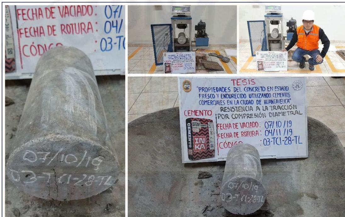
Figura A-57. Ensayo de resistencia a la tracción por compresión diametral del concreto (muestra 03-TCI-28-TL), del cemento Inka tipo ICo.
