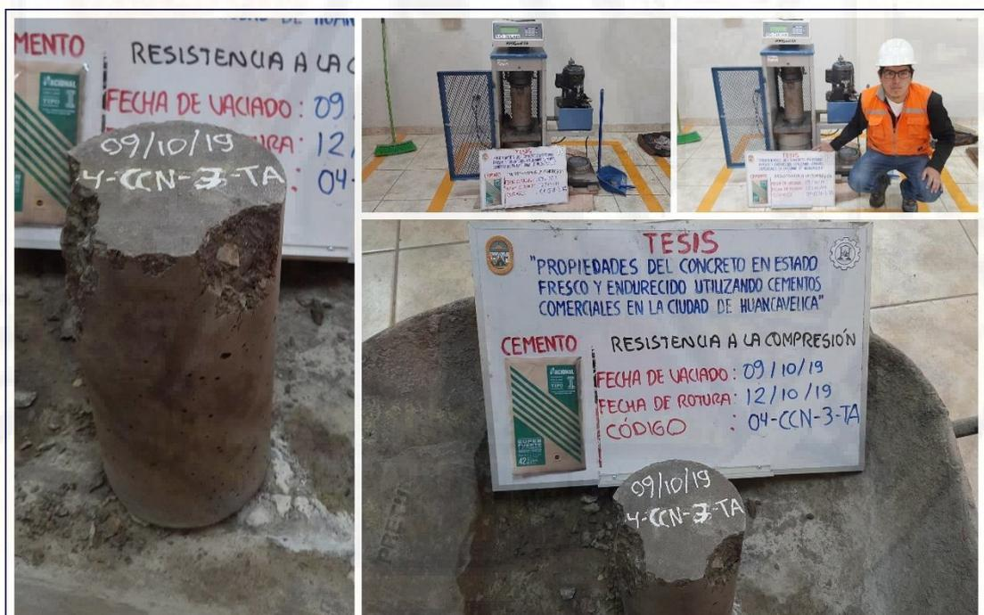
Figura A-48. Ensayo de resistencia a la compresión del concreto (muestra 04-CCN-3-TA), del cemento Nacional tipo I a la edad de 3 días.
