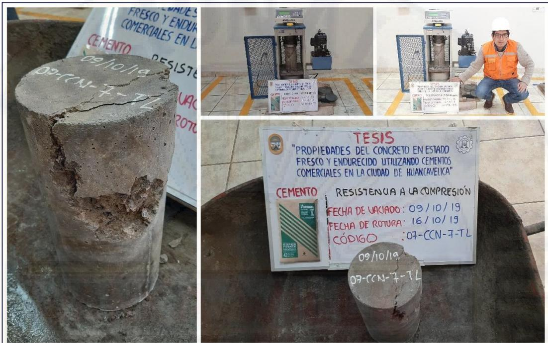
Figura A-49. Ensayo de resistencia a la compresión del concreto (muestra 07-CCN-7-TL), del cemento Nacional tipo I a la edad de 7 días.
