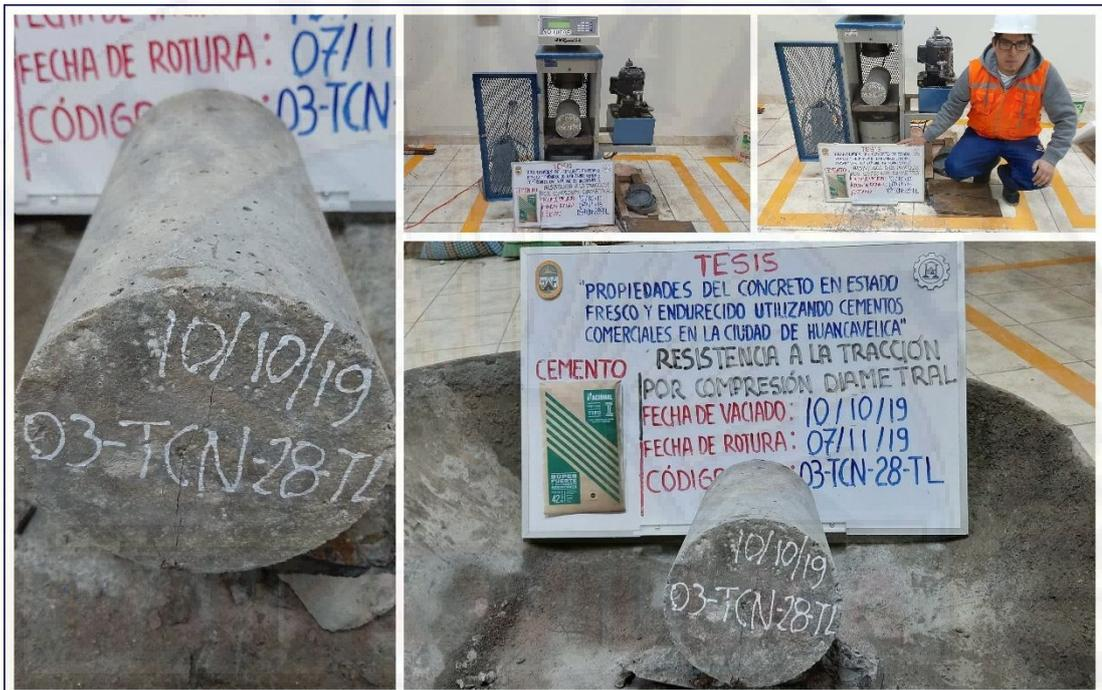
Figura A-59. Ensayo de resistencia a la tracción por compresión diametral del concreto (muestra 03-TCN-28-TL), del cemento Nacional tipo I.
