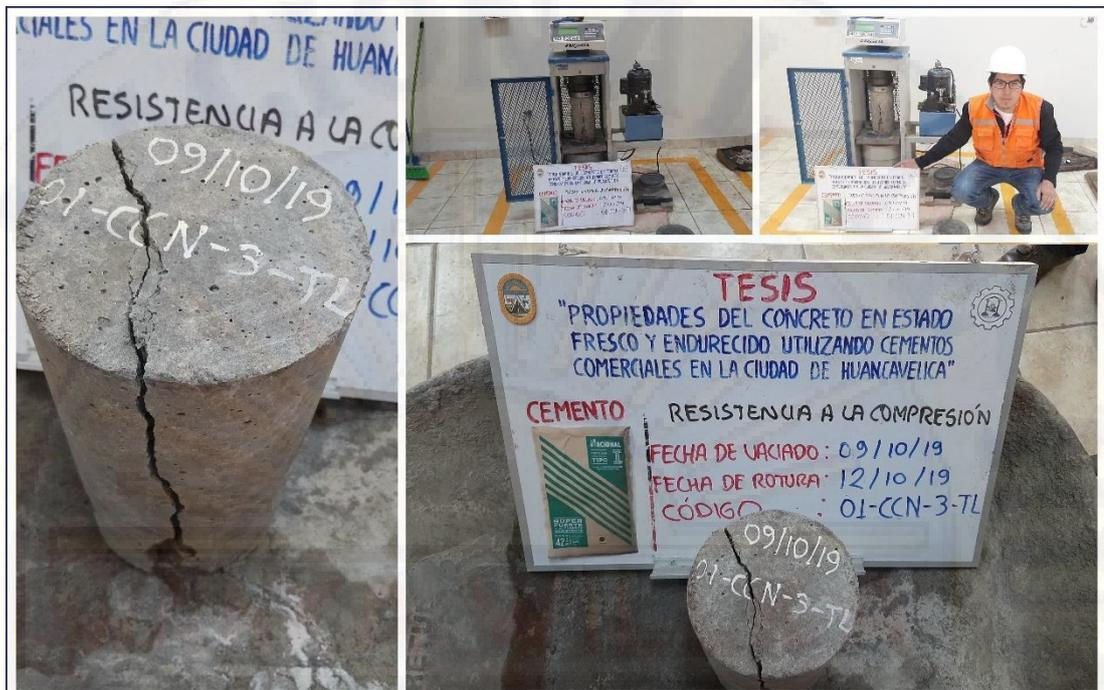
Figura A-47. Ensayo de resistencia a la compresión del concreto (muestra 01-CCN-3-TL), del cemento Nacional tipo I a la edad de 3 días.
