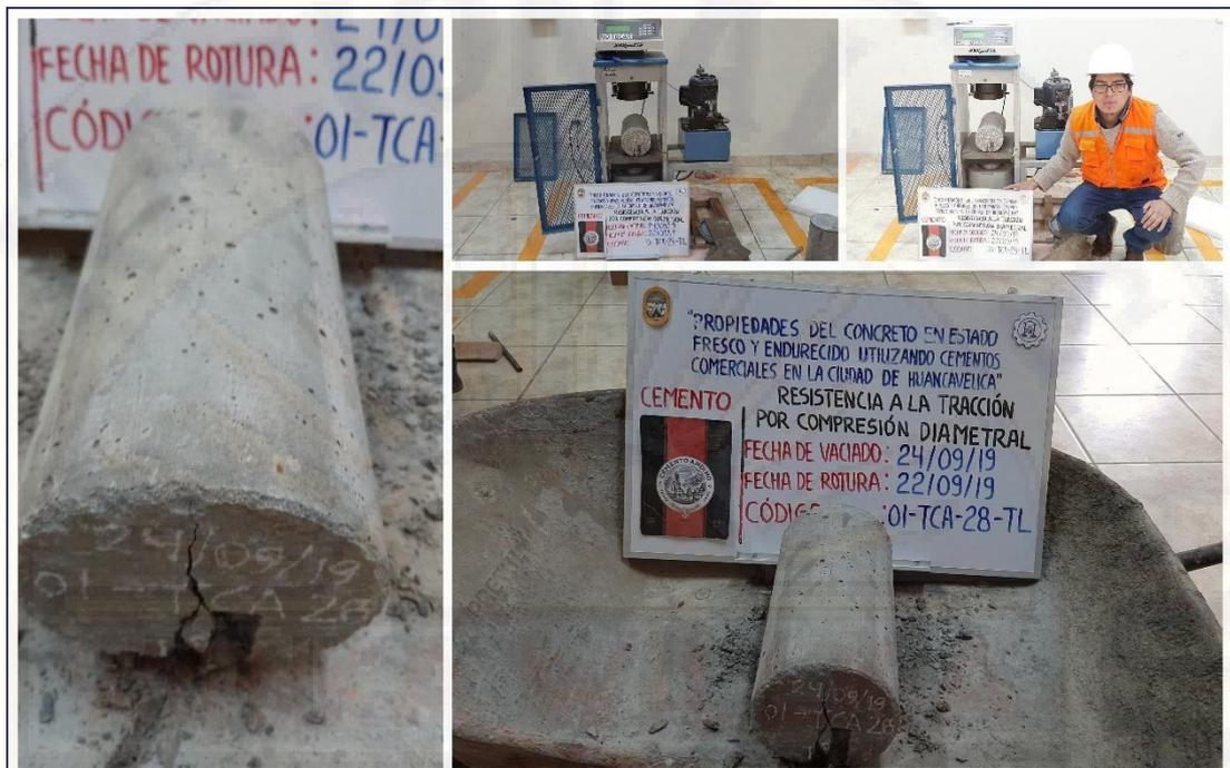
Figura A-53. Ensayo de resistencia a la tracción por compresión diametral del concreto (muestra 01-TCA-28-TL), del cemento Andino tipo I.
