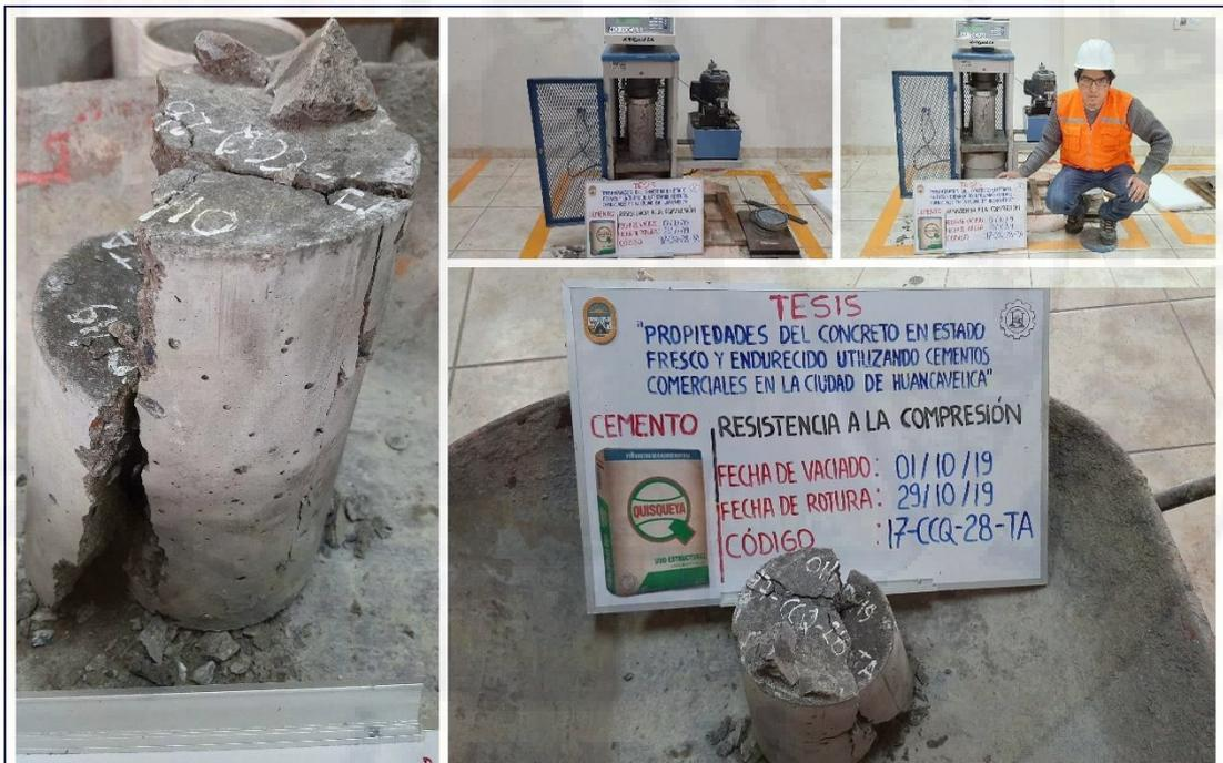
Figura A-40. Ensayo de resistencia a la compresión del concreto (muestra 17-CCQ-28-TA), del cemento Quisqueya tipo I a la edad de 28 días.
