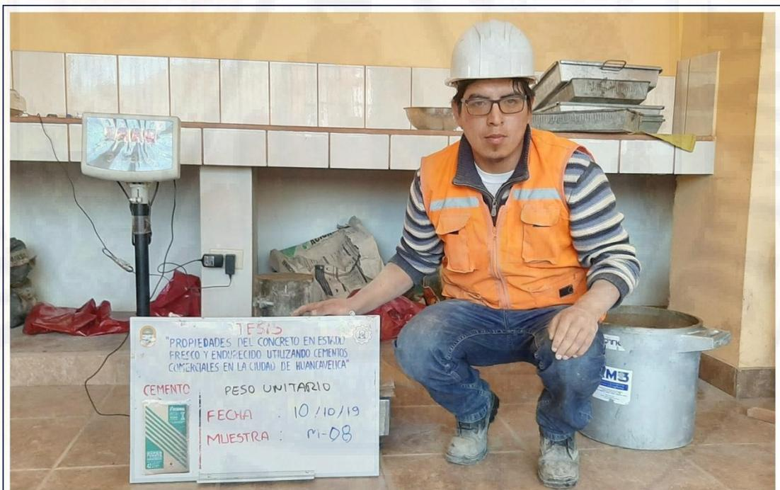
Figura A-16. Medición del peso del concreto utilizando cemento Nacional tipo I, para determinar el peso unitario del concreto.
