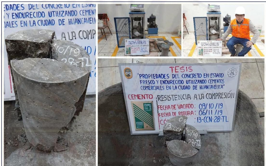
Figura A-51. Ensayo de resistencia a la compresión del concreto (muestra 13-CCN-28-TL), del cemento Nacional tipo I a la edad de 28 días.
