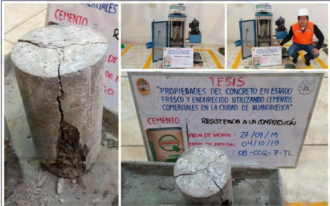
Figura A-37. Ensayo de resistencia a la compresión del concreto (muestra 08-CCQ-7-TL), del cemento Quisqueya tipo I a la edad de 7 días.
