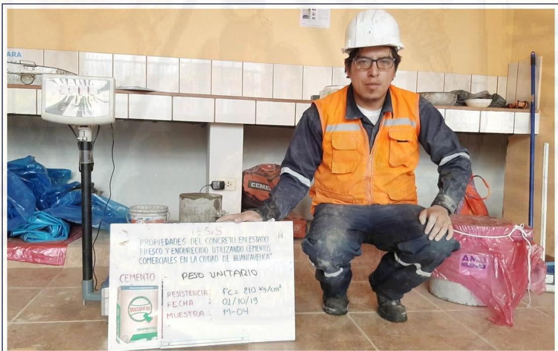
Figura A-14. Medición del peso del concreto utilizando cemento Quisqueya tipo I, para determinar el peso unitario del concreto.
