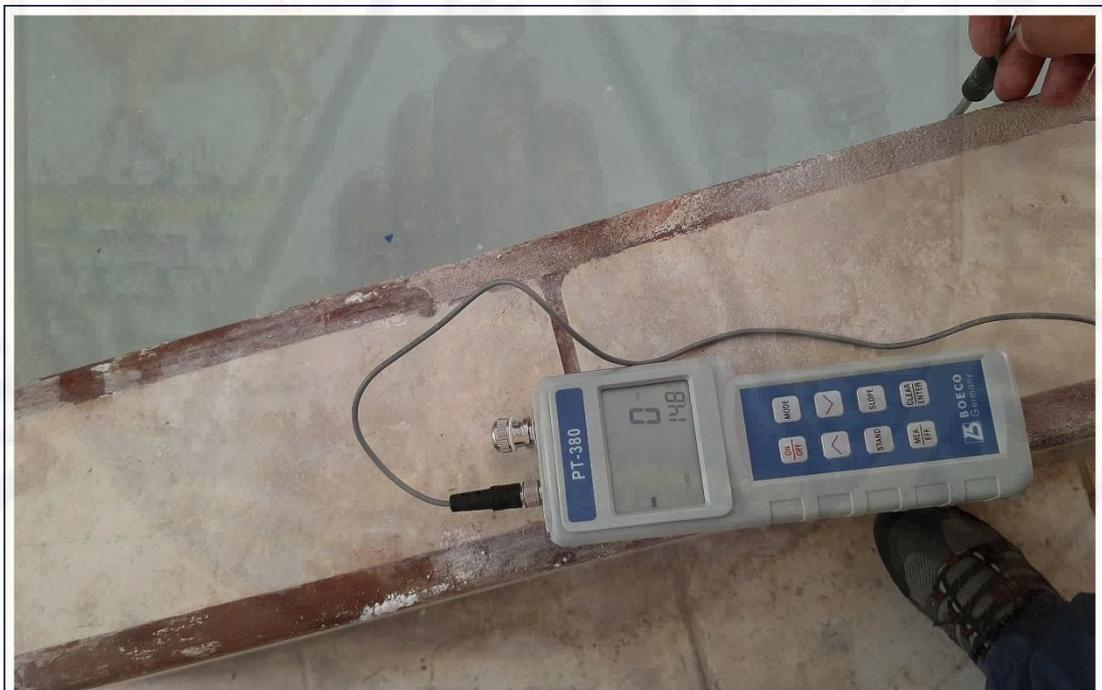
Figura A-28. Medición de temperatura para el curado de especímenes de concreto, curado a T° ambiente (14.8°C).
