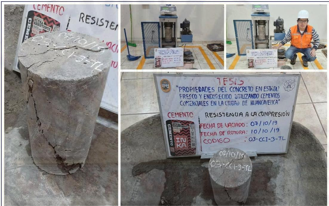
Figura A-41. Ensayo de resistencia a la compresión del concreto (muestra 03-CCI-3-TL), del cemento Inka tipo ICo a la edad de 3 días.
