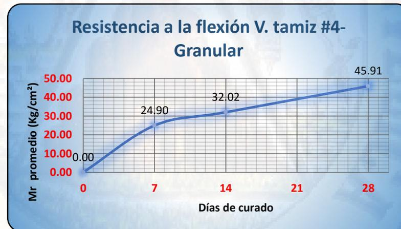
Figura 4.20 Curva Resistencia vs Tiempo – Flexión vidrio tamiz #4 – Granular
