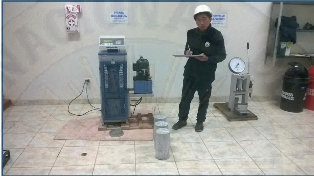
Ilustración 16: Ensayo de resistencia a la compresión (ASTM C-39)
