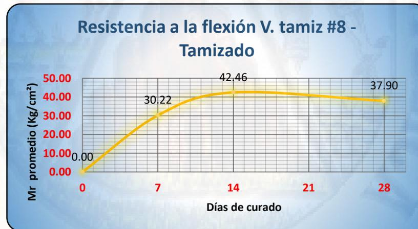
Figura 4.19 Curva Resistencia vs Tiempo – Flexión vidrio tamiz #8 - Tamizado
