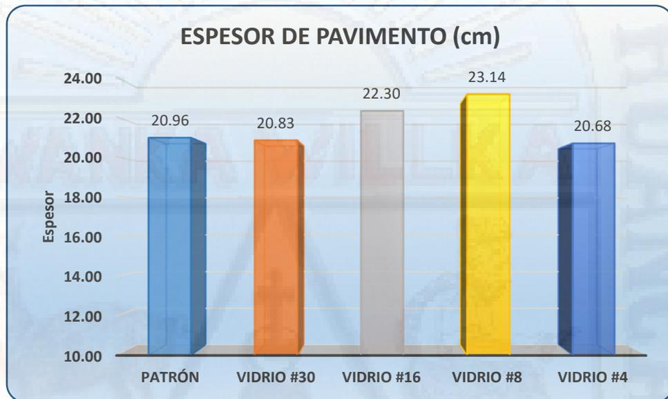
Figura 4.23 Espesor de pavimento de mezcla control vs mezcla experimental
