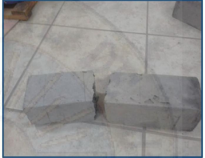
Ilustración 21: Probeta ya ensayada a flexión (ASTM C-78)
