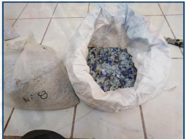
Ilustración 3: Vidrio tamiz #4 (granular)
