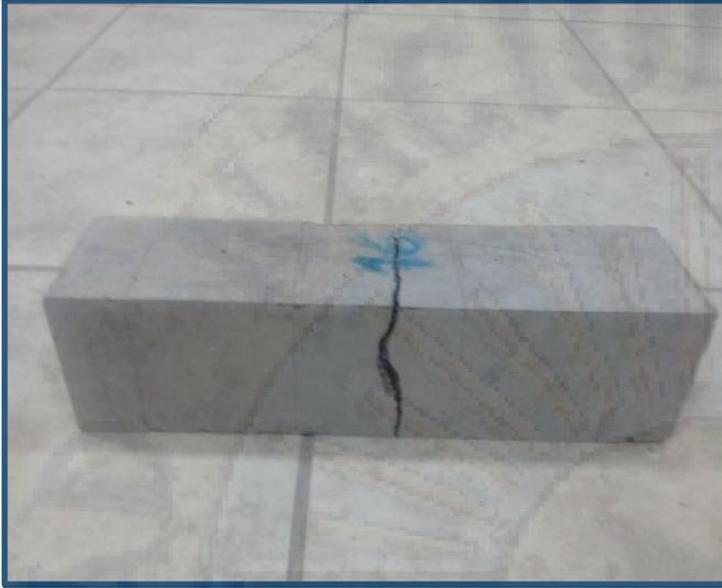
Ilustración 20: Probeta ya ensayada a flexión (ASTM C-78)
