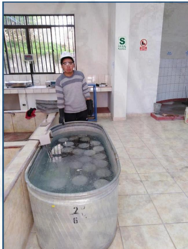
Ilustración 15: Curado de probetas (ASTM C-31)
