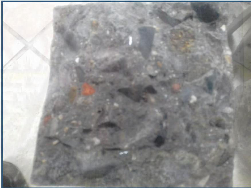
Ilustración 22: Observación de vidrio triturado en viga ensayada
