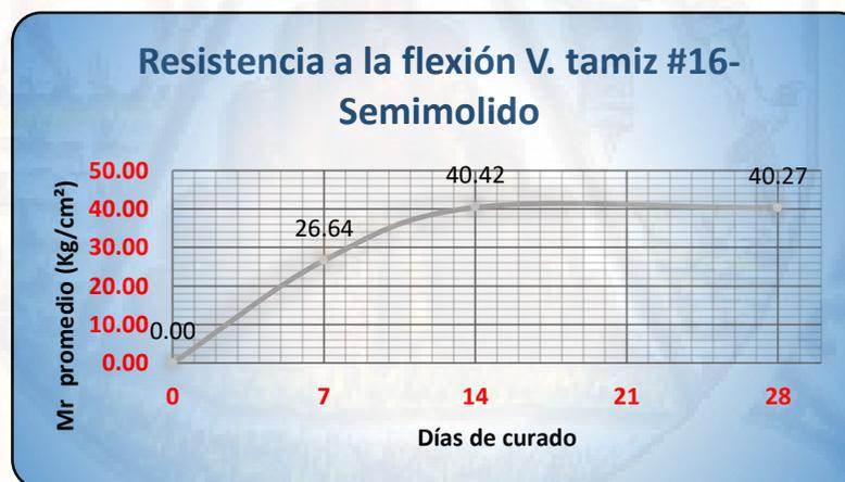
Figura 4.18 Curva Resistencia vs Tiempo – Flexión vidrio Semimolido
