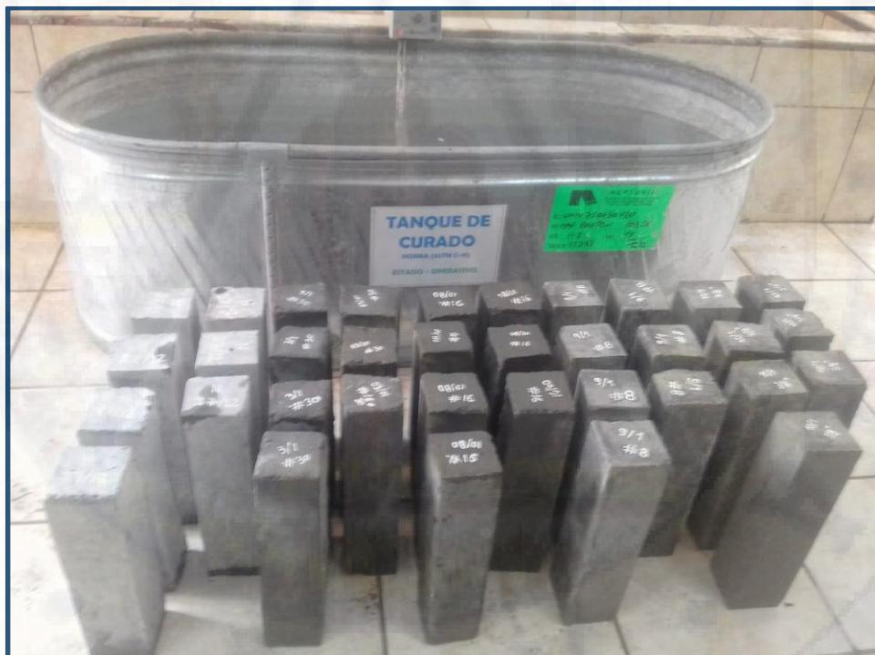
Ilustración 17: Vigas a 7, 14 y 28 días de curado (ASTM C-31)
