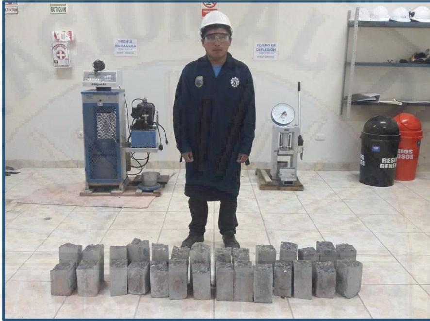
Ilustración 25: Probetas ya ensayadas a flexión (ASTM C-78)
