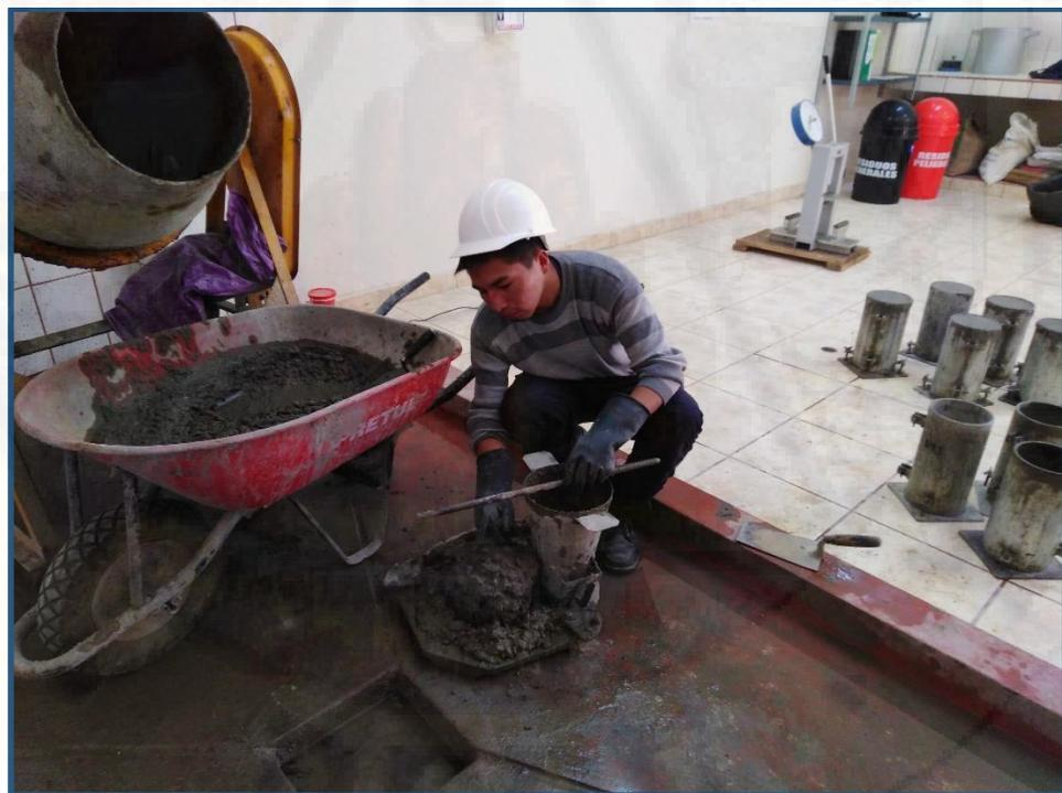
Ilustración 13: Ensayo de asentamiento en el concreto (ASTM C-143)
