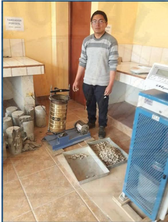
Ilustración 4: Ensayo de análisis granulométrico (ASTM C-136)
