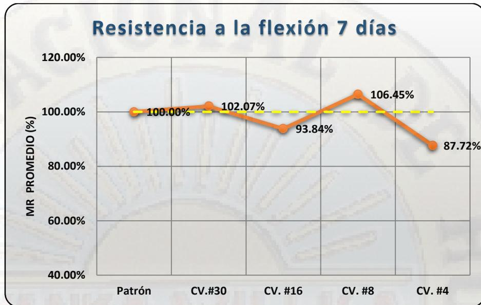
Figura 4.28 Comparación de resistencia a la flexión - 7 días
