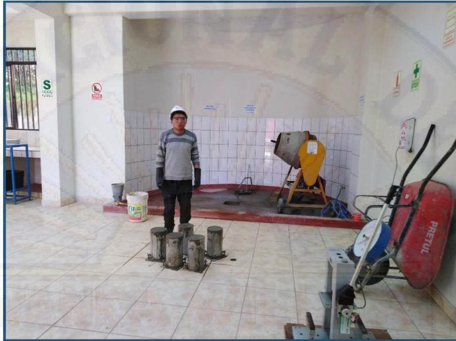
Ilustración 14: Llenado de moldes de 15 cm x 30 cm (ASTM C-31)
