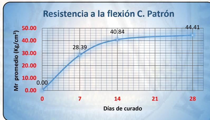
Figura 4.16 Curva resistencia vs Tiempo – Flexión patron
