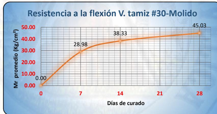
Figura 4.17 Curva resistencia vs Tiempo – Flexión vidrio tamiz #30 (Molido)
