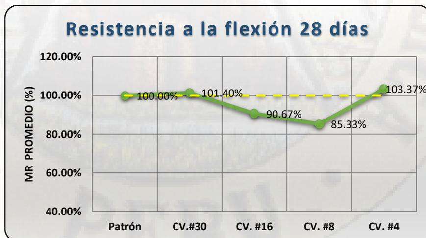
Figura 4.32 Comparación de resistencia a la flexión - 28 días
