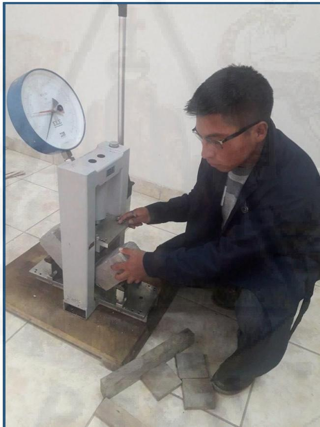
Ilustración 19: Viga ensayada a flexión
