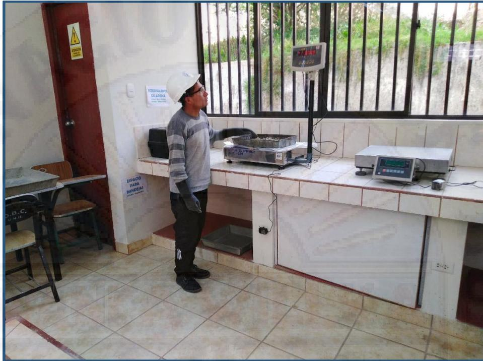
Ilustración 10: Peso de materiales para la mezcla
