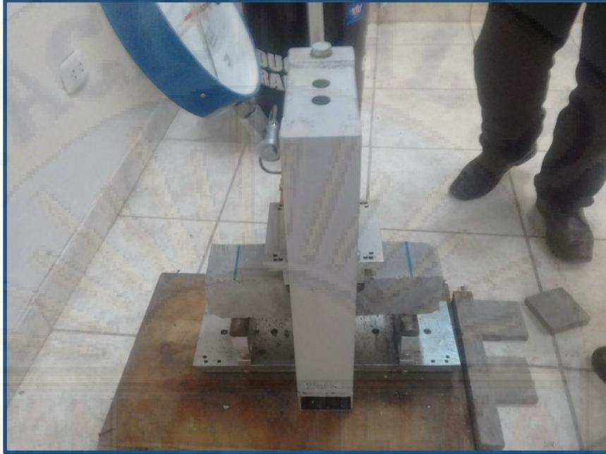
Ilustración 18: Ensayo de resistencia a la flexión (ASTM C-78)
