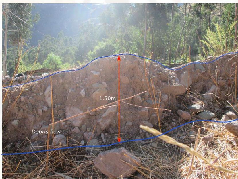
Figura 12. Datos tomados de la observación en campo sobre los parámetros del flujo de detritos.
