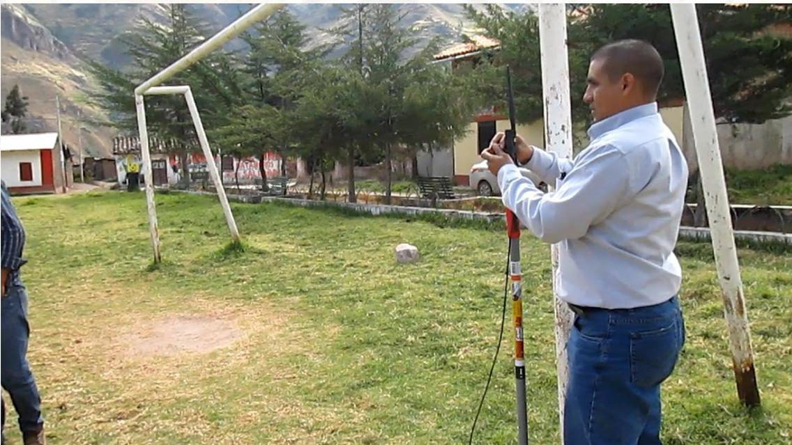
**Fotografía n°6.** Instalación de GNS diferencial para levantamiento de nube de puntos.
