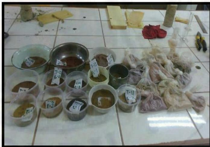
**Figura 28:** Después del tamizado N°40 para realizar el ensayo de límite plástico.
