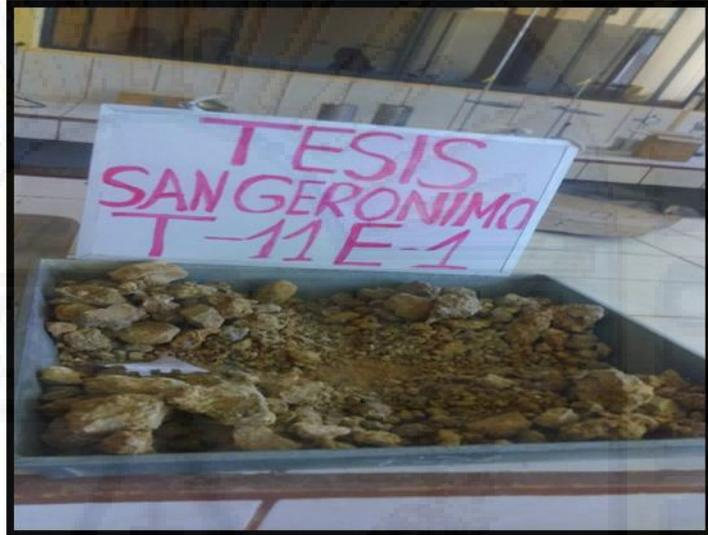
**Figura 22:** Se muestra el cuarteto de una muestra T-11, (Fuente: Elaboración propia).
