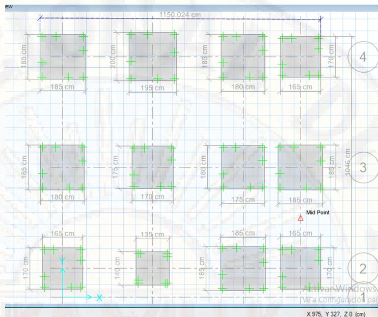
**Figura 63:** Plano en planta de las zapatas con sus Dimensiones – (Fuente: elaboración propia)
