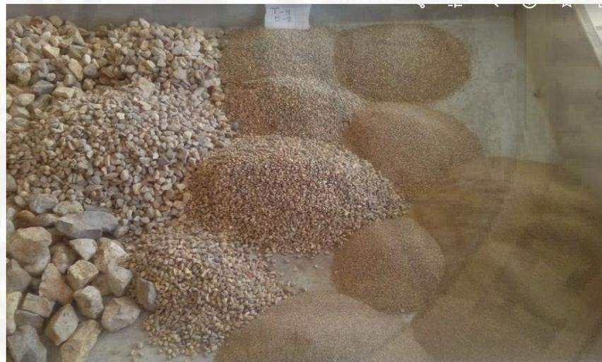
**Figura 2:** Se visualiza una vez realizado el tamizado, hay diferentes partículas de muestra de suelo como puede ser fracción gruesa, fracción intermedia y fracción fina.
