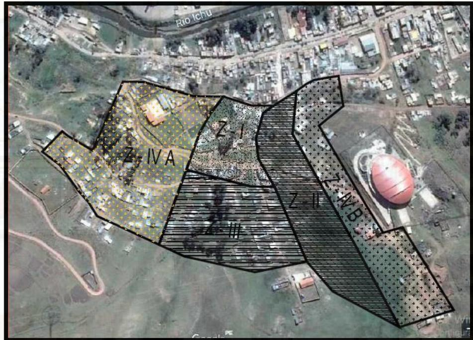
**Figura 58:** La microzonificación geotécnica del sector de San Gerónimo, se visualiza 4 zonas.
