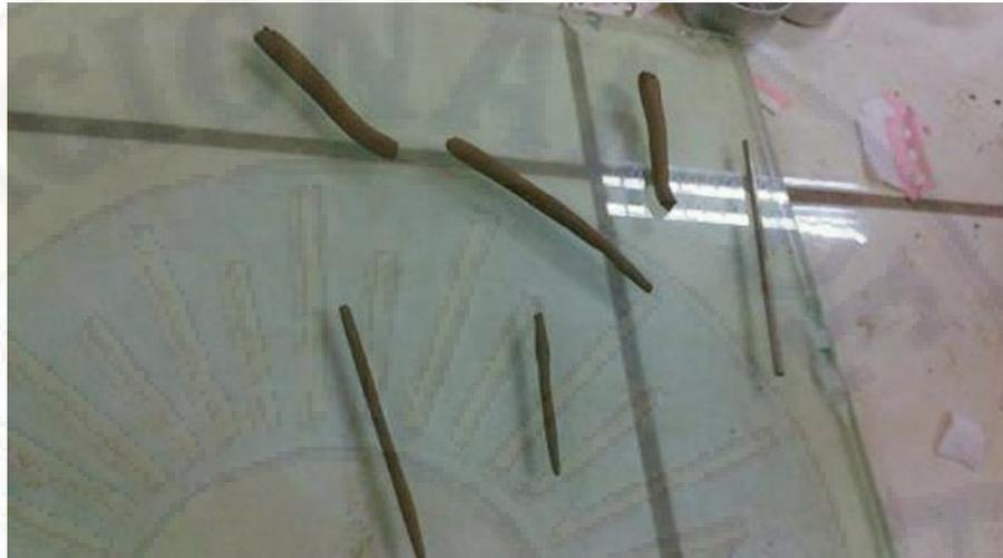
**Figura 6:** se visualiza hilos en pequeños cilindros, prueba de límite plástico
