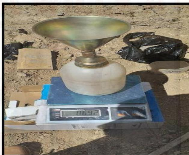
**Figura 32:** Jarra de plástico y cono de metal para el dispositivo del cono de arena
