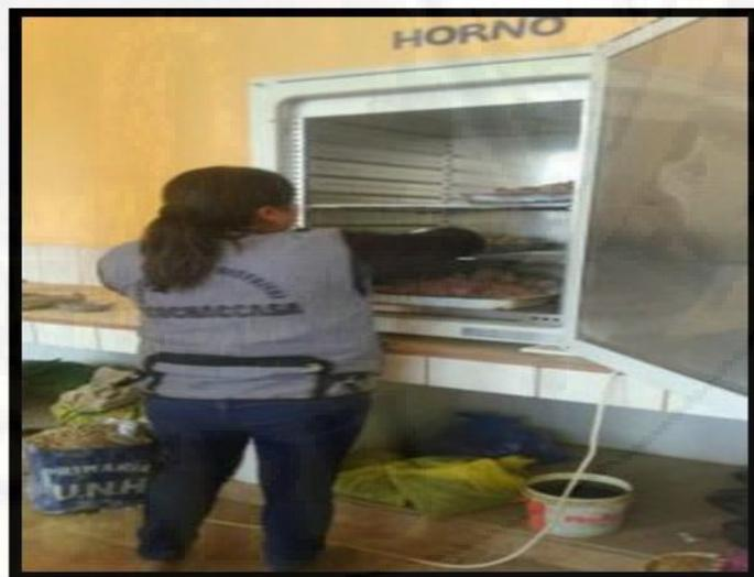
**Figura 23:** la muestra lavada se lleva al horno por 24 horas.
