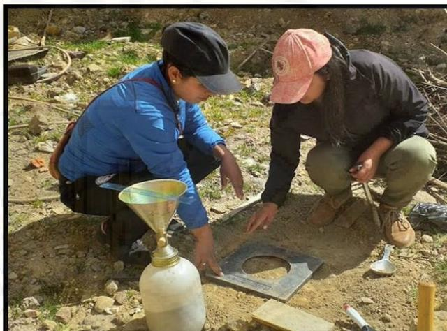
**Figura 31:** Ensayo de campo del cono de arena en el sector de San Gerónimo.
