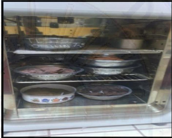
**Figura 30:** La muestra se lleva al horno para su debido secado y así poder registrar los datos.
