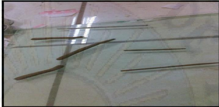
**Figura 29:** El suelo al enrollarse en hilos de 3.2 mm de diámetro se desmorona este es el ensayo de plástico.
