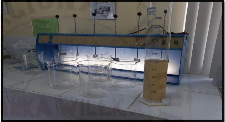
Calculamos la cantidad de dosis de coagulante que se debe añadir a cada vaso, a una concentración de coagulante: de 20ppm, 40ppm, 60ppm, 80ppm, 100ppm y 120ppm, dichas concentraciones tomamos de referencia los antecedentes en este tema.
