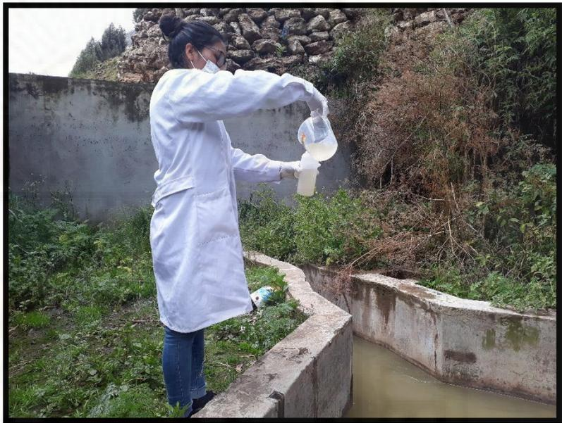
h) Toma de muestra para ensayo de Prueba de jarras
