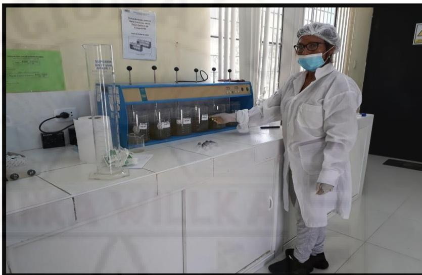
Encender el equipo con el botón de encendido. Establecer el tiempo de 1 minuto para la mezcla rápida a una velocidad de 100 rpm. Cumplido el tiempo, se programó un tiempo de 20 min y a una velocidad de 30rpm para la mezcla lenta.
