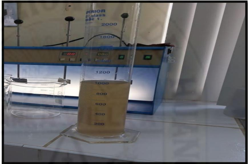
Calculamos la cantidad de dosis de coagulante que se debe añadir a cada vaso, a una concentración de coagulante: de 20ppm, 40ppm, 60ppm, 80ppm, 100ppm y 120ppm.
