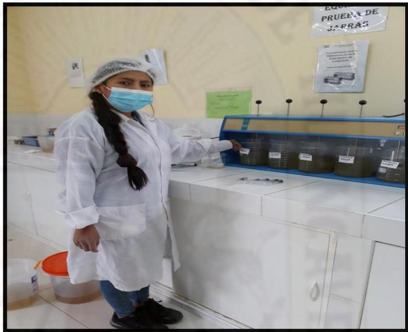
Encendemos el equipo con el botón de encendido. Establecer el tiempo de 1 minuto para la mezcla rápida a una velocidad de 200 rpm.
