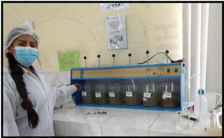
Colocamos un vaso de 1 litro debajo de cada una de las paletas de agitación. llenamos en cada vaso exactamente 1 litro de agua residual medido con una probeta graduada.
