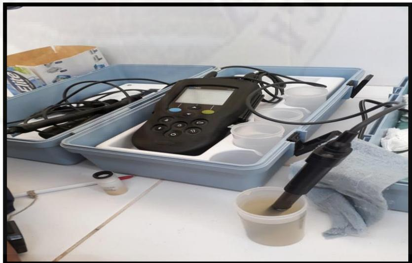
Introducimos el electrodo en la solución de la muestra en el vaso precipitado. Se presiona la opción medición, para dar lectura. Después de lectura se lava el electrodo con suficiente agua destilada para hacer otra medición.
