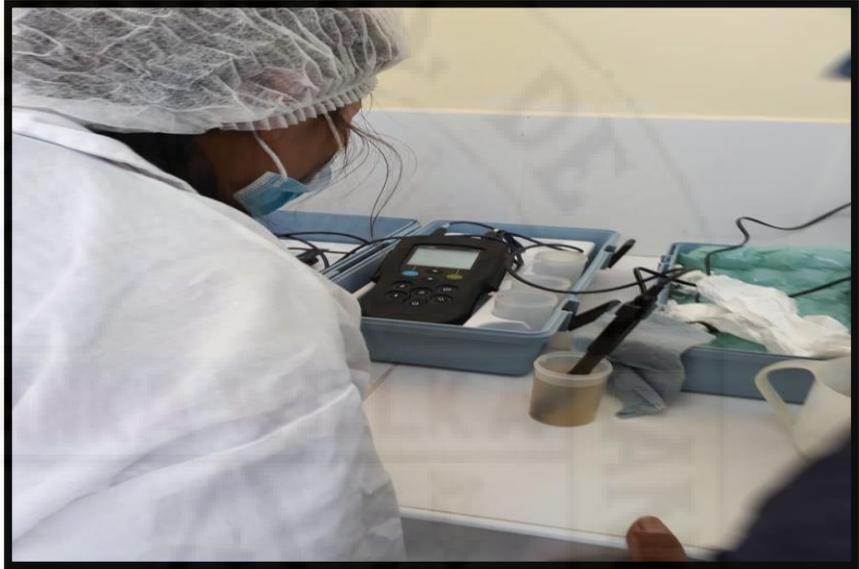
Introducimos el electrodo en la solución de la muestra en el vaso precipitado. Se presiona la opción medición, para dar lectura. Después de lectura se lava el electrodo con suficiente agua destilada para hacer otra medición.
