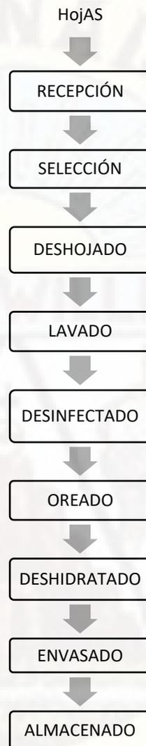
**Figura 1.** Diagrama de flujo de deshidratado de hojas (Jinde, 2014)
