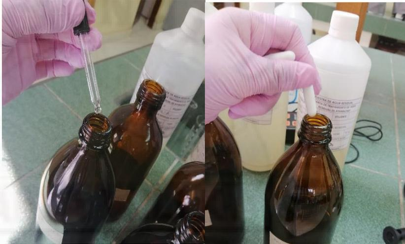
procediendo a colocar los estuches a cada frasco añadiendo gotas de Hidróxido de potasio (KOH) en cada depósito de CO<sub>2</sub> sin salpicar los bordes e interior de estos dispositivos, posterior se enroscan los sensores para DBO o cabezales en cada frasco.
