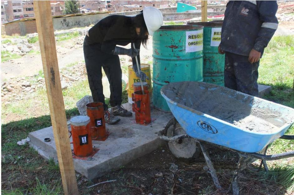
**Fotografía A 14.** Realización de probetas para el ensayo a compresión
