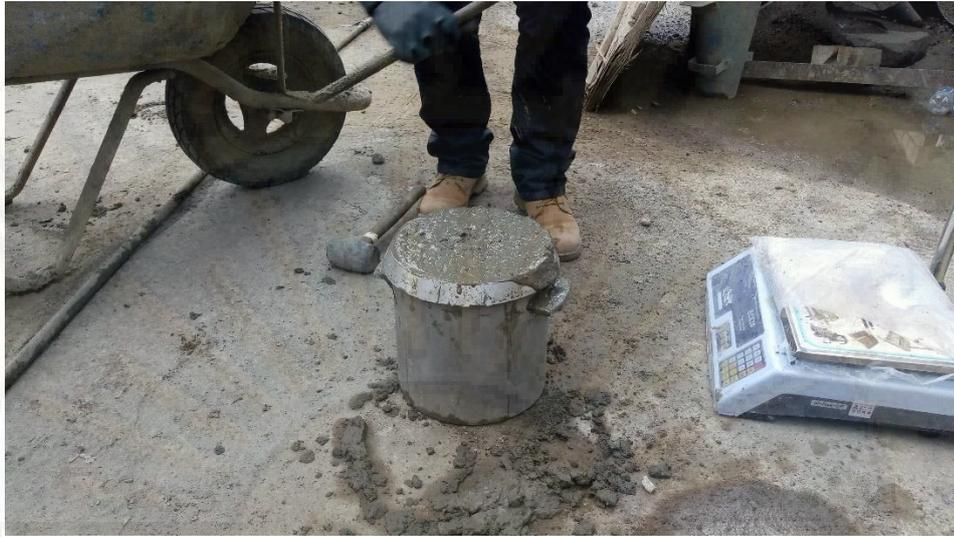
**Fotografía A 9.** Vaciado de concreto en capas a la olla de Washington para los ensayos de peso unitario y contenido de aire
