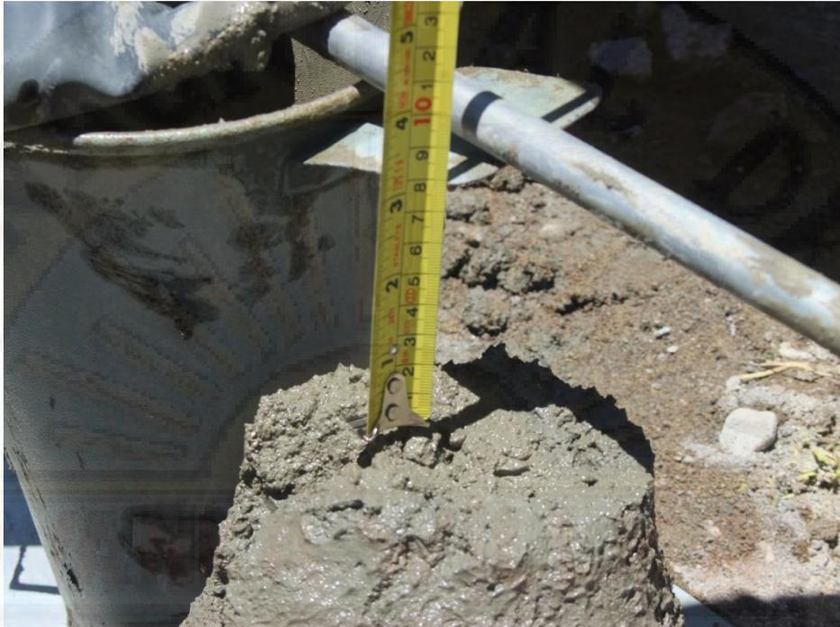
**Fotografía A 7.** Ensayo de Slump
