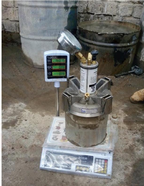
*Fotografía A 12. Ensayo de peso unitario*
