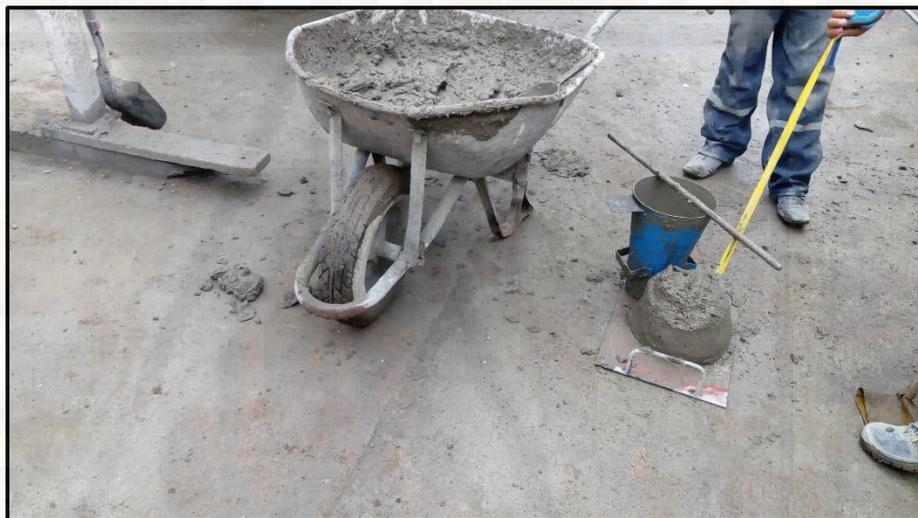
Fotografía 6. Ensayo de Slump
