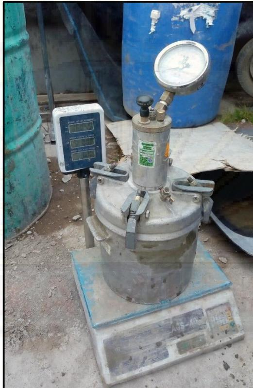
**Fotografía 4.** Ensayo de peso unitario
