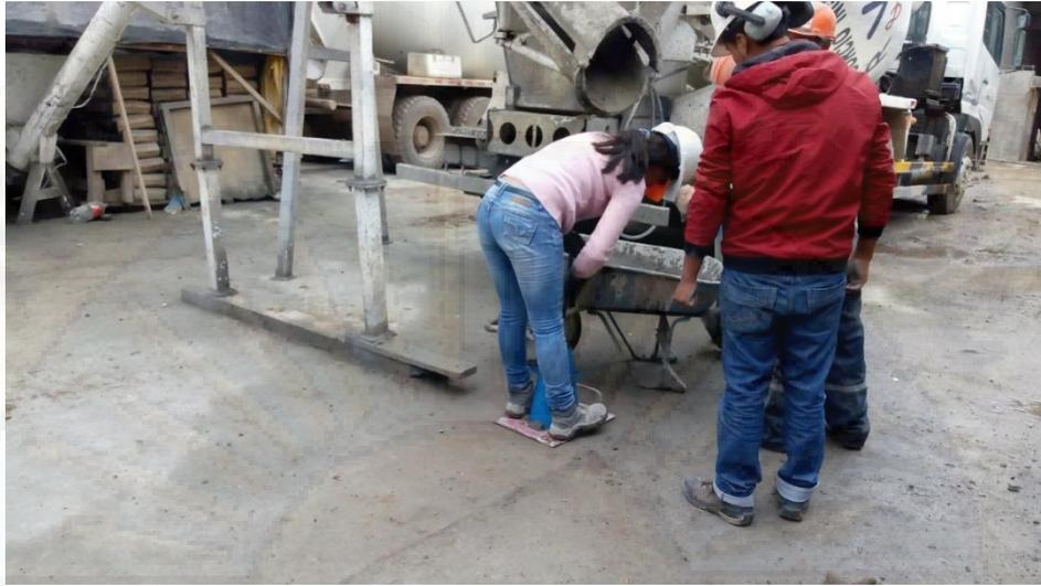
**Fotografía A 5. Ensayo de Slump**
