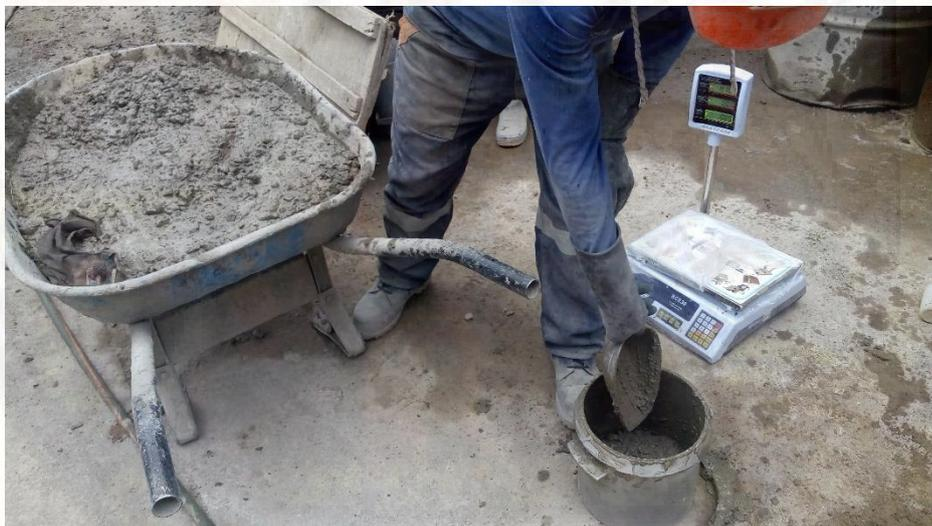
**Fotografía A 8.** Vaciado de concreto en capas a la olla de Washington para los ensayos de peso unitario y contenido de aire
