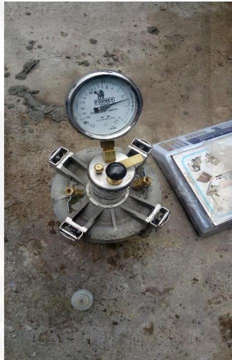
**Fotografía A 10 y A 11.** Ensayo de contenido de aire
