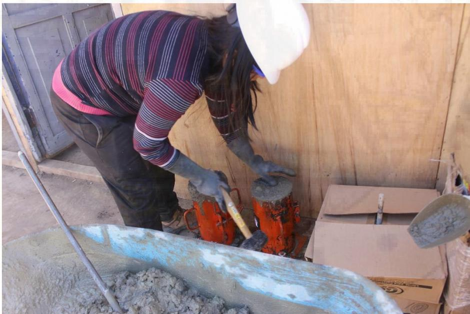
*Fotografía A 13. Realización de probetas para el ensayo a compresión*
