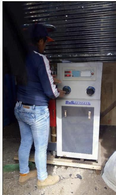
**Fotografía A 15 y 16.** Rotura de probetas mediante una prensa hidráulica
