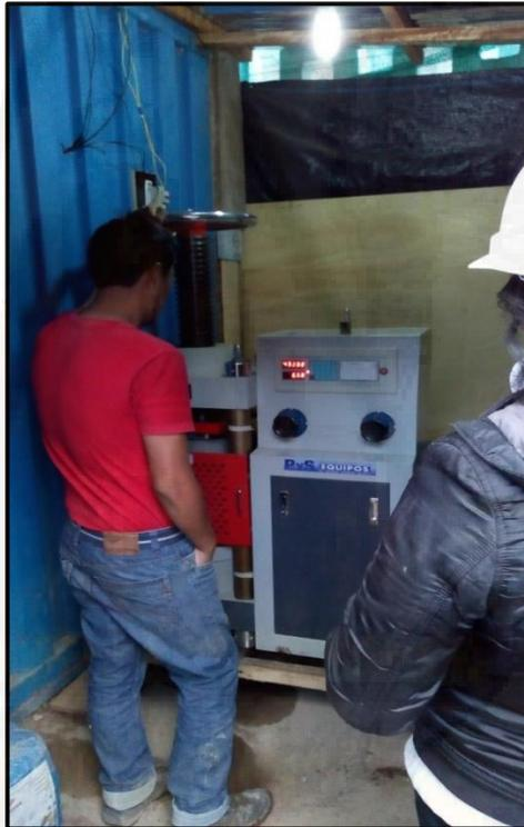
**Fotografía 7.** Ensayo de resistencia a la compresión
