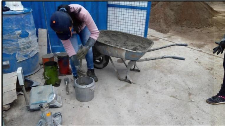
*Fotografía 1. Ensayo de contenido de aire*
