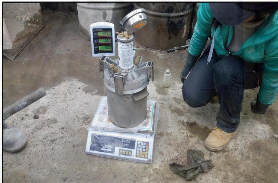
Fotografía 3. Ensayo de peso unitario
