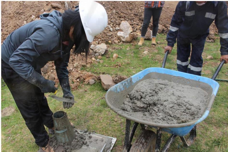
**Fotografía A 6. Ensayo de Slump**
