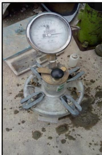
*Fotografía 2. Ensayo de contenido de aire*
