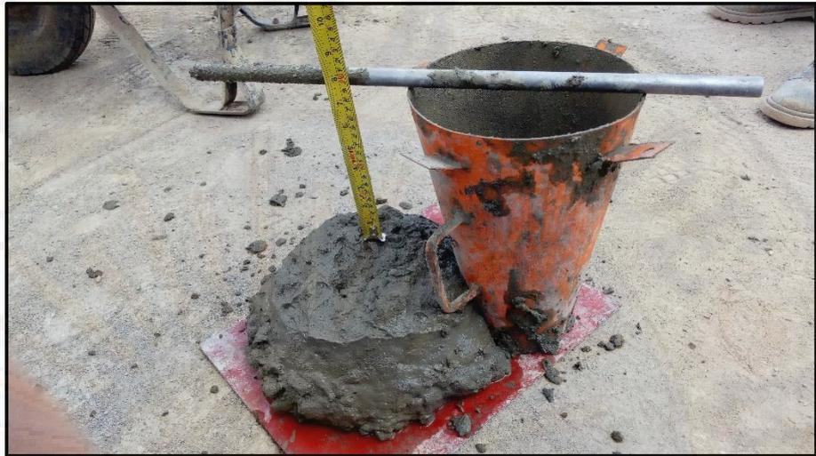
Fotografía 5. Ensayo de Slump
