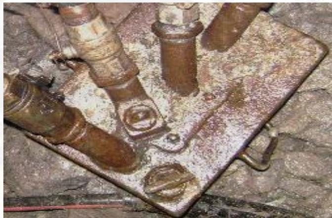
Figura 18 Conexiones de aire comprimido y agua.
