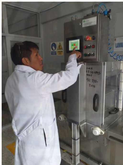
Programación de la lavadora Kiwi Scour Auto Mk2 para el lavado de muestras de fibra de alpaca.
