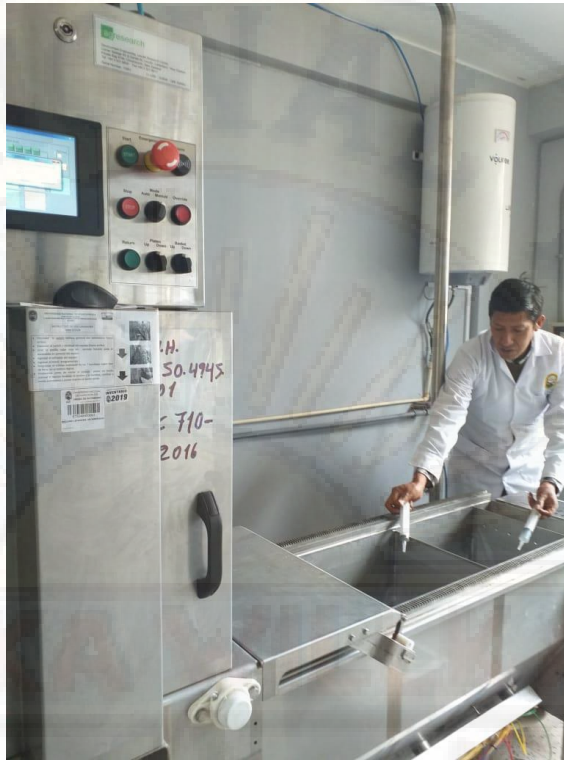
Dosificación con detergente heptasol y sequion para el inicio de lavado de muestras de fibra de alpaca
