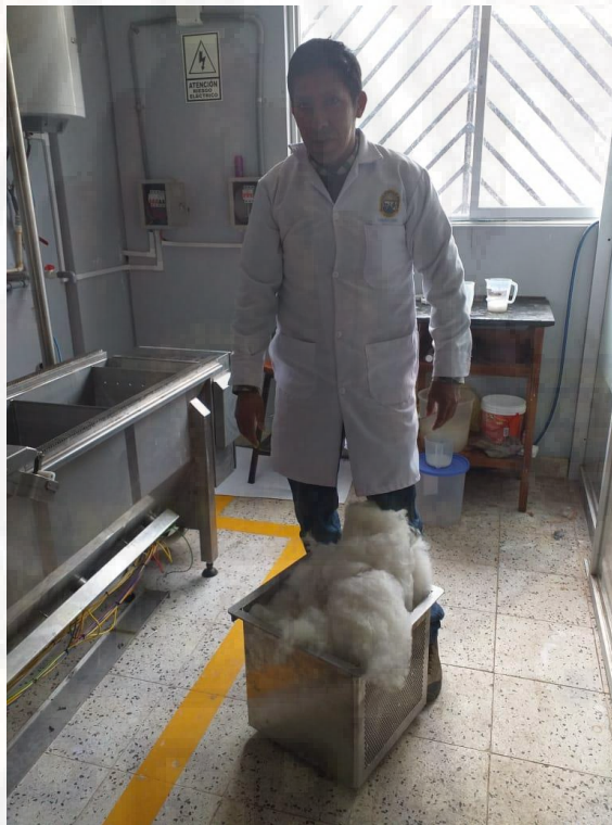
Muestra de fibra de alpaca pesado y colocado a la bandeja para inicio del lavado.
