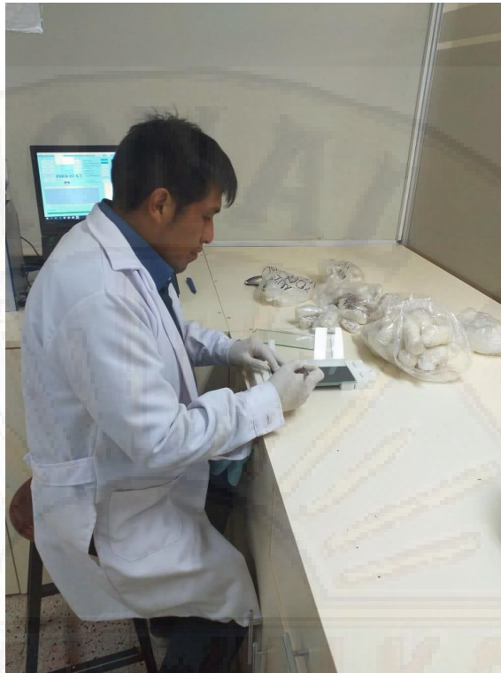
Preparación de muestras de fibra de alpaca para ser analizado por el Fiber EC.
