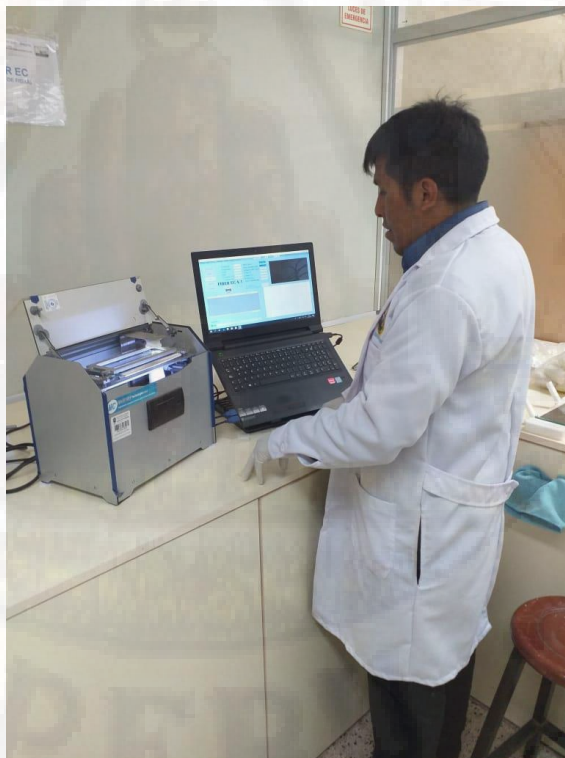
Utilizando el Fiber EC y escaneando muestras de fibra de alpaca en dos direcciones para conocer el diámetro.
