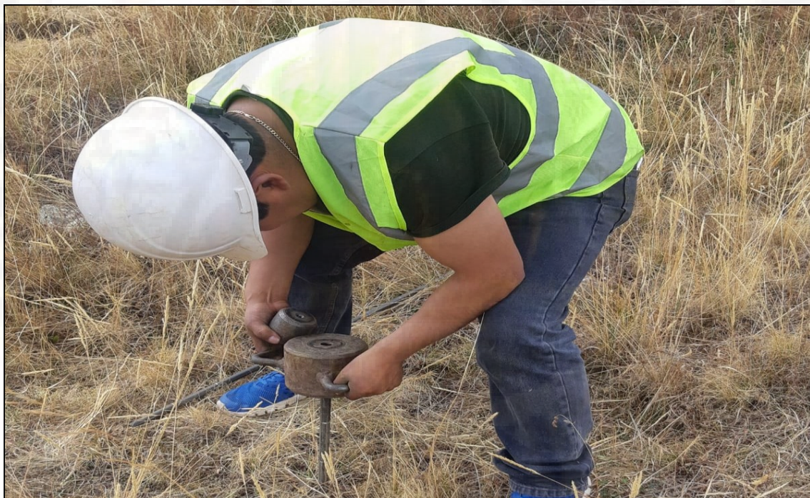
Extracción de varillas después de los ensayos DPL en Suelo Cohesivo de la U.N.H.
