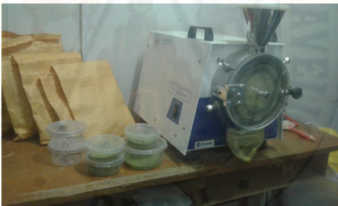
Imagen 8. Molienda de las muestras secas para su análisis químico.
