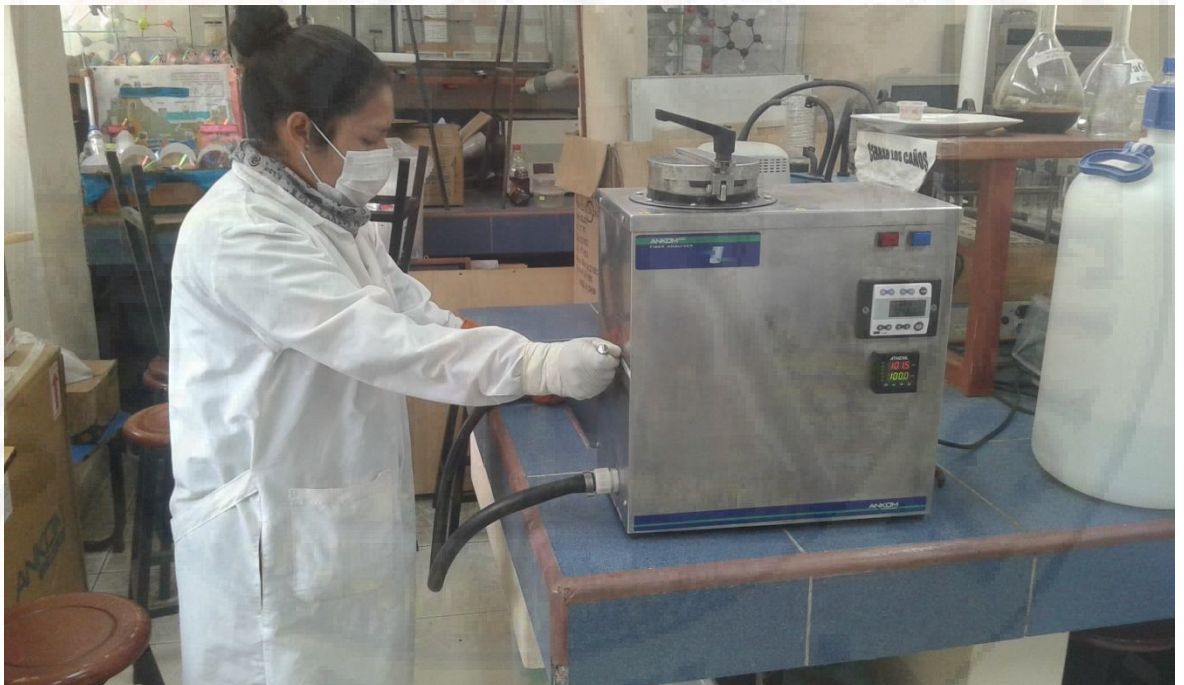
Imagen 10. Análisis de FDN en el equipo Ankom A 200.
