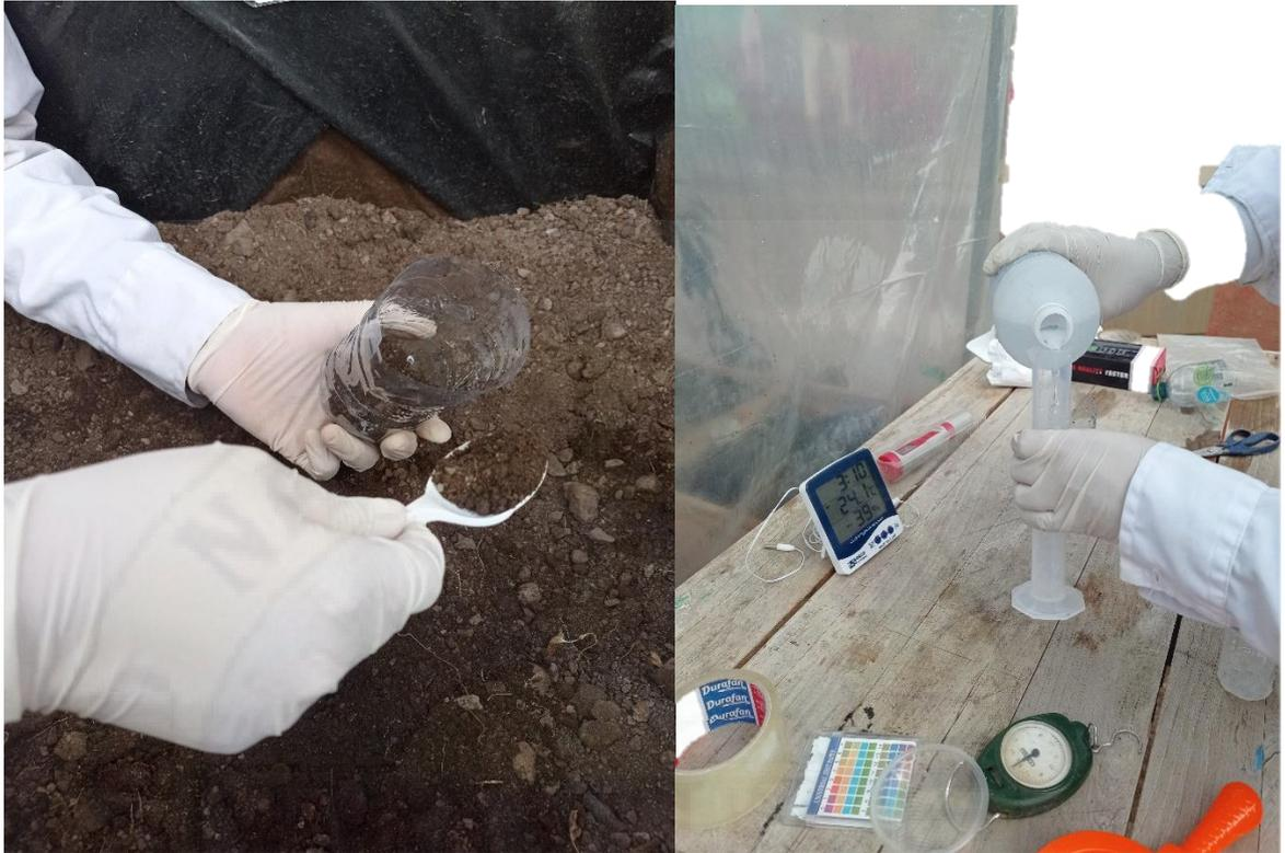
**Fotografía N° 21:** Monitoreo de los parámetros fisicoquímicos (pH y conductividad eléctrica) de suelo de las matrices A, B y C en una relación de 1:1 de agua destilada y muestra de suelo.
