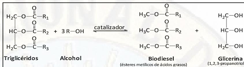
**Figura 1.** Reacción global de transesterificación de un triglicérido genérico con un metanol (Marchetti, Miguel, & Errazu, 2007).
