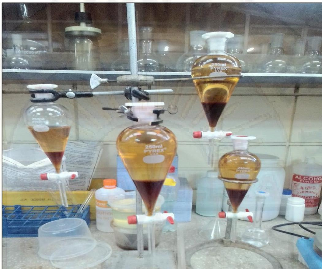
**Fotografía 05.** Decantación de biodiesel una fase biodiesel y la parte inferior glicerina
