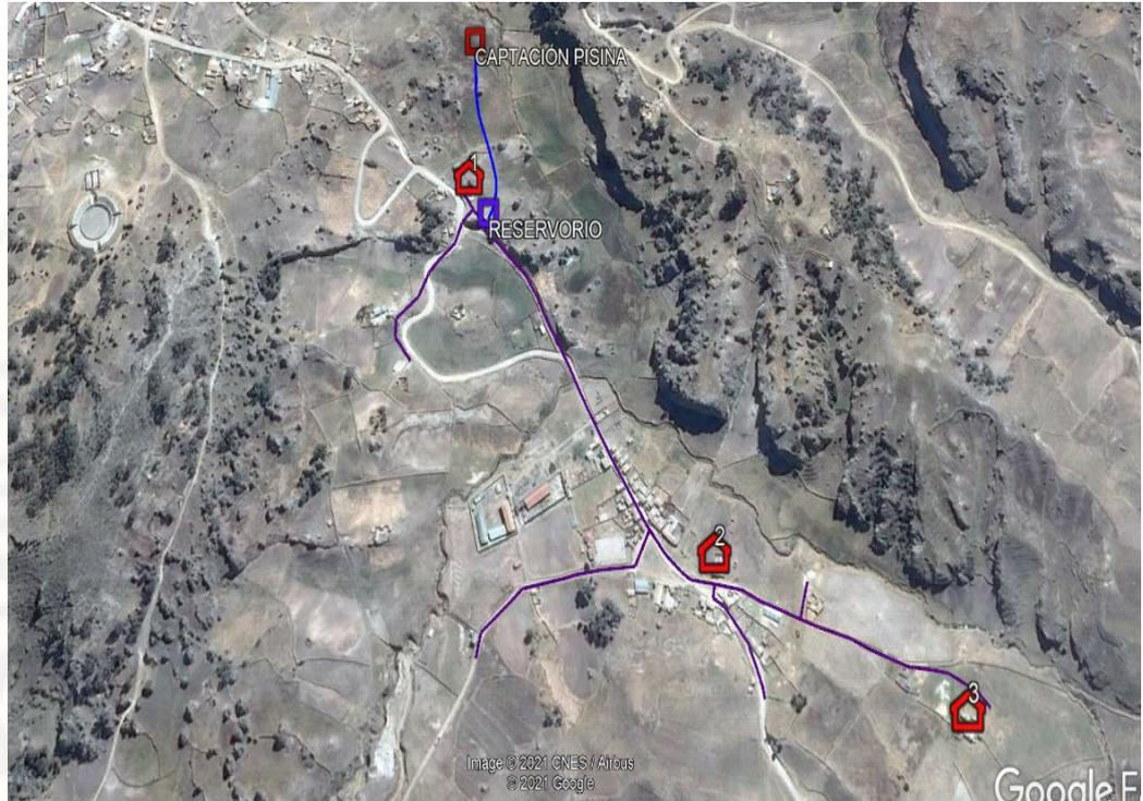
El sistema de agua potable del centro poblado de Chacapampa está compuesto por: captación línea de conducción, reservorio, sistema de cloración, línea de aducción y red de distribución
