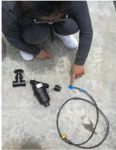
Paso 2: En el accesorio múltiple del tanque de polietileno, colocar el kit dosificador.
