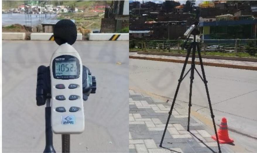
Por otro lado, para la calibración en campo el equipo cuenta con un calibrador externo Extech 407744 y un destornillador pequeño con el que una vez encendido el equipo y configurada a una escala de 80 a 110 dB, ponderación A y respuesta lenta (slow), se coloca el micrófono en el calibrador y fijando la salida del calibrador a 1 kHz @ 94 dB, ajustamos el potenciómetro para una lectura lo más cercana posible a la del calibrador de 94 dB.
