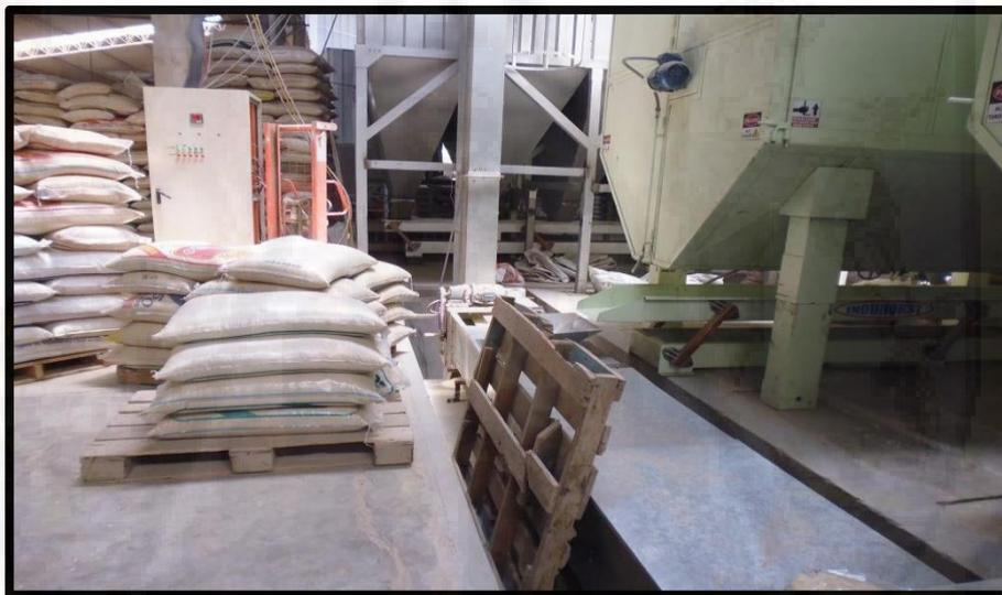
**Figura 13. Zona insegura de trillado mecanizado con espacios abiertos en el piso.**
