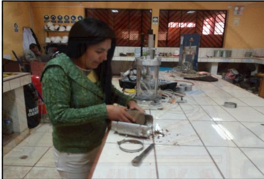
Fotografía 36. Obtención de la muestra cilíndrica.
