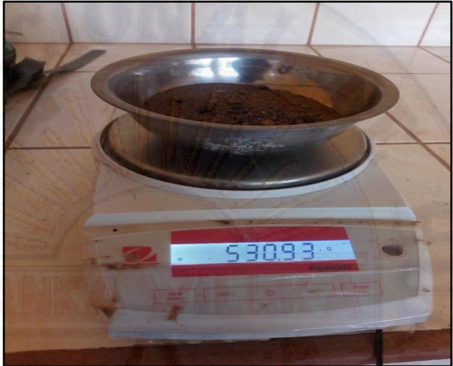
Fotografía 18. Determinación del peso de la muestra retenidas en cada malla
