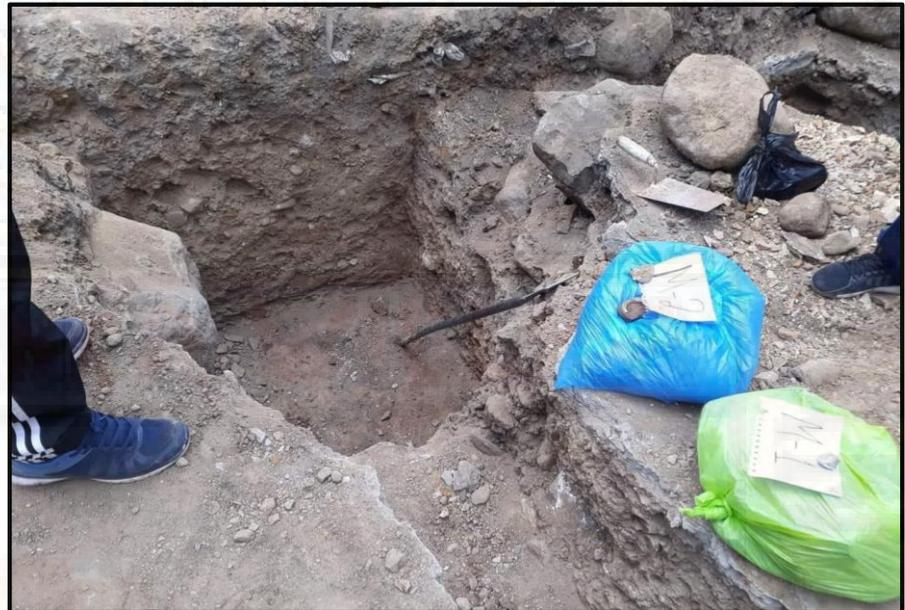
Fotografía 9. Obtención de muestras alteradas de las calicatas C-1 Y C-2
