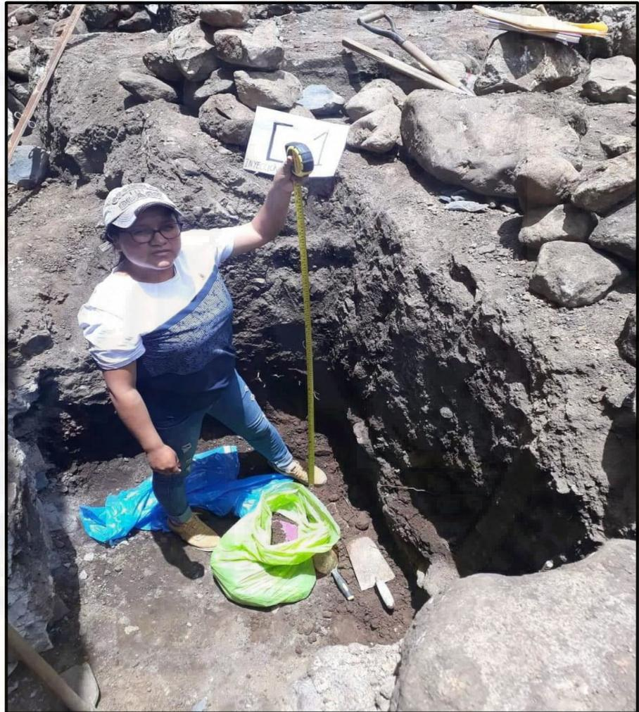
Fotografía 6. Excavación de calicata C- 1 con una profundidad de 2.00 metros
