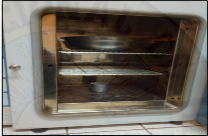
Fotografía 16. Secado de la muestra lavada para el ensayo de granulometría
