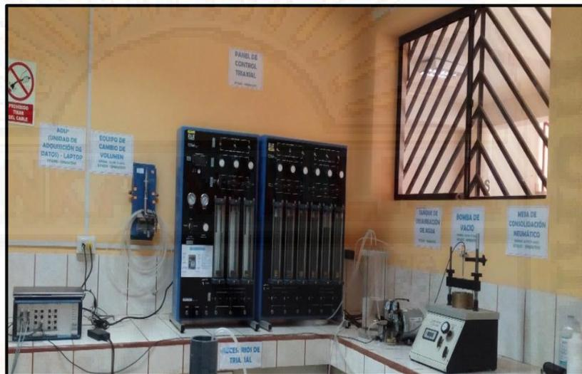
Fotografía 32. Panel de control del triaxial
