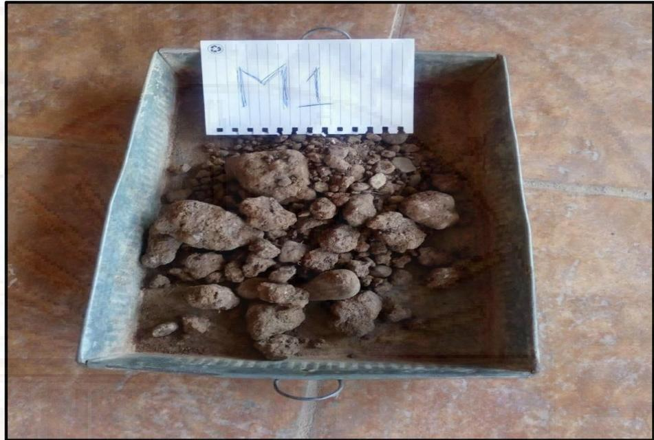
Fotografía 14. Muestra para el lavado y ensayo de granulometría.
