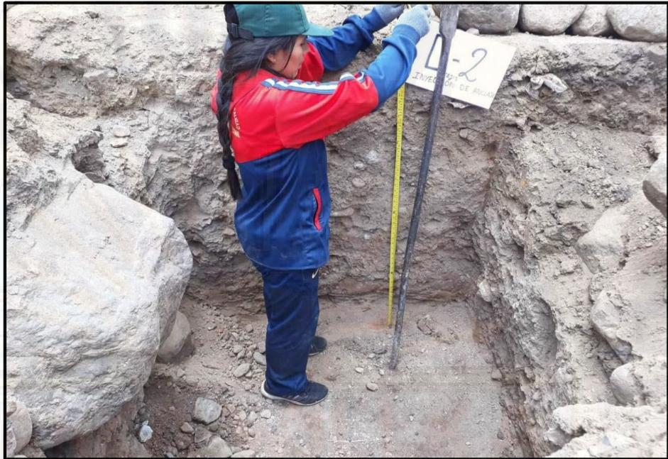
Fotografía 7. Excavación de calicata C- 2 con una profundidad de 2.00 metros
