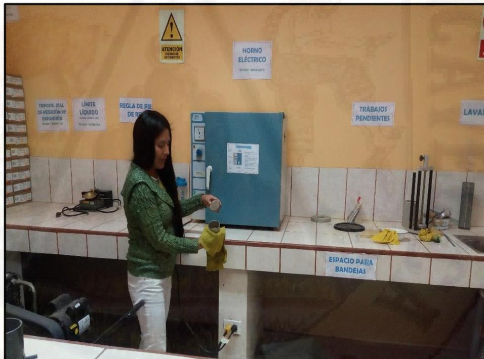
Fotografía 27. Muestra seca extraído del horno.
