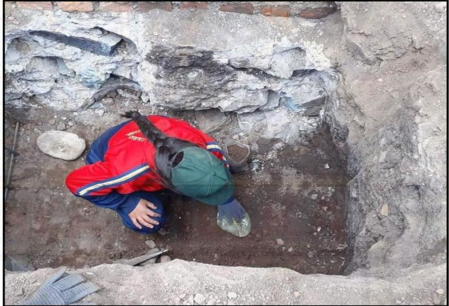
Fotografía 11. Obtención de muestras para determinar la densidad
