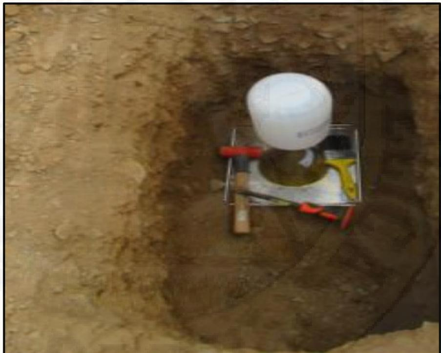
Fotografía 12. Determinación del volumen con material de arena
