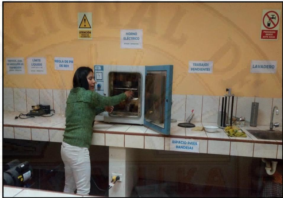
Fotografía 26. Secado de la muestra húmeda en el horno.
