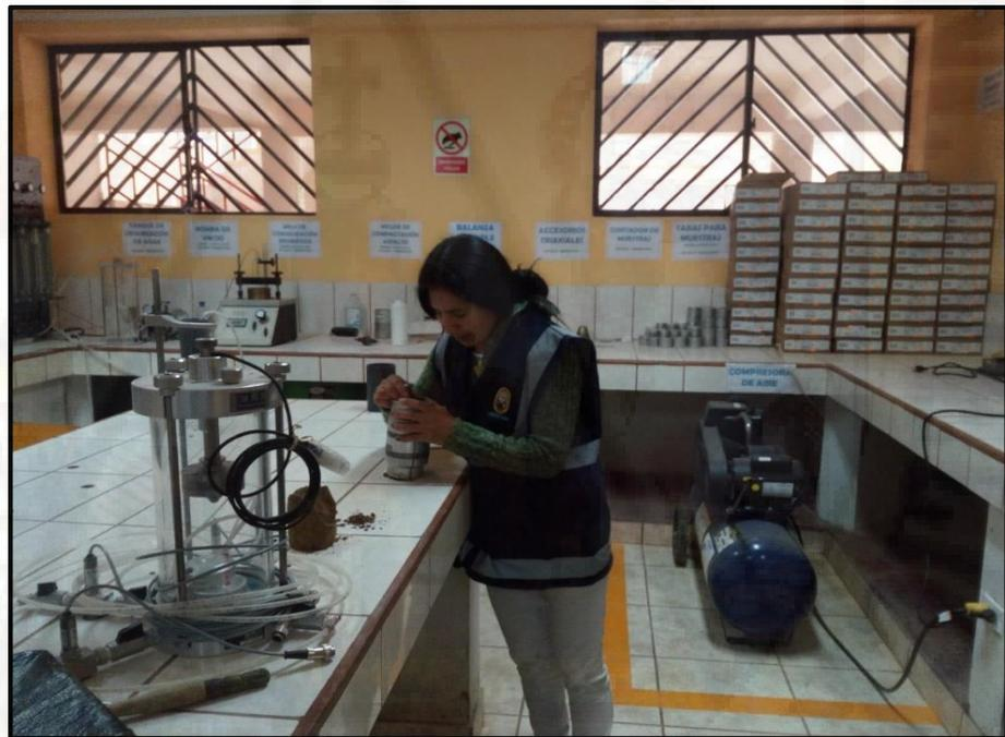
Fotografía 35. compactación del suelo en probeta.
