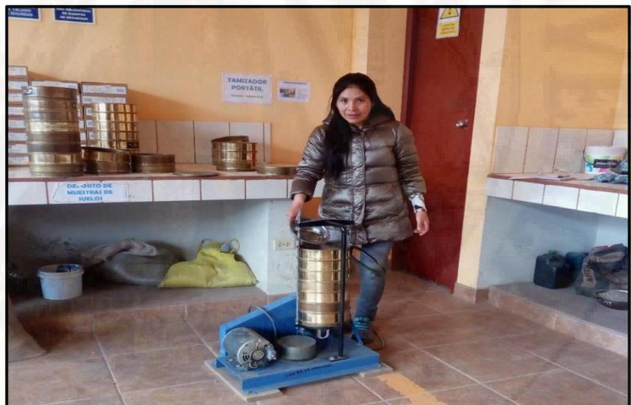
Fotografía 17. Ensayo de granulometría mediante el análisis por cribado o sondeo
