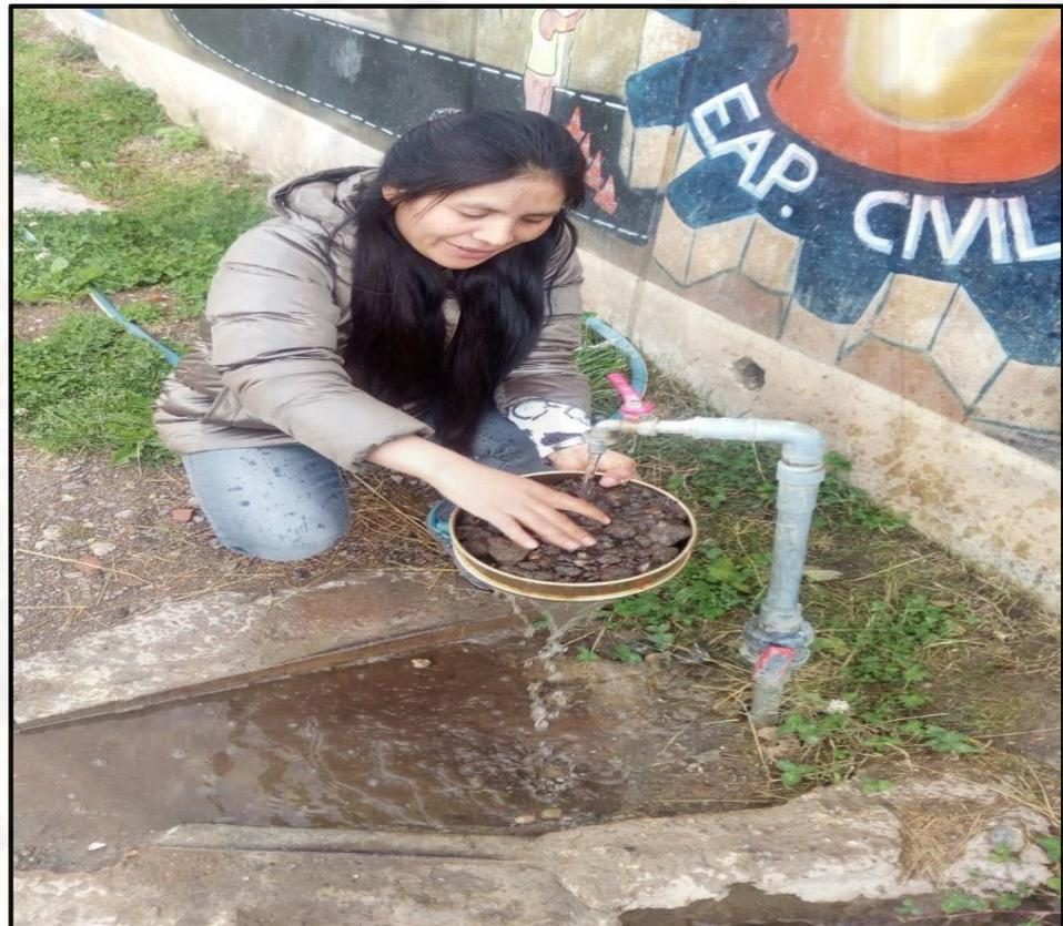
Fotografía 15. lavado de la muestra par el ensayo de granulometria.
