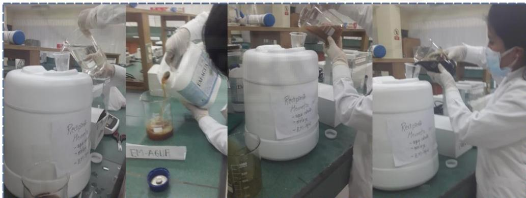
**Apéndice 7:** *Proceso de EM activado (Proceso de fermentación en la incubadora a 30°C)*
