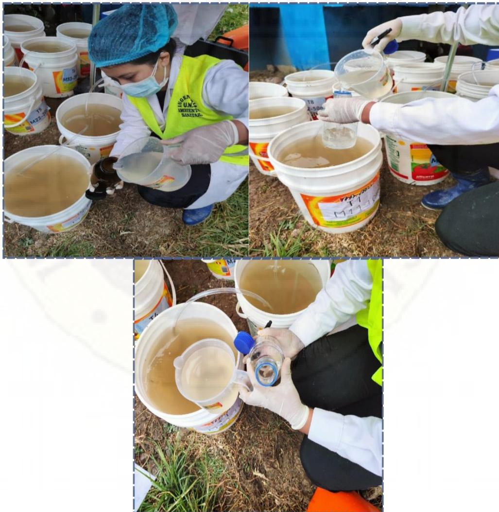
**Apéndice 23:** Preservación con ácido sulfúrico ( $H_2SO_4$ ) hasta un  $pH < 2$  para el parámetro de DQO
