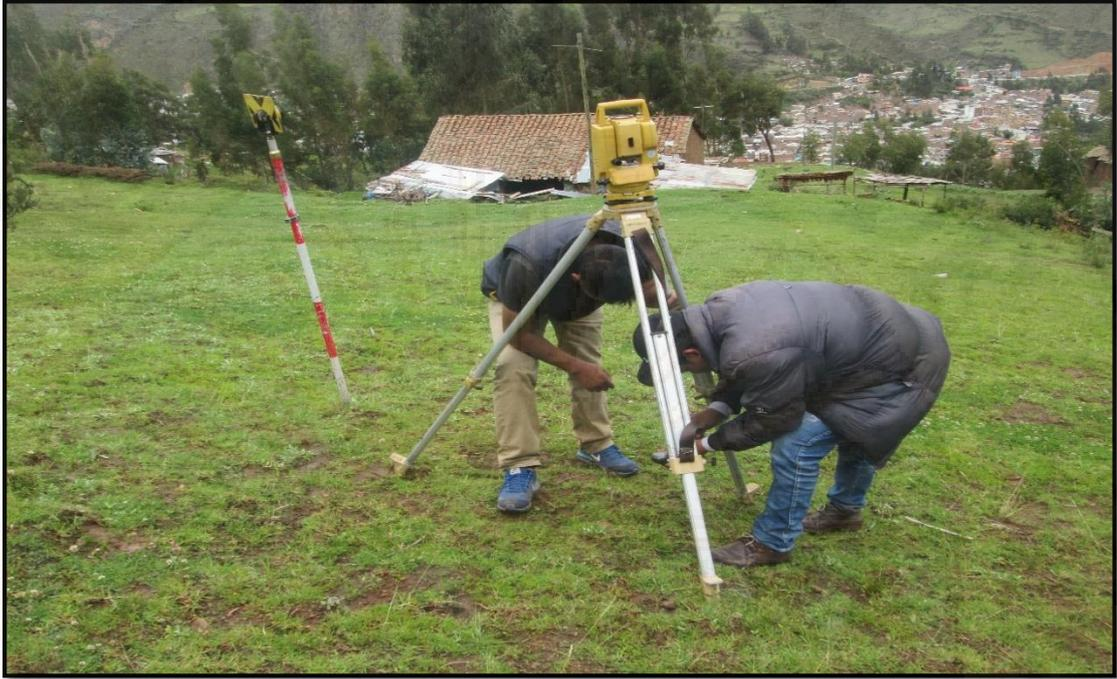
Fotografía N° 16: Estacionamiento para el Levantamiento Topográfico de las líneas de conducción del sistema de Abastecimiento de Agua Potable.
